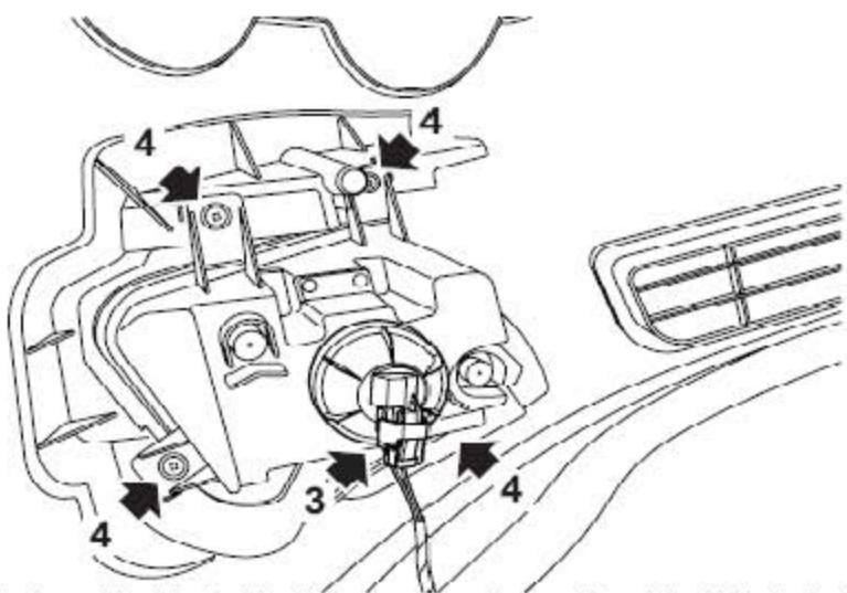
9). 断开前雾灯上的连接器，拆下将前雾灯固定到前保险杠上的4个螺钉，并拆下雾灯。
