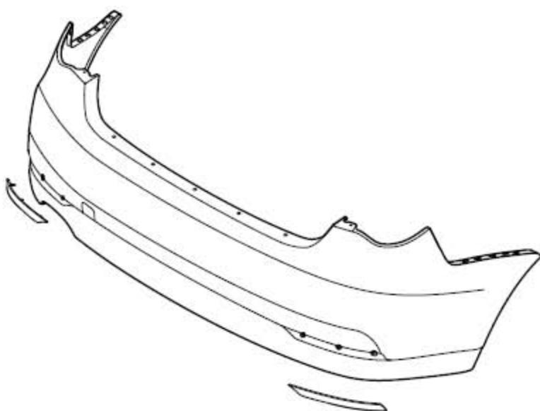
7). 拆下后保险杠两侧的反光装饰板。
