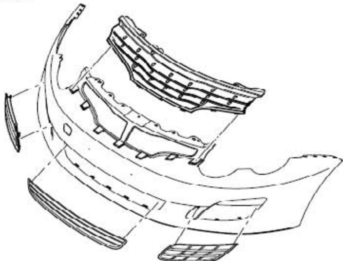
10). 松开7个定位卡扣，取下上进气隔栅。
