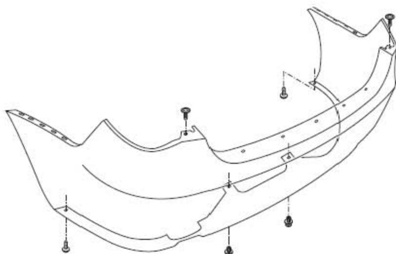
5). 拆下将后保险杠固定到车身上的6个紧固件。
