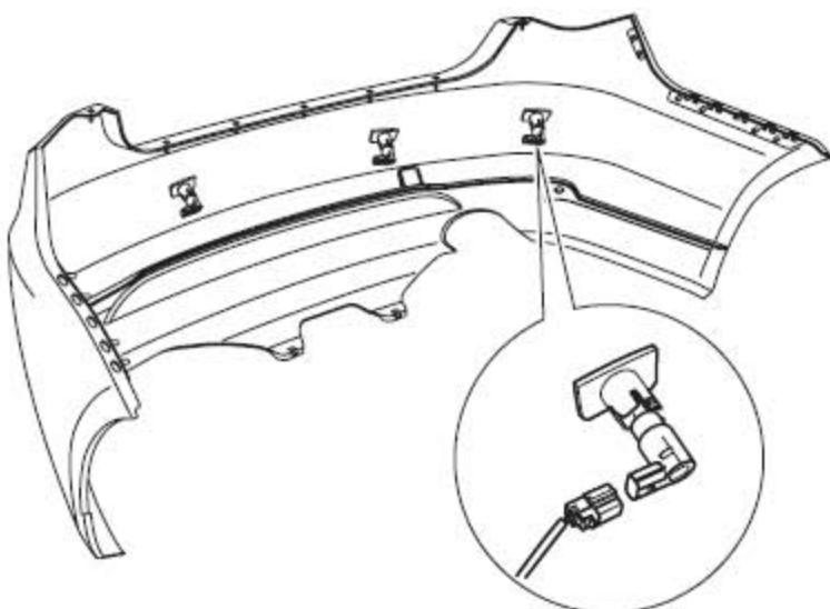
7). 断开停车距离控制传感器的4个连接器。
