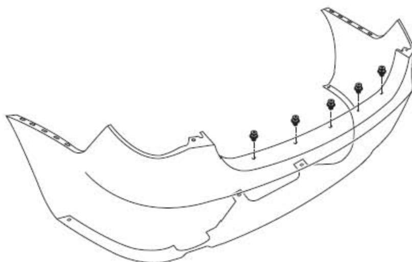
3). 拆下将后保险杠上缘与车身固定在一起的5个快速释放螺钉。
