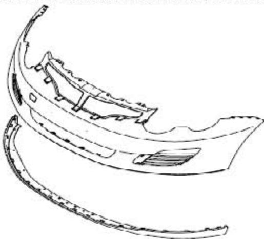
13). 破坏掉将前保险杠下饰板固定到前保险杠上的19个卡扣，并将其拆下废弃。
