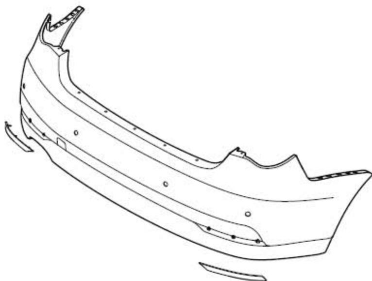
9). 拆下后保险杠两侧的反光装饰板。
