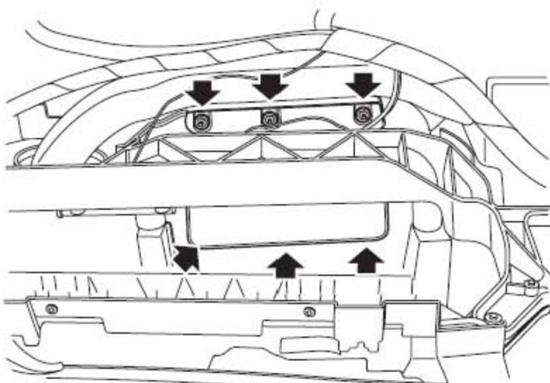
5). 取下将乘客侧前气囊模块固定到仪表板上的6个螺母，并取下气囊模块。
