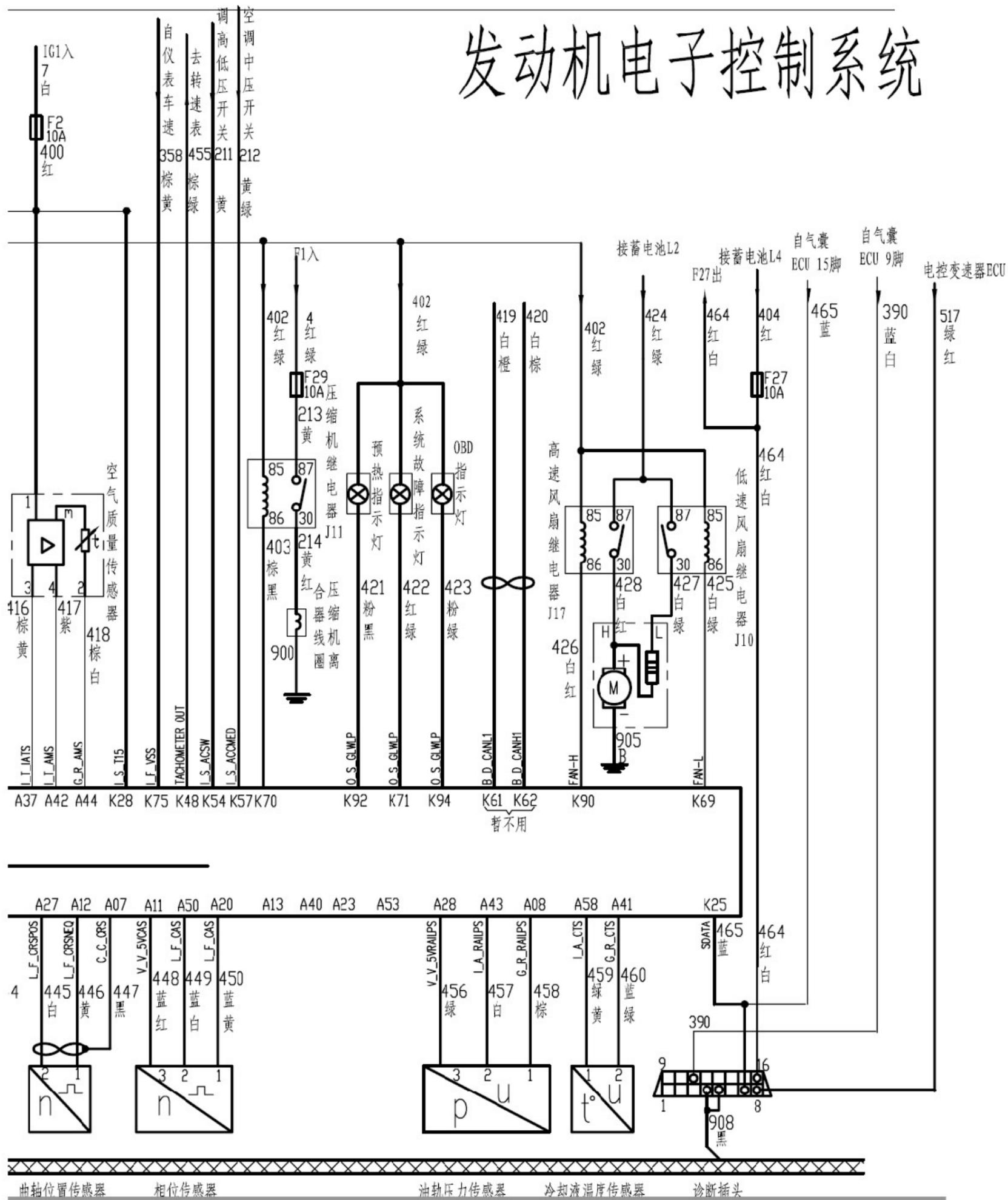
发动机电子控制系统连接器
