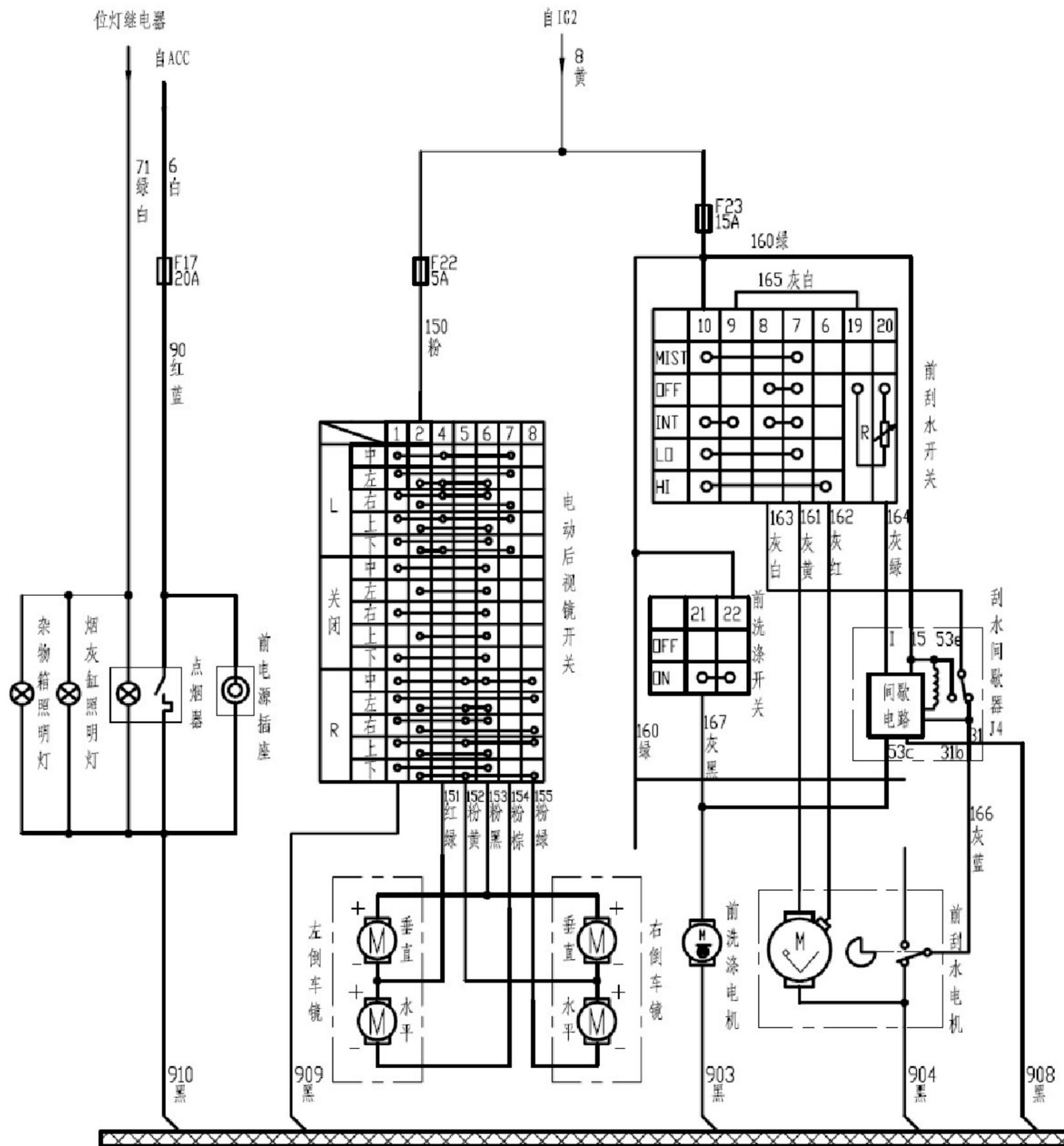
点烟器、电源插座、雨刮器、电动后视镜系统连接器
