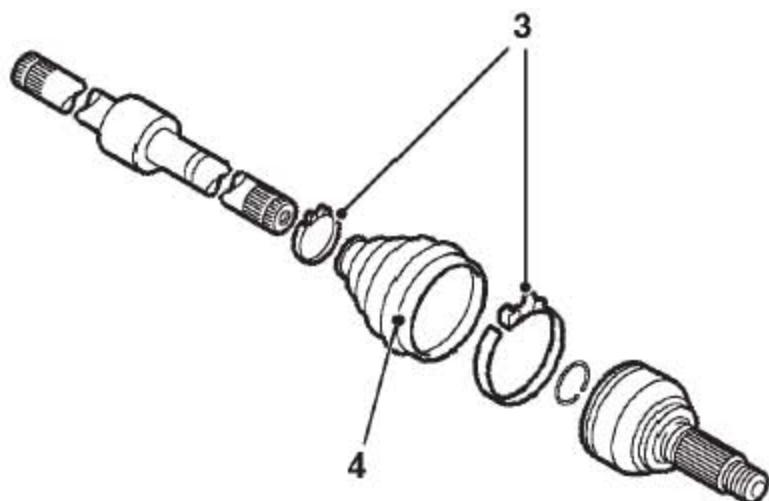
3). 松开两个总成护套夹箍并废弃。
