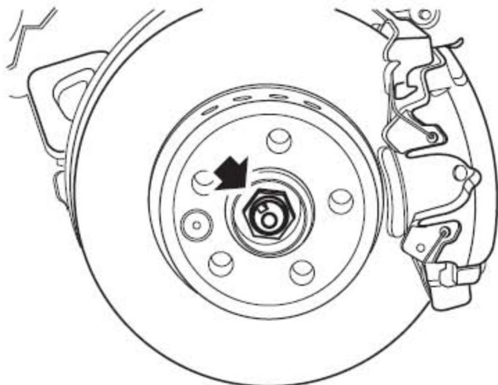
3). 撬起前驱动轴螺母的锁紧装置，踩下制动踏板，取下并废弃驱动轴螺母。
