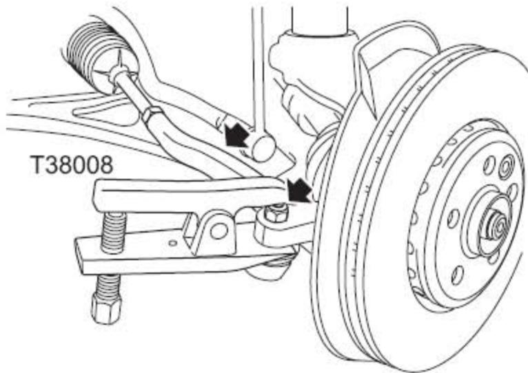
5). 使用工具T38008松开转向横向拉球节。
