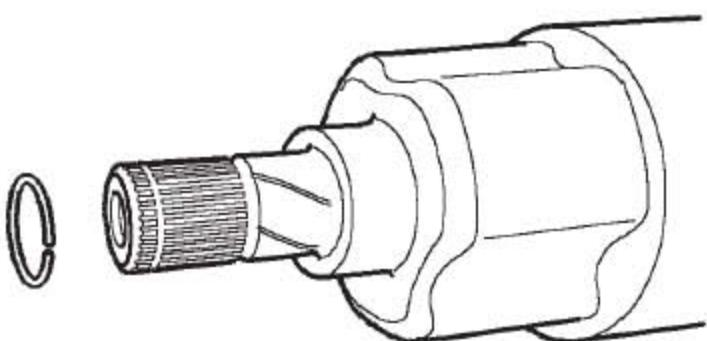
16). 取下废弃驱动轴弹簧挡圈。
