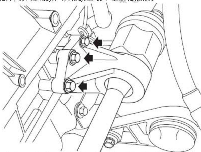
13). 取下3个将驱动轴支架固定在缸体上的螺栓。
