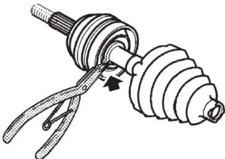
5). 用尖嘴钳夹住等速万向节钢丝挡圈，从驱动轴上取下等速万向节总成。
