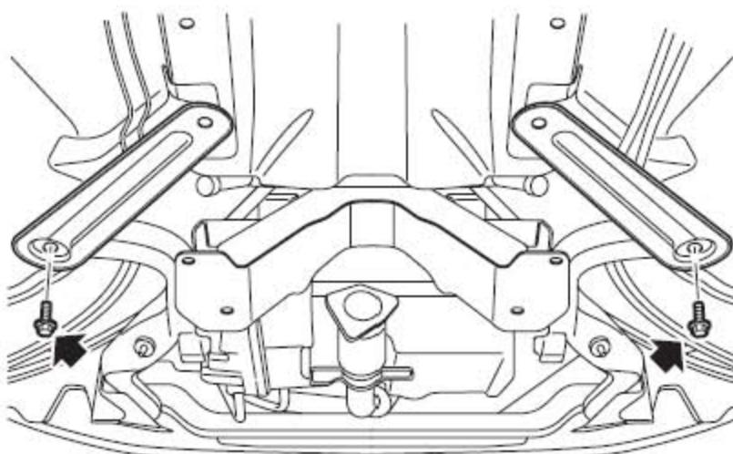
3). 拿开将副车架支撑固杆定到副车架上的螺栓，取下副车架支撑杆。
