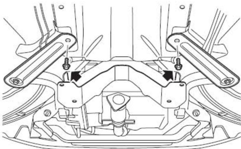
12). 旋松将副车架支撑杆固定到车身地板上的两个螺栓。
