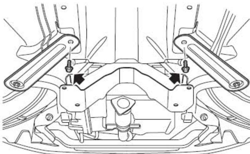
2). 取下将副车架支撑杆固定到车身上的螺栓。
