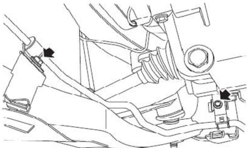
16). 取下将PAS管支架固定到副车架上的两个螺栓。
