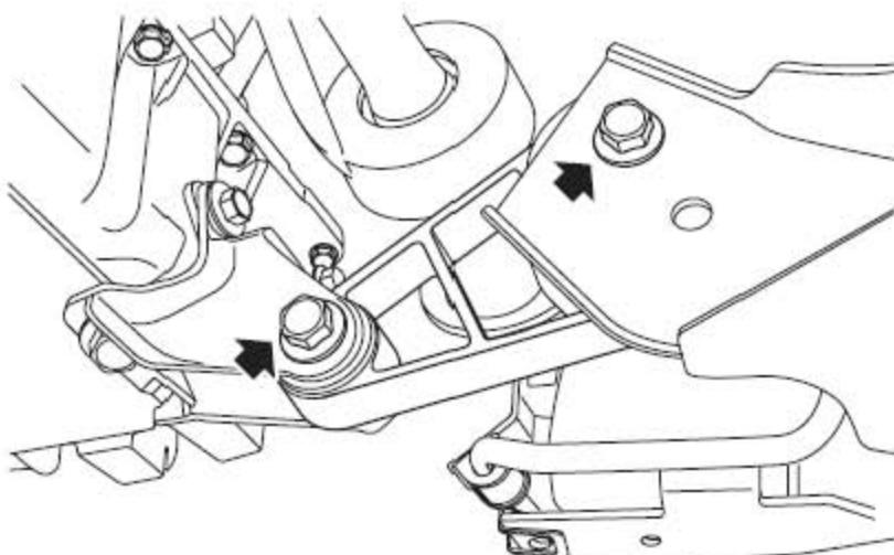
15). 拆下固定发动机下后系杆的2个螺栓，取下发动机下后系杆。
