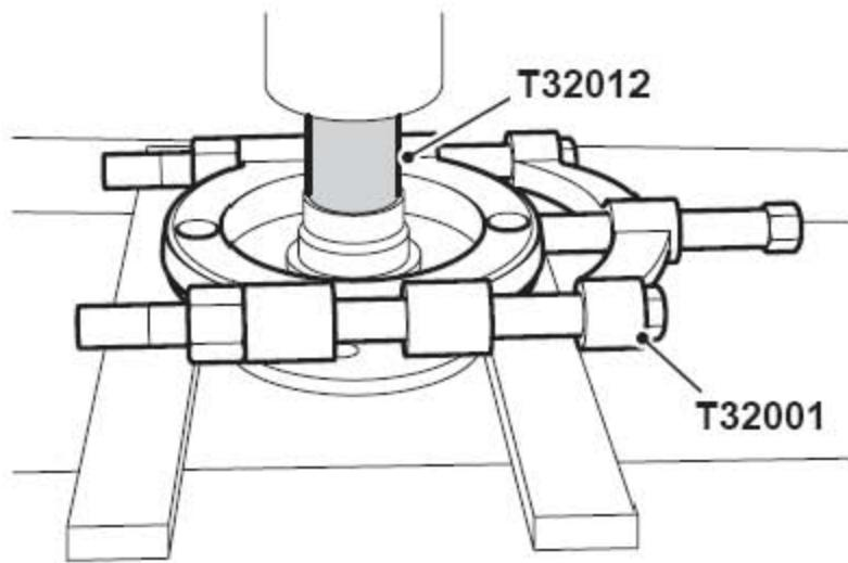
6). 用T32001和T32012, 从驱动法兰上拆卸轴承内圈。
