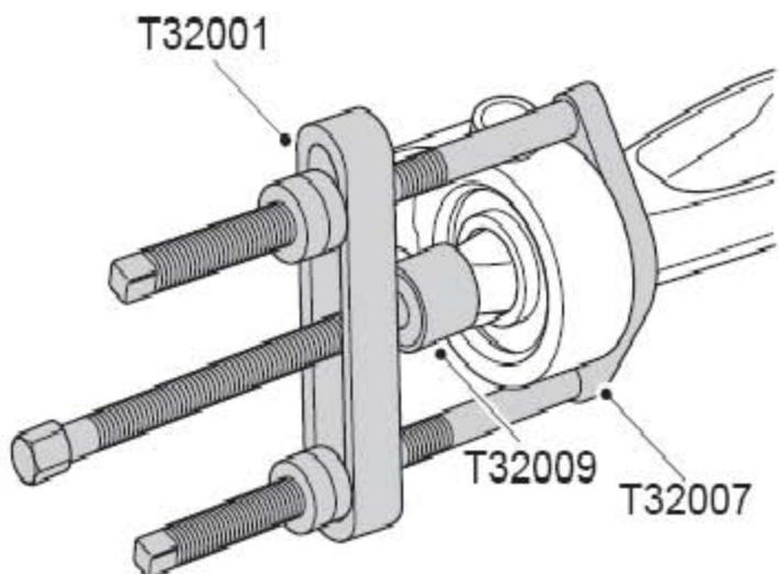
2). 用T32001， T32007和T32009拆下前下摆臂衬套和支架总成。
