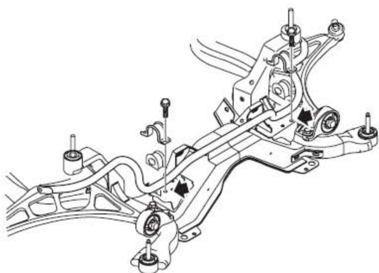
5). 取下将前横向稳定杆衬套支架固定到副车架上的个螺栓。
