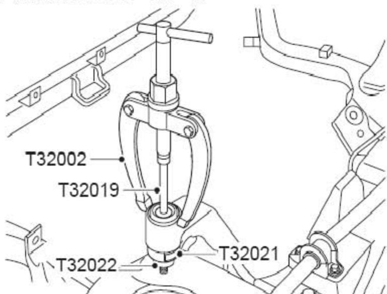
4). 按如图所示，使用专用工具T32019、T32002、T32021 和T32022拆下中塔橡胶衬套。
