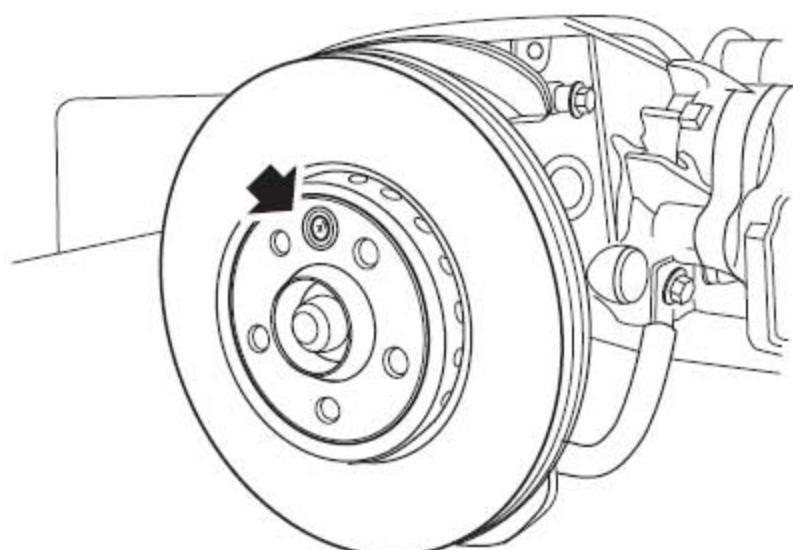
7). 拆下把制动盘固定到驱动法兰上的沉头螺钉。
