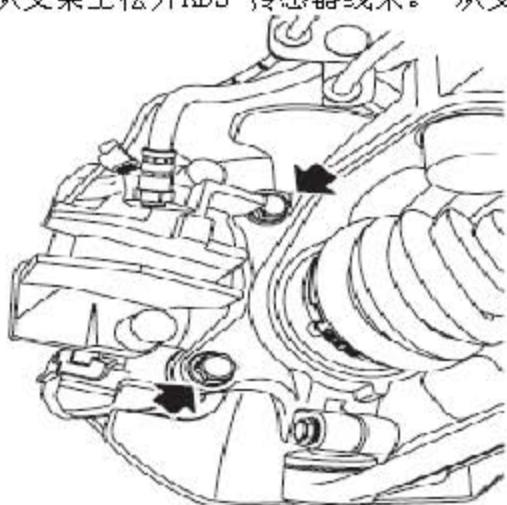
6). 取下将制动钳固定到前轮毂上的2个螺栓。8从前轮毂上松开制动钳并将其固定在旁边。
