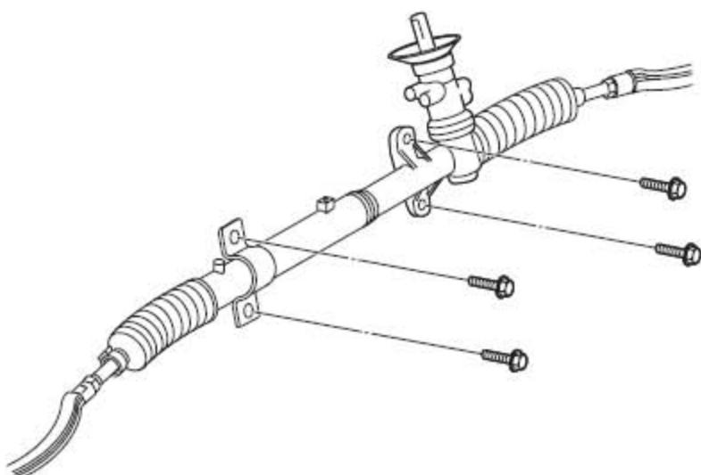
3). 取下将动力转向机固定到副车架上的4个螺栓。
