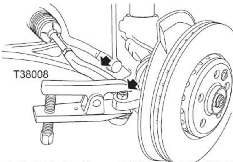
3). 拧下螺母，用工具T38008从转向臂上松开转向横拉杆球节。
