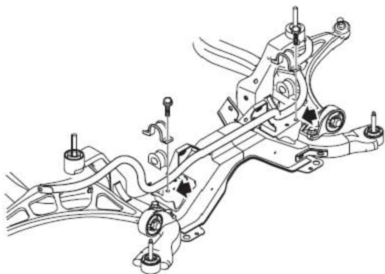
11). 取下将前横向稳定杆衬套支架固定到副车架上的4个螺栓。
