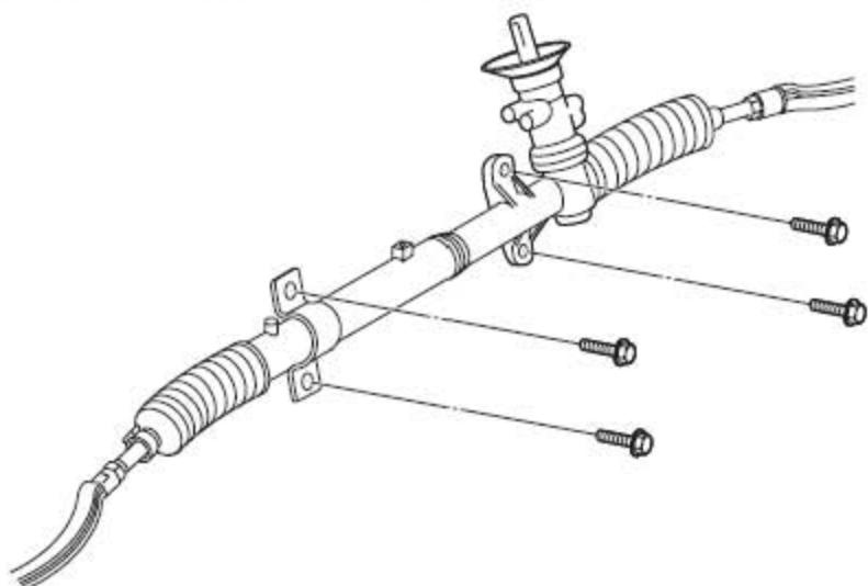
9). 取下把动力转向机固定到副车架上的4个螺栓，并从副车架上拿开动力转向机。
