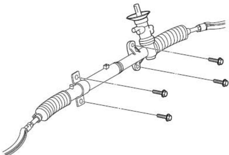
10). 取下将动力转向机固定到副车架上的4个螺栓。
