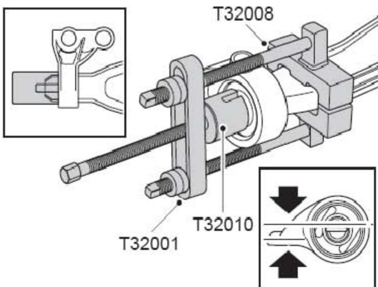
2). 把前下摆臂衬套和支架总成定位到前下摆臂上，确保衬套和前下摆臂上的标记对准。
