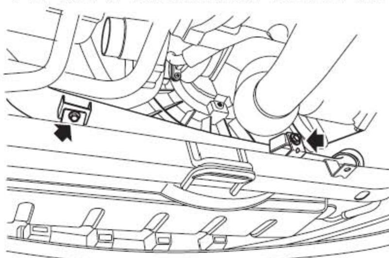
14). 取下将中冷器管支架固定到副车架上的两个螺栓。
