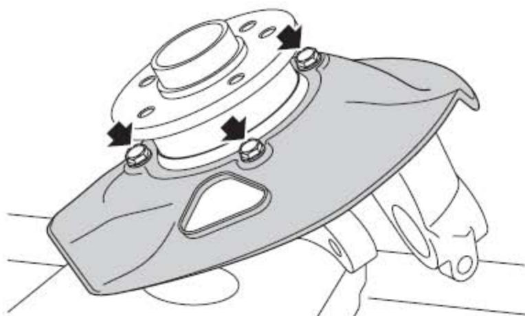
2). 拆下3个固定前制动盘护板的螺栓。
