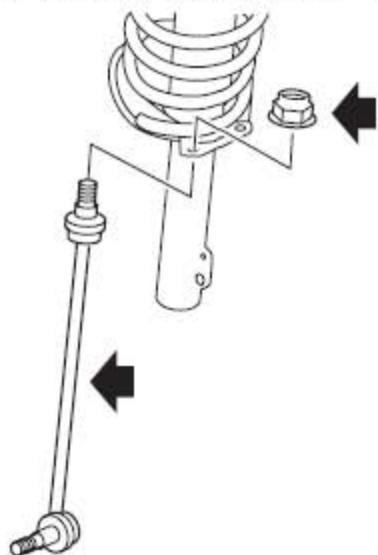
15).用一开口扳手卡住前横向稳定杆连接杆，以防止前横向稳定杆连接杆球节转动。取下将前横向稳定杆连接杆固定到减振器上的螺母。
