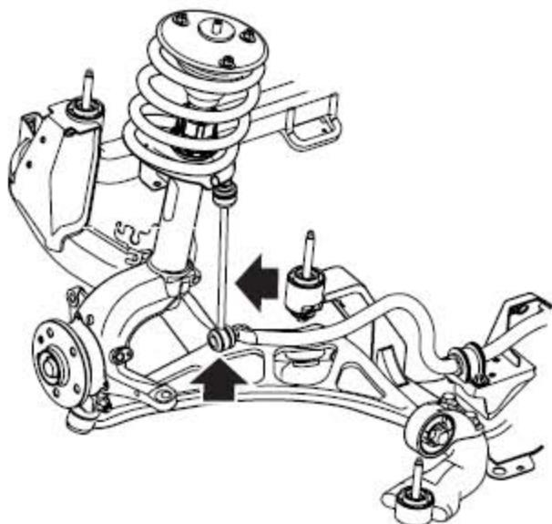
4). 用一开口扳手卡住前横向稳定杆连接杆，以防止前横向稳定杆连接杆球节转动。
