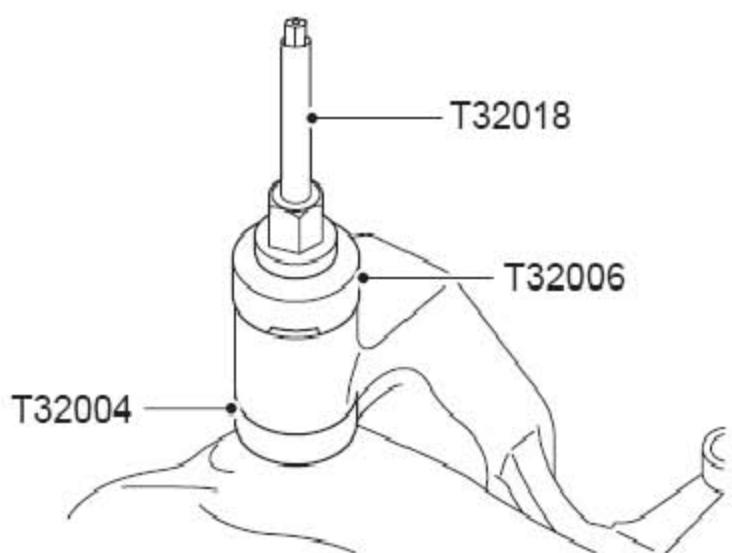
2). 按如图所示，用T32018， T32004和T32006装上新的前副车架橡胶衬套。
