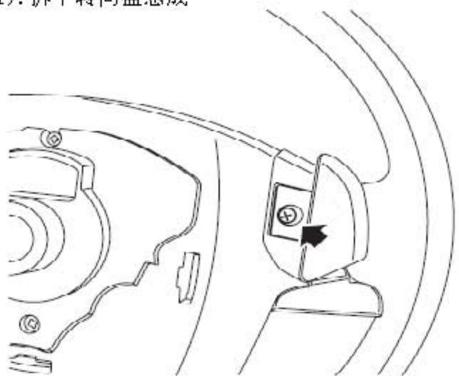
2). 拆下将Tiptronic拨片开关固定到方向盘上的螺钉（如果有）并小心松开将开关盖固定到方向盘上的卡箍。
