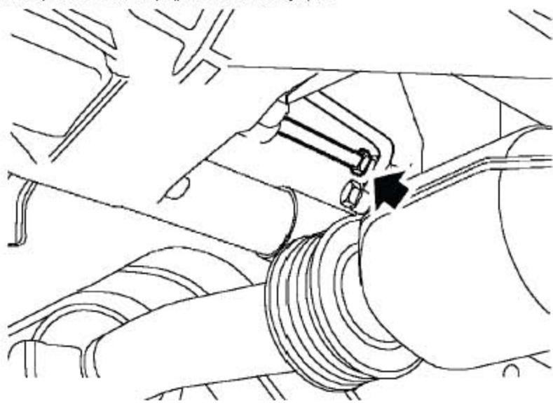
18). 拆下将动力转向机回油管紧固到动力转向机上的管接头，并废弃O型圈。
