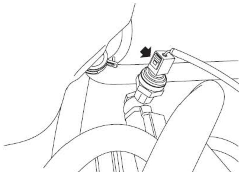
2). 断开压力传感器连接器的连接。
