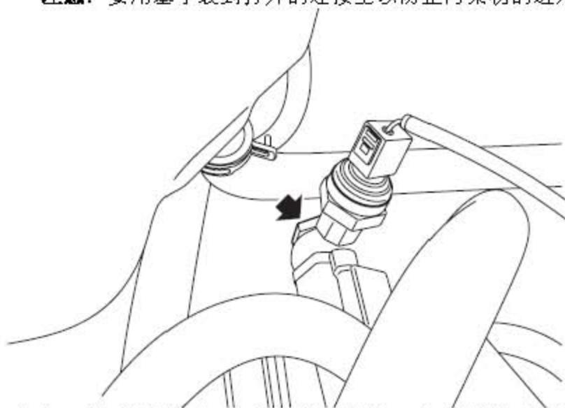
7). 拆下将动力转向机进油管固定到转向泵上的管接头，取下密封垫圈并废弃。
