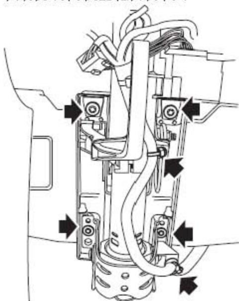
9). 拆下将转向管柱固定到仪表板骨架上的四个螺栓。
