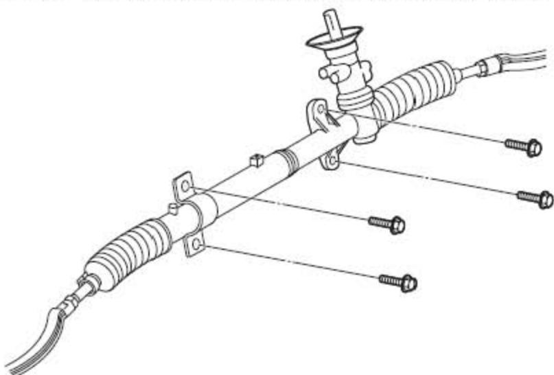
20). 拆下将动力转向机固定到副车架上的四个螺栓。
