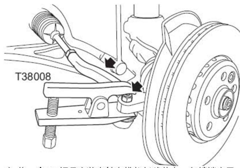
5). 将一个M10螺母安装在转向横拉杆球节上，与销端齐平。
