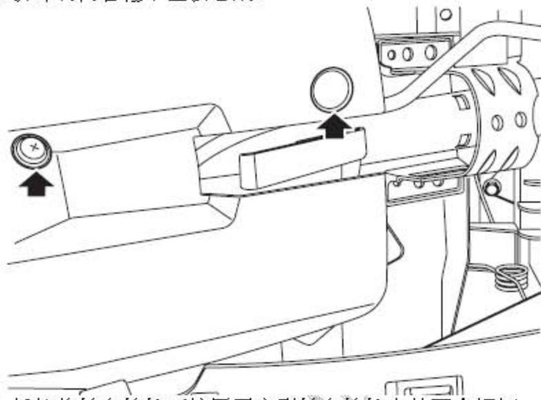
2). 拆卸将转向管柱下护罩固定到转向管柱上的两个螺钉。
