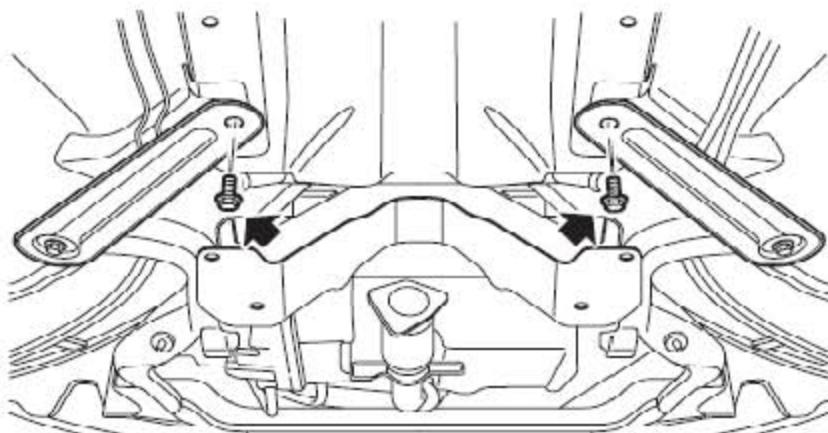
14). 拆下将副车架支撑杆紧固到车身上的两个螺栓并废弃。
