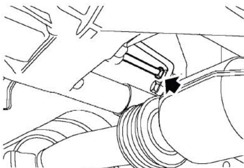
6). 拆下动力转向机进油管接头，取下密封垫圈并废弃。
