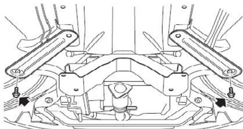
15). 拆下将副车架和副车架支撑杆紧固到车身上的两个中心螺栓和后部螺栓并废弃，收集好垫圈。
