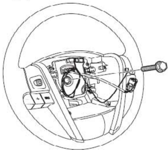
1). 拆下转向盘总成
