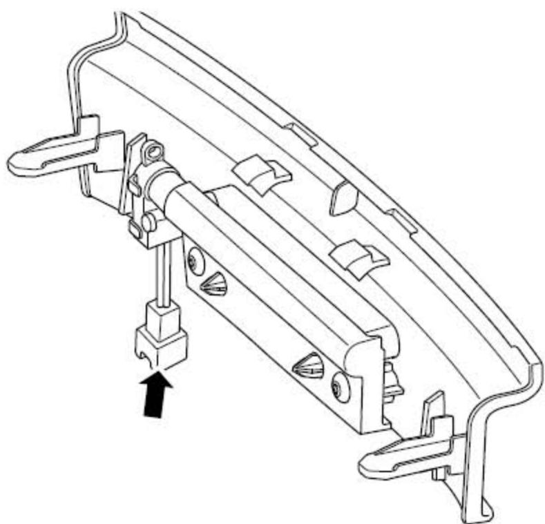
3). 断开中控台氛围灯的线束连接。
