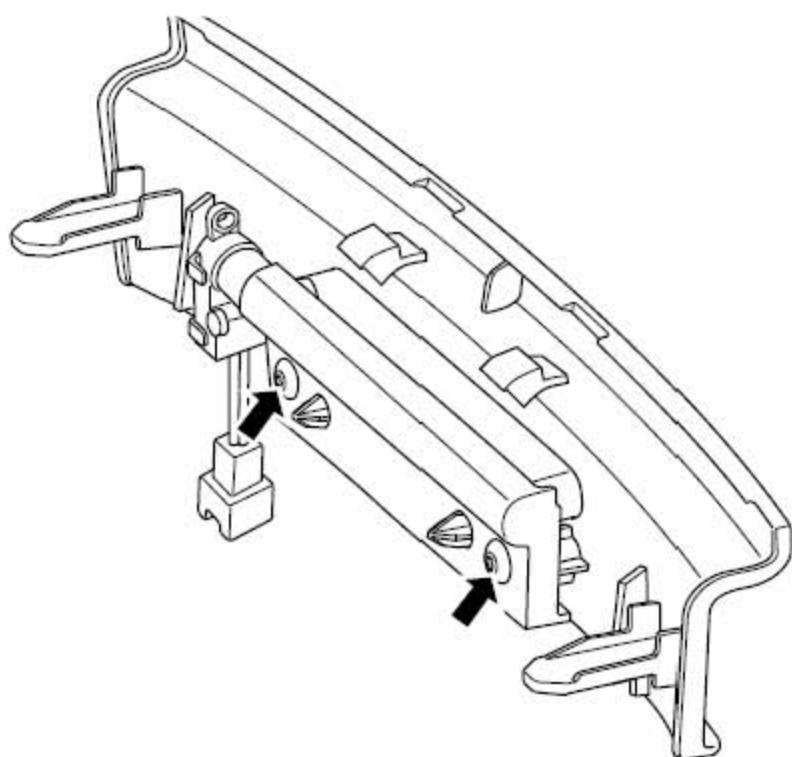
4). 拆卸中控台氛围灯支架的固定螺钉。
