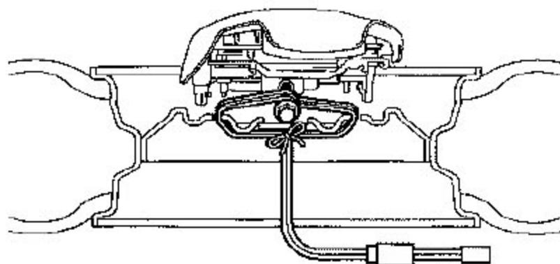
4) 准备一块蓄电池，用于作为安全气囊展开的电源，按照 9.1 验证专用维修工具 SST 的功能，断开与蓄电池的连接，并且将 SST 红色夹和黑色夹相互短接，防止因静电造成误展开。
