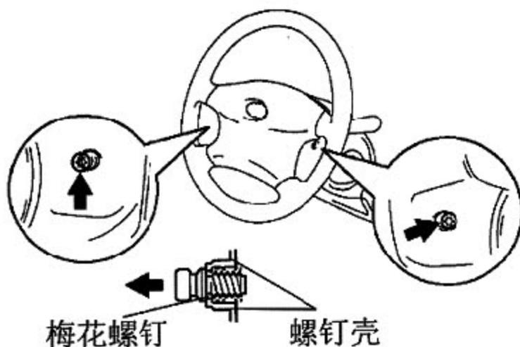
4). 将驾驶员安全气囊模块从转向盘上拉出，并拔出安全气囊连接器，如下图：
