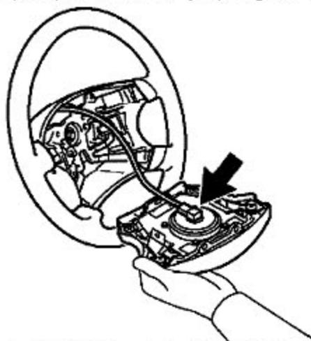
●注意：拆下驾驶员安全气囊模块时，应小心不要拉拽安全气囊线束，存放安全气囊模块时，应使饰盖朝上，禁止拆开驾驶员安全气囊模块。
