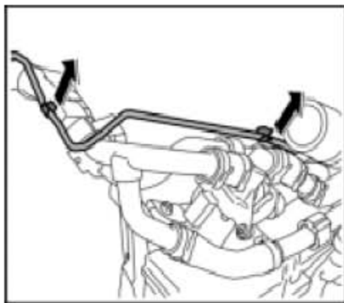
松开燃油管路
