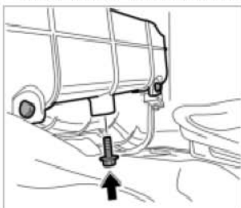
拧下右侧热交换器盖的紧固螺钉
