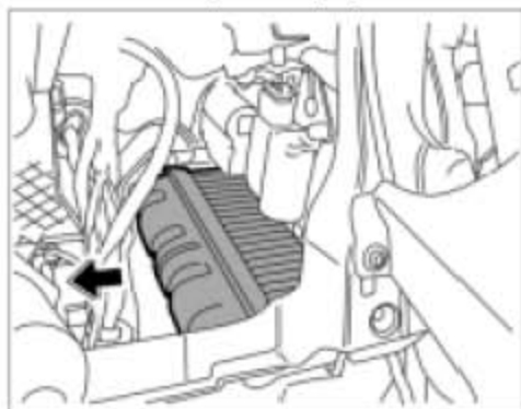
拆下热交换器。
