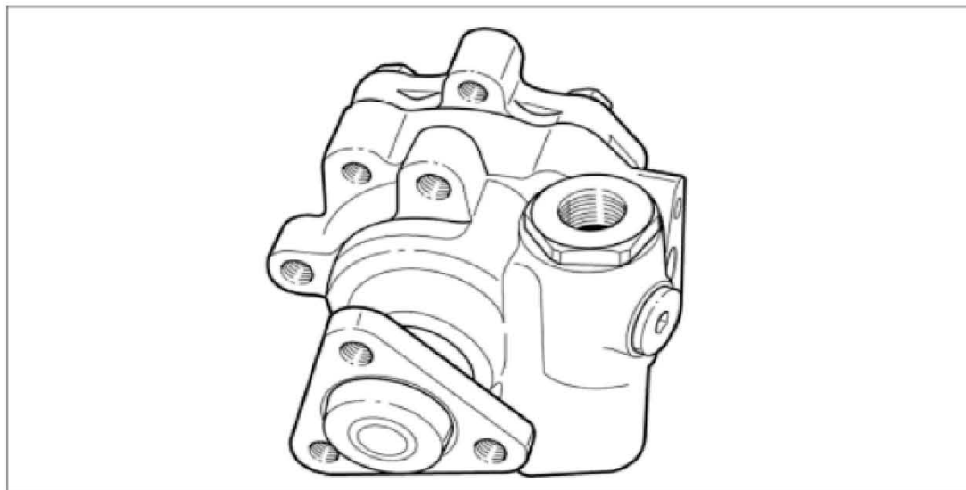
液压泵 (皮带轮已拆下)
