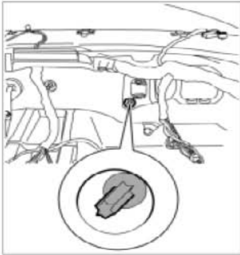
检查用于暖风/空调单元的支座（星形）
