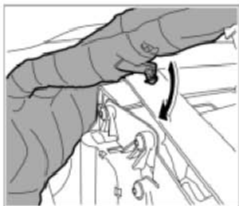
将主线束接合到暖风/空调单元上
