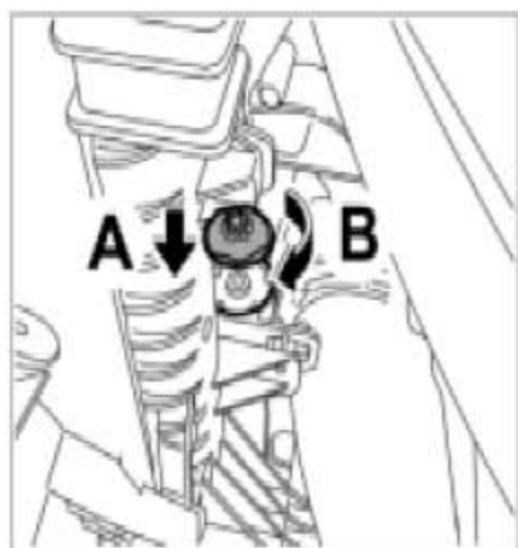
在塞子上放置橡皮塞并拧紧
