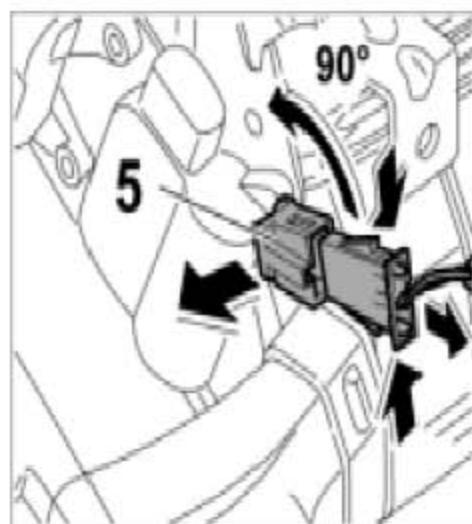
拆卸左侧搁脚板通风口的温度传感器
