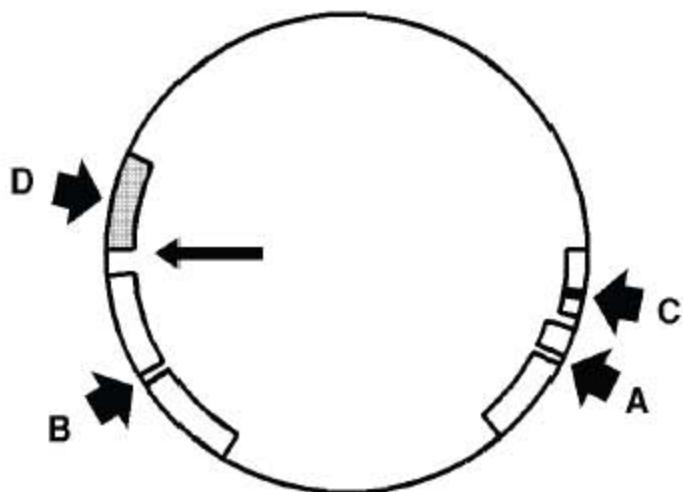
11). 确保活塞环能自由转动，把两个气环的缺口A和B彼此相对120° 的放置，并远离活塞的止推侧。
