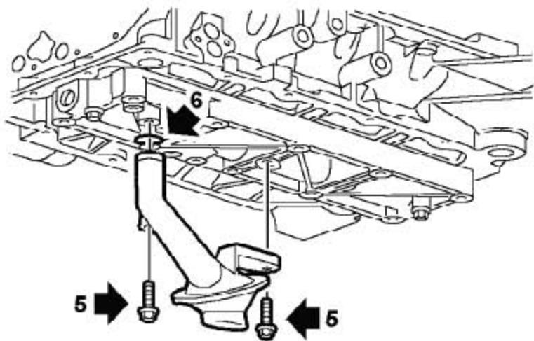
5). 拧下2个把机油集滤器固定到机油轨的螺栓，拆下机油集滤器。
