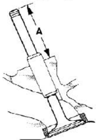
44). 检查气门杆的配合高度。（参照“规格”）
