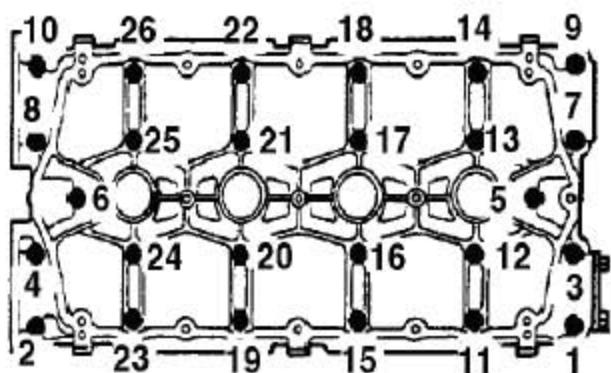
19). 再装上凸轮轴架，按顺序把螺栓拧紧到10Nm。不要转动凸轮轴。
