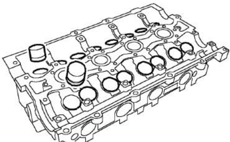
13). 从缸盖上取下16个挺柱，并按其安装顺序倒置存放以防止机油流失。
