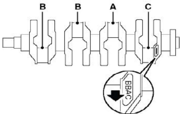
1). 从曲轴后平衡块上读取连杆大头轴颈尺寸分组代码。从左向右读，第一个代码是第一杆大头轴颈的直径等级。
