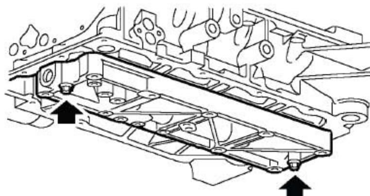
7). 拧下2个固定机油轨的螺母，拆下机油轨。
