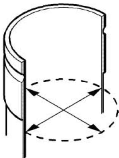
14). 距缸套口65mm处，在两轴向上测量磨损和锥度。
