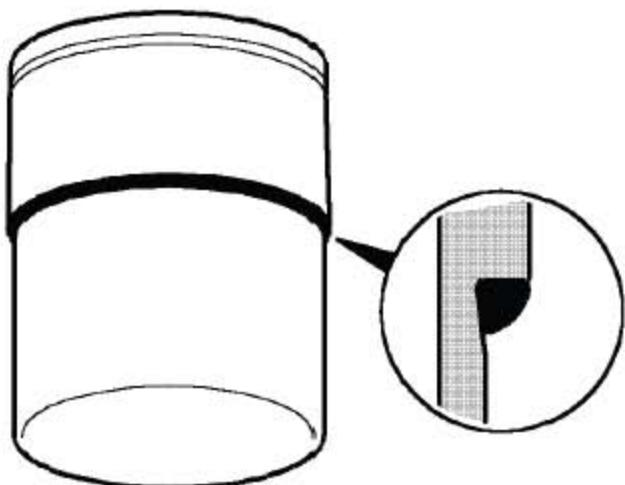
19). 沿缸套的肩部，涂上2mm厚的连续的密封剂，部件号FLM90002A。
