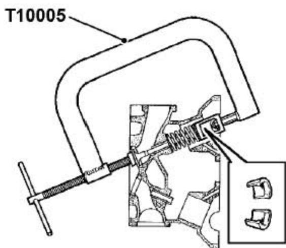
4). 润滑气门杆和气门总成，用工具T10005 来压缩气门弹簧。装上气门弹簧盖(密封用)。
