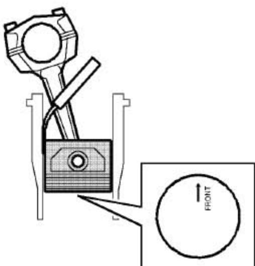
5). 将活塞和连杆朝下，把活塞冠部表面的箭头标记“—”朝向发动机的前端，把活塞装进缸套内。
