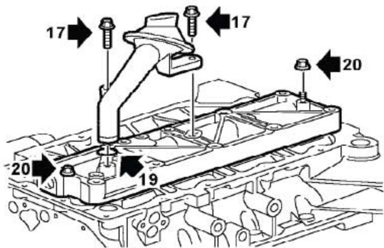
17). 拧下2个把机油集滤器固定到机油轨上的螺栓。
