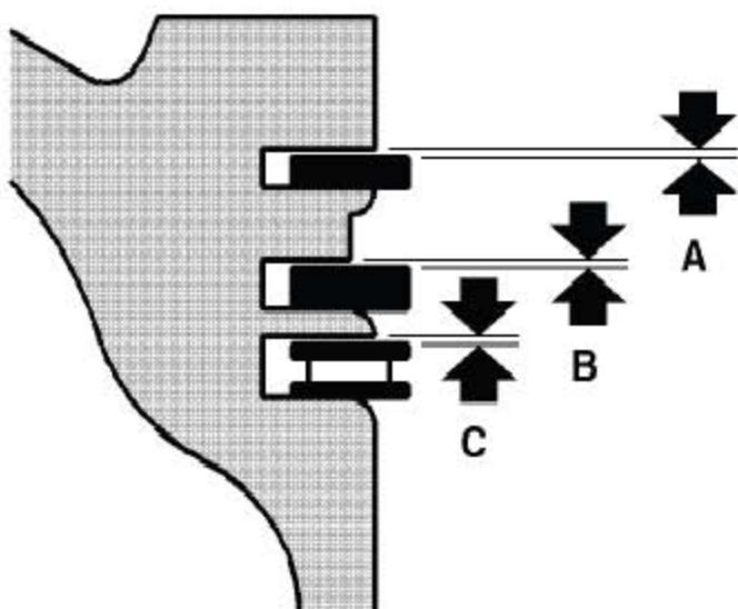
13). 检查新的活塞环至环槽的间隙。（参照“规格”）
