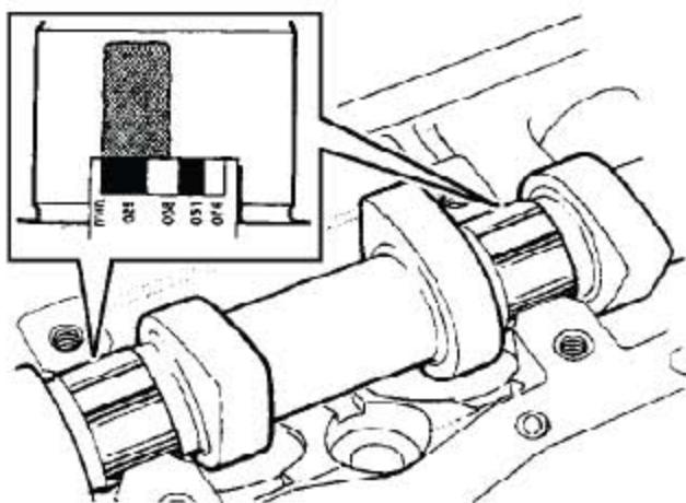
21). 测量每个轴颈上的塑料量规的最宽的部位。（参照“规格”）
