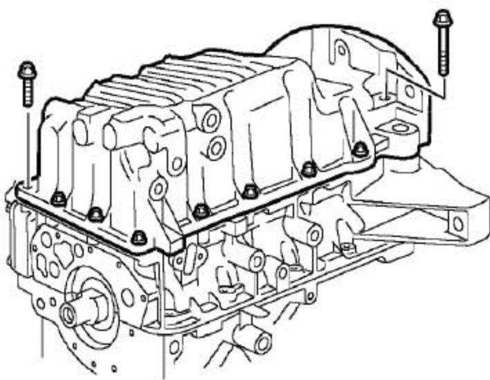
14). 注意安装好的2个最长螺栓的位置，拧下14个把油底壳固定到发动机轴承座上的螺栓。
