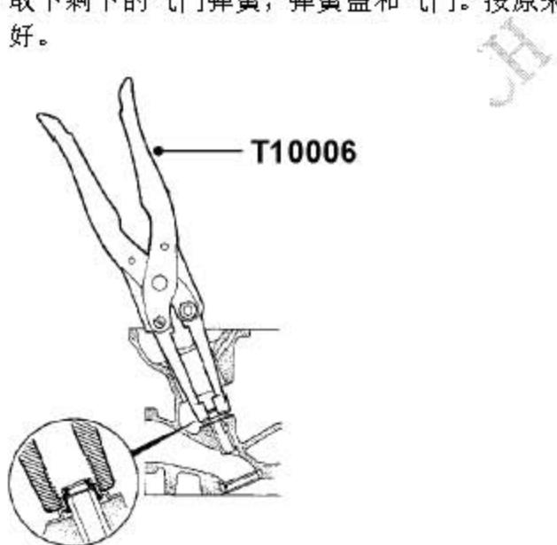
29). 用工具T10006取下气门杆油封。
