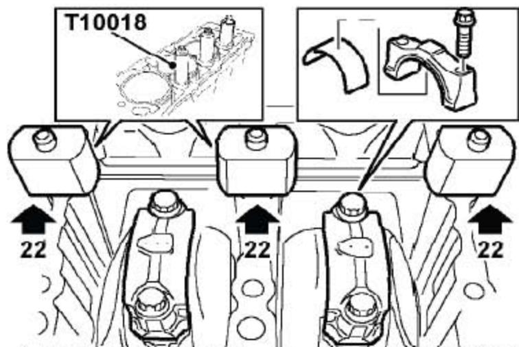
22). 用尼龙螺母固定平缸夹T10018。确保夹子的底部不会突出到缸套口的内径。
