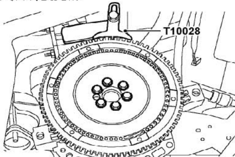
2). 把飞轮锁止工具T10028 装到缸体上，并用螺栓固定。
