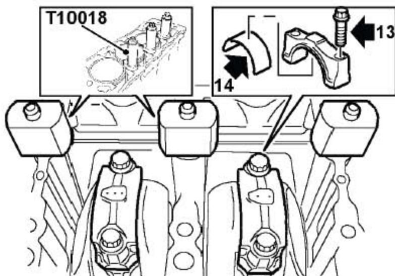
13). 按安装要求保持住把螺栓和连杆大头盖，拧下把连杆大头盖固定到连杆上的螺栓，并拿开连杆大头盖。
