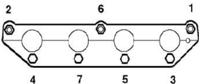
1). 按所示的顺序，渐次拧下把进气歧管固定到缸盖上的7个螺母。
