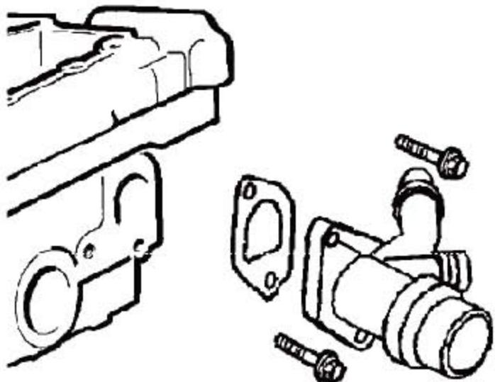
2). 拧下2个把冷却液出口弯接头固定到缸盖上的螺栓，拿开弯接头并废弃垫片。
