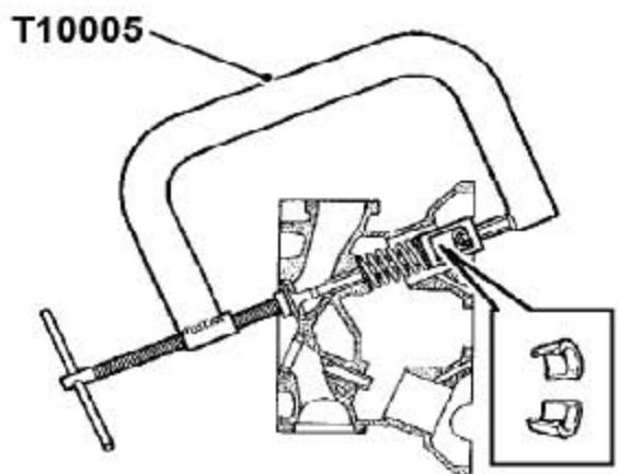
24). 用工具T10005压缩气门弹簧。
