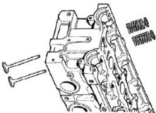
28). 取下剩下的气门弹簧，弹簧盖和气门。按原来的安装顺序，把气门和弹簧放好。
