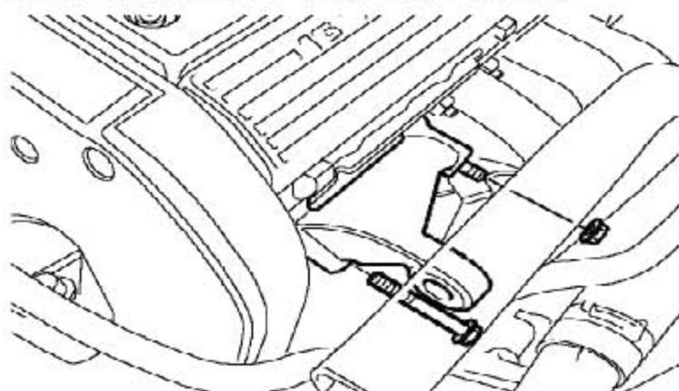
3). 拧下固定隔热板到发电机上支架的螺母和固定上支架到缸盖的螺母和螺栓。
