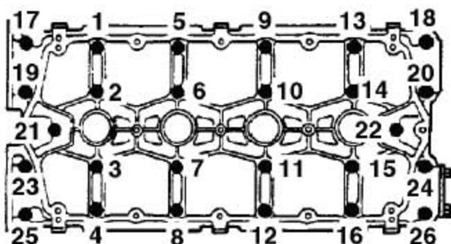
5). 按图所示的顺序，依次松开把凸轮轴支架固定到气缸盖上的26个螺栓，直到气门弹簧压力不再作用到凸轮轴上。注意4个长螺栓的安装位置。
