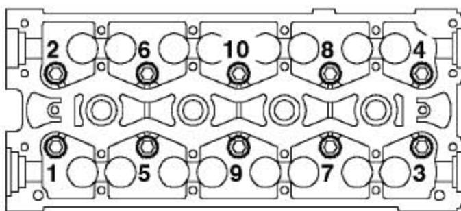
6). 按所示的顺序，充分松开缸盖上的螺栓1 至6，拿开螺栓并按安装顺序放好。
