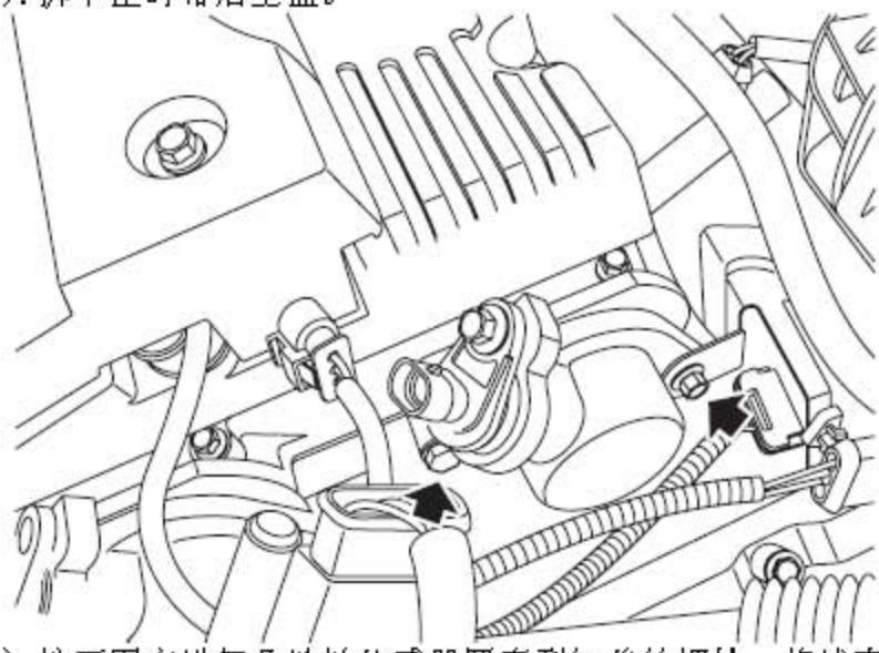
3). 拧下固定进气凸轮轴传感器罩壳到缸盖的螺栓，将线束放置一边，取下罩壳并废弃垫片。
