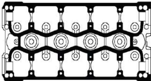
21). 在如图所示的凸轮轴支架路径上涂上的密封剂，内侧使用件号为FLMS0070A的厌氧胶，外侧使用件号为FLMS0080A的硅胶，然后用滚轮把密封剂涂成均匀薄膜。
