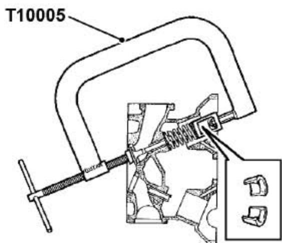
14). 装上气门。装上弹簧和弹簧盖，把T10005固定到气门和压缩弹簧上。
