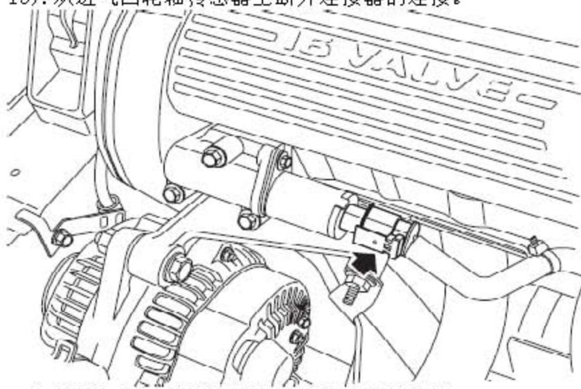
14). 从排气侧机油控制阀上断开连接器的连接。
