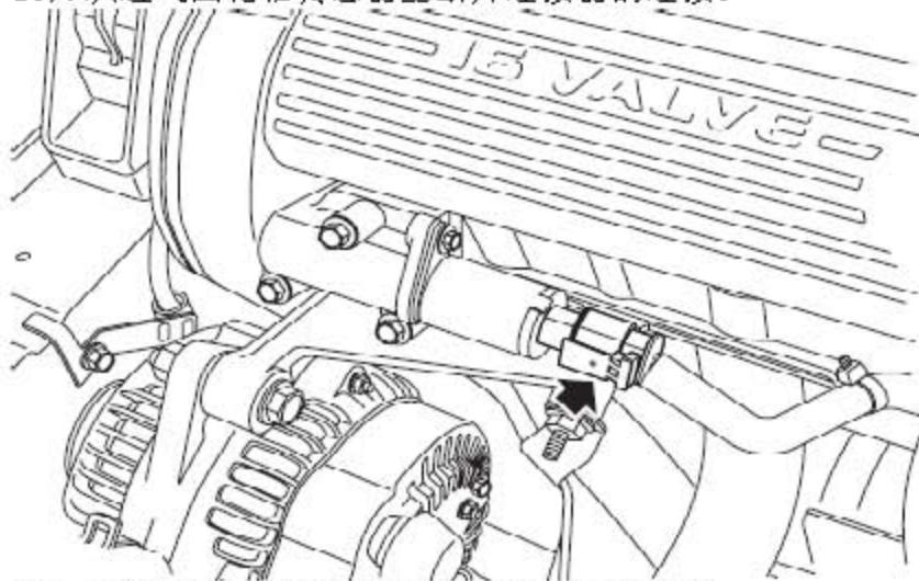
14). 从排气侧机油控制阀上断开连接器的连接。
