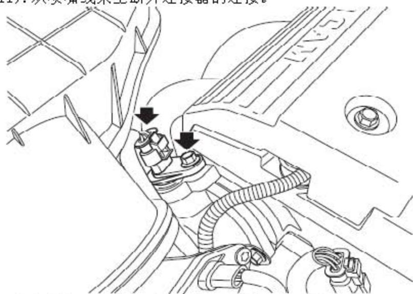
12). 从排气凸轮轴传感器上断开连接器的连接。
