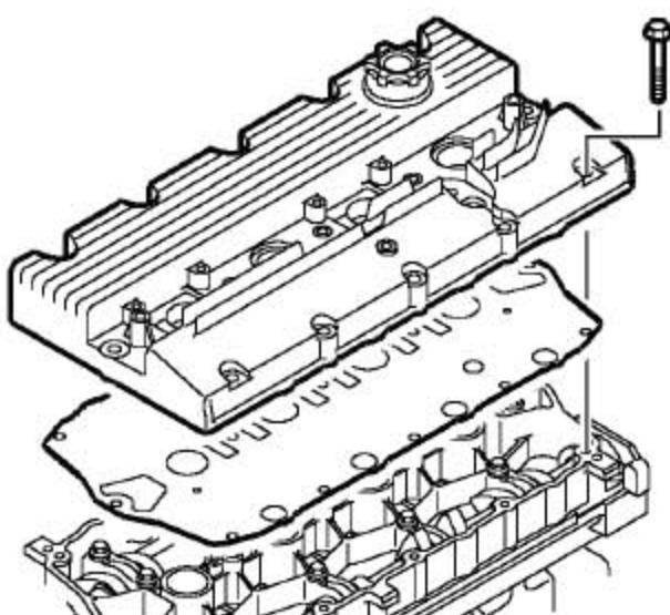
5). 慢慢松开固定凸轮轴盖的15个螺栓并取下。
