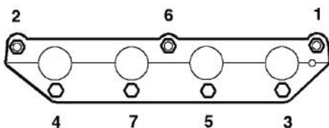
4). 按所示的顺序，渐次松开把进气歧管固定到缸盖上的7个螺母。
