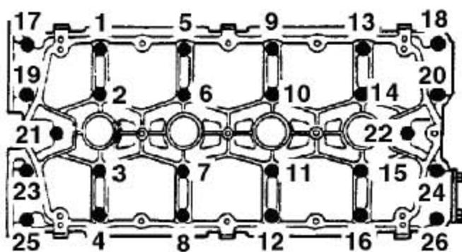
8). 按所示的顺序，渐次松开把凸轮轴架固定到缸盖上的26个螺栓，直到气门弹簧的压力全部释放。注意4个长螺栓的安装位置。
