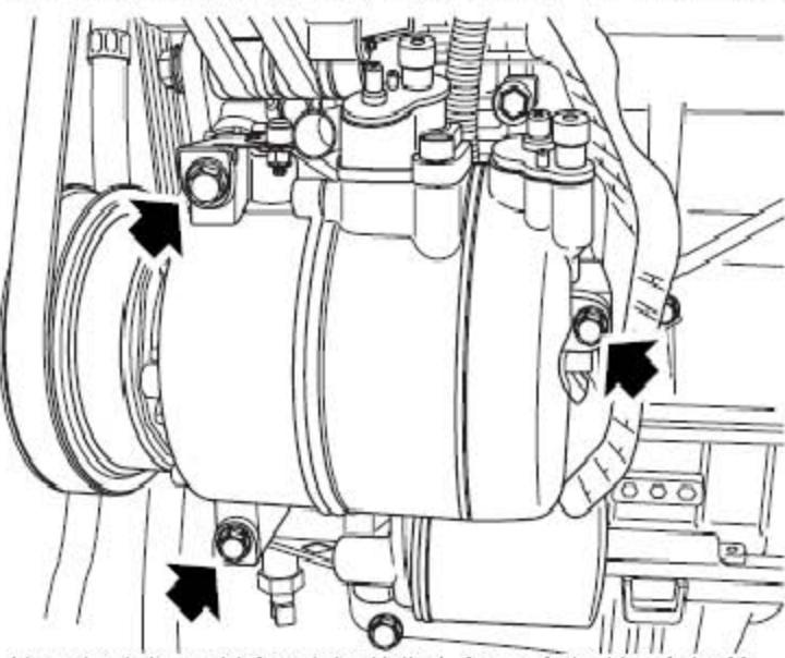
4). 拧下把空调压缩机固定到发电机下支架的3个螺栓，并拆下压缩机。
