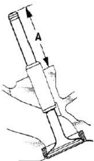
9). 检查气门杆的配合高度。（参照“规格”）如果还超过极限，就需要更换掉气缸盖和凸轮轴架总成。
