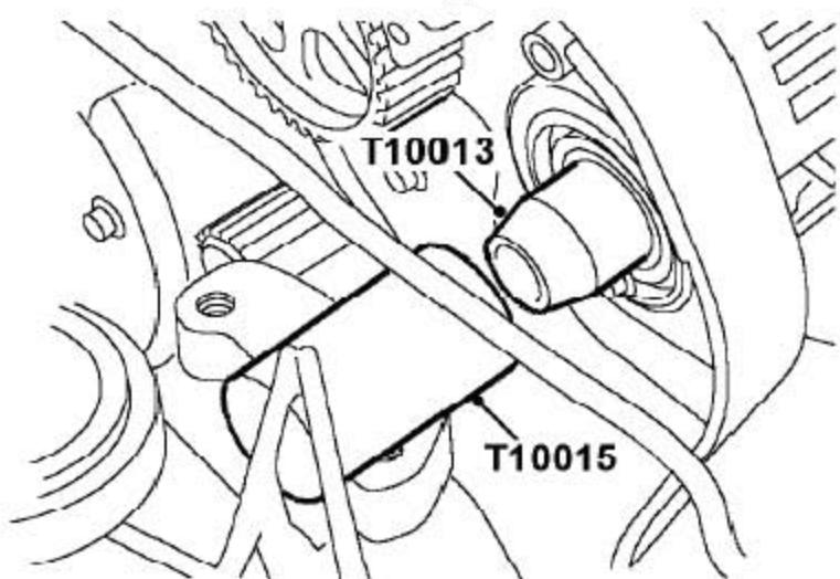
3). 用工具T10015装上新的凸轮轴油封，并取下T10013。
