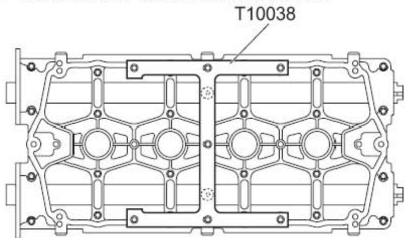
21). 拧下将专用工具T10038固定到缸盖上的7个螺栓，并取下工具。
