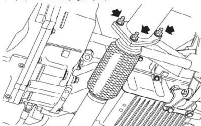
3). 拧下3个固定排气歧管到排气管的螺母，取下并废弃垫片。
