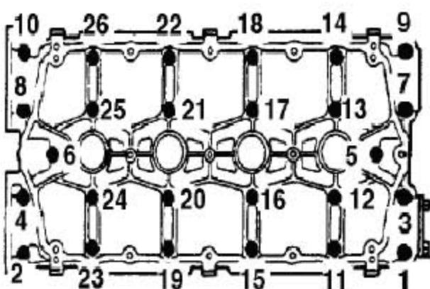
8). 按图所示的顺序装配，依次拧紧把凸轮轴架固定到缸盖上的螺栓，扭矩10Nm。
