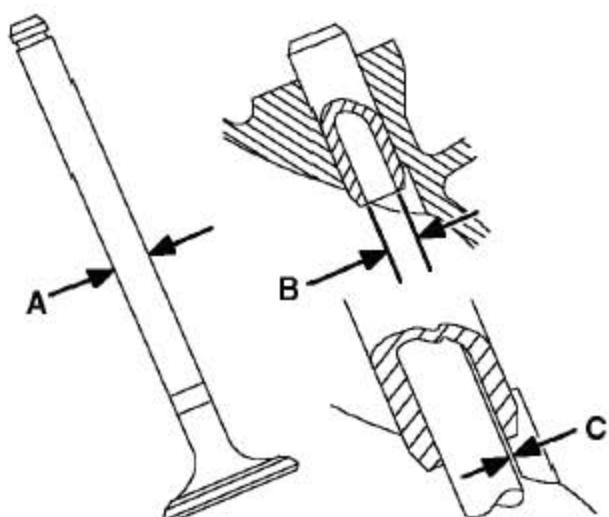
2). 检查现有的气门杆的直径。用新的气门检查气门导管的间隙。（参照“规格”）
