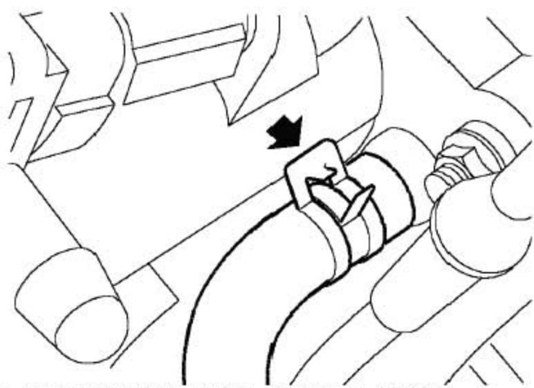
20. 松开夹箍并从进气歧管上断开膨胀水箱软管。
