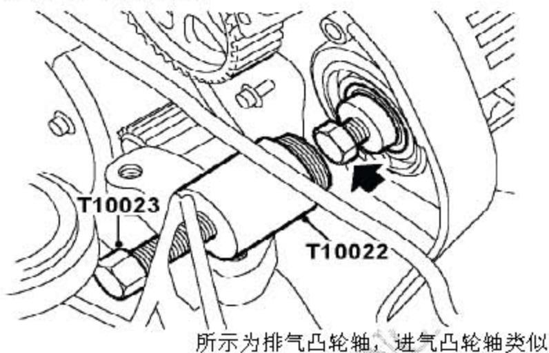
3). 用T10022和中心螺栓T10023取下凸轮轴油封。
