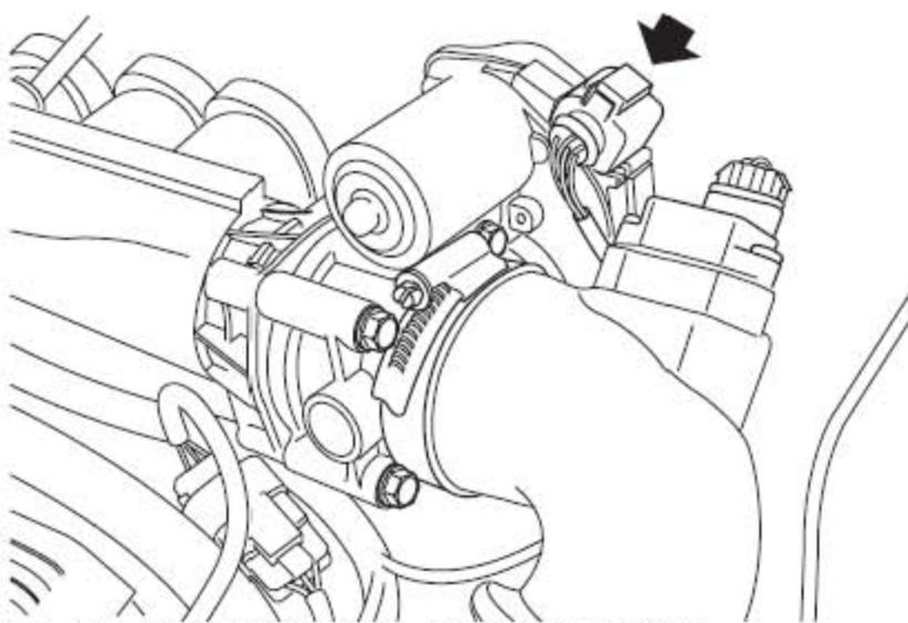
10). 从电子节气门传感器上断开连接器的连接。
