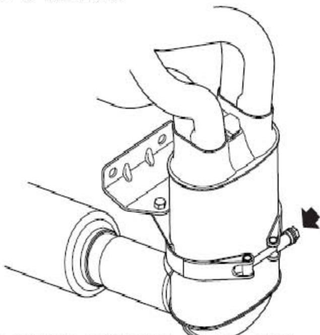
9). 松开固定排气岐管支架的夹箍，并取下支架。
