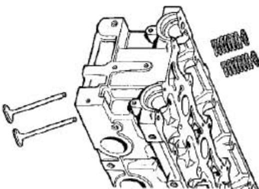
16). 取下气门弹簧，气门弹簧盖和气门。
