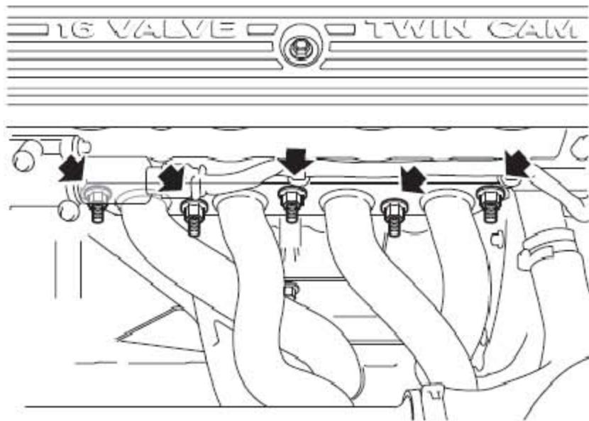
7). 拧下5个固定排气岐管到缸盖的螺母，取下排气岐管。
