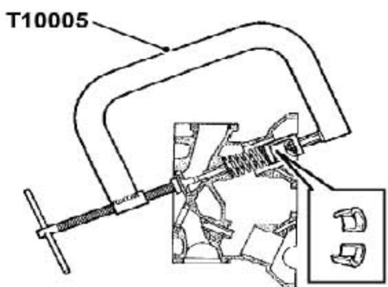
13). 用工具T10005压缩气门弹簧。
