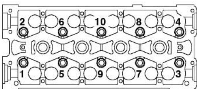
22). 按所示的顺序，渐次松开缸盖上的螺栓1至6，拿下螺栓并按安装顺序放好。
