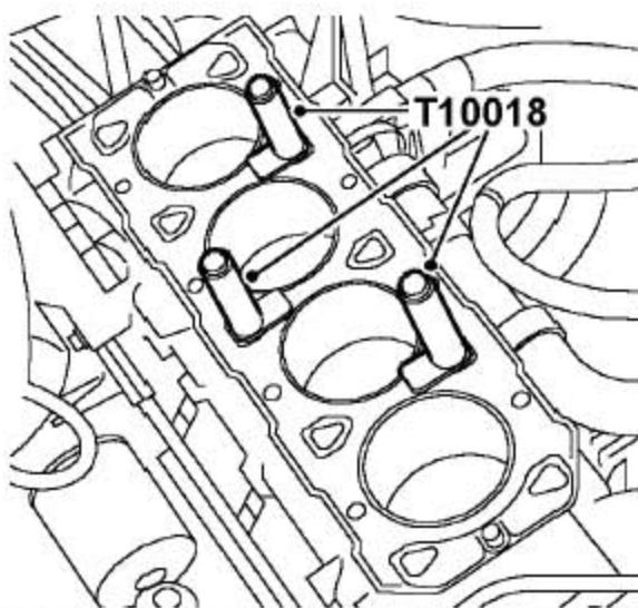
27). 把平缸夹T10018装到缸体上并用缸盖螺栓固定。确保平缸夹的底部没有突到缸套口的内径。
