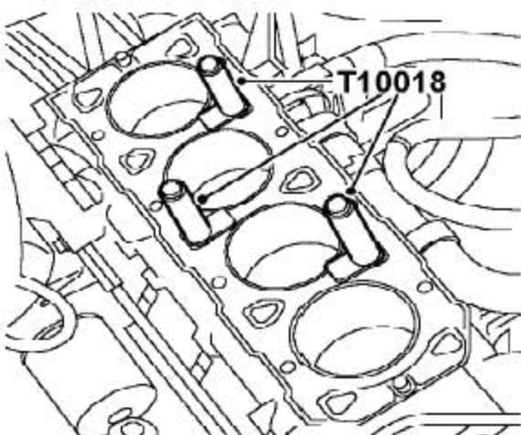
11). 把平缸夹T10018装到缸体上，用缸盖螺栓固定，要保证夹子的边缘不会突出到缸套的内径。
