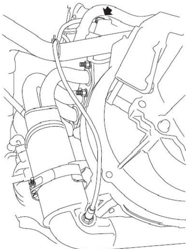
5). 断开前热氧传感器连接器的连接。
