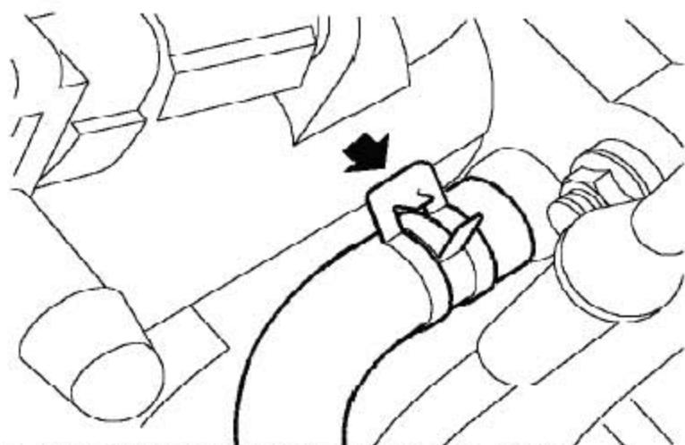
20). 松开夹箍并从进气歧管上断开膨胀水箱软管。
