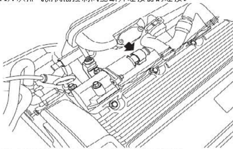
15). 从进气侧机油控制阀上断开连接器的连接。
