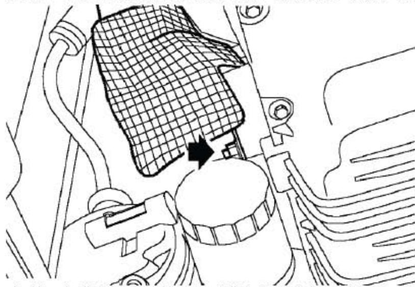
5). 拧下把发电机隔热板固定到发电机下支架上的螺栓并取下隔热板。
