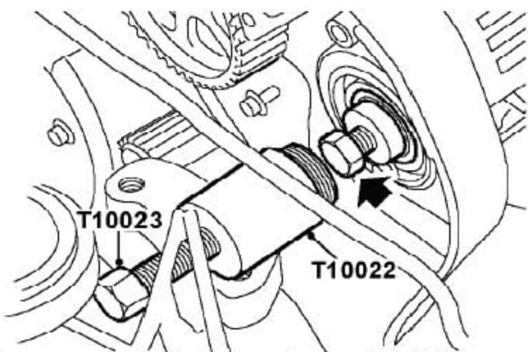
3). 用T10022和中心螺栓T10023取下凸轮轴油封。
