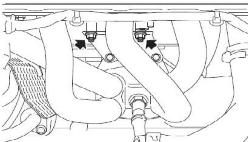
4). 拧下固定排气歧管支架到缸体的2个螺柱和2个螺母。
