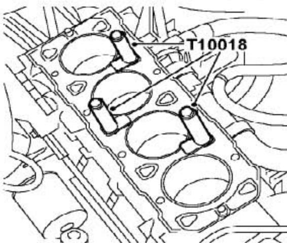
27). 把平缸夹T10018装到缸体上并用缸盖螺栓固定。确保平缸夹的底部没有突到缸套口的内径。
