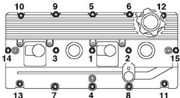
4). 把凸轮轴盖装到凸轮轴架上。装上螺栓,按图中所示的顺序,依次把螺栓拧紧至10Nm。
