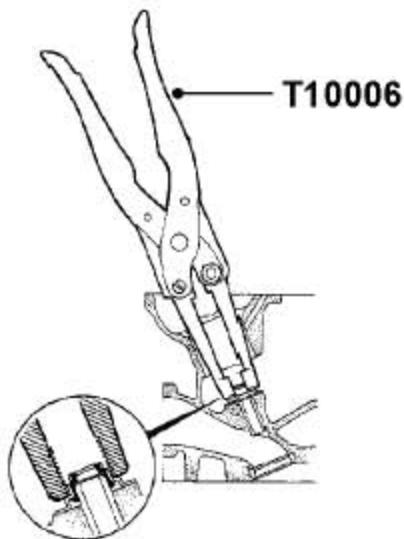
13). 用T10006把气门杆油封装到气门导管上。
