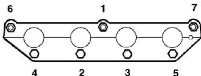
3). 固定进气歧管，装上7个螺母并拧紧，按所示的顺序拧紧至17Nm。
