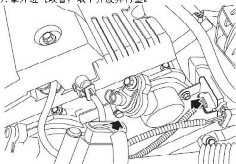
6). 拧下固定进气凸轮轴传感器罩壳到缸盖的螺栓，取下罩壳并废弃垫片。
