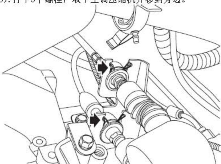
14). 从变速器安装支架上松开卡口并断开换挡拉索。
