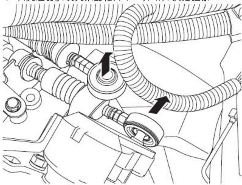
15). 注意安装位置，小心地断开两个换挡拉索球头。
