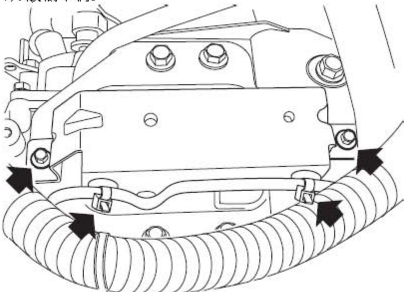
38). 拧下2个固定蓄电池盒安装支架到变速器左液压悬置支架的螺栓，并取下支架。同时松开2个线束卡口。
