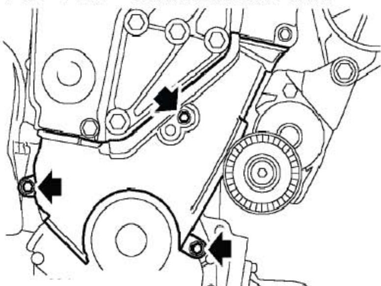
11). 拧下3个螺钉并取下正时带前下盖和密封。
