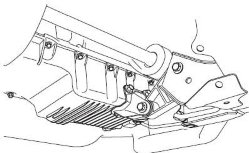
5). 拧下4个螺栓并从油底壳上拿开发动机下系杆支架。
