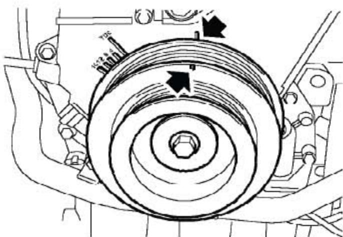
4). 顺时针转动曲轴以确保曲轴皮带轮上的正时标记和正时带下前上盖的标记对准。
