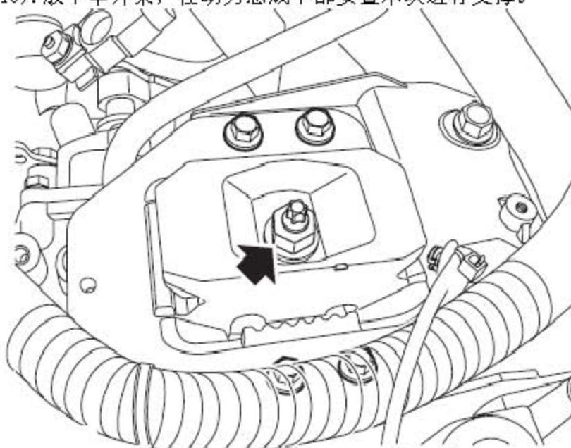
41). 拧下把变速器左安装支架固定到变速器左液压悬置支架的螺母。
