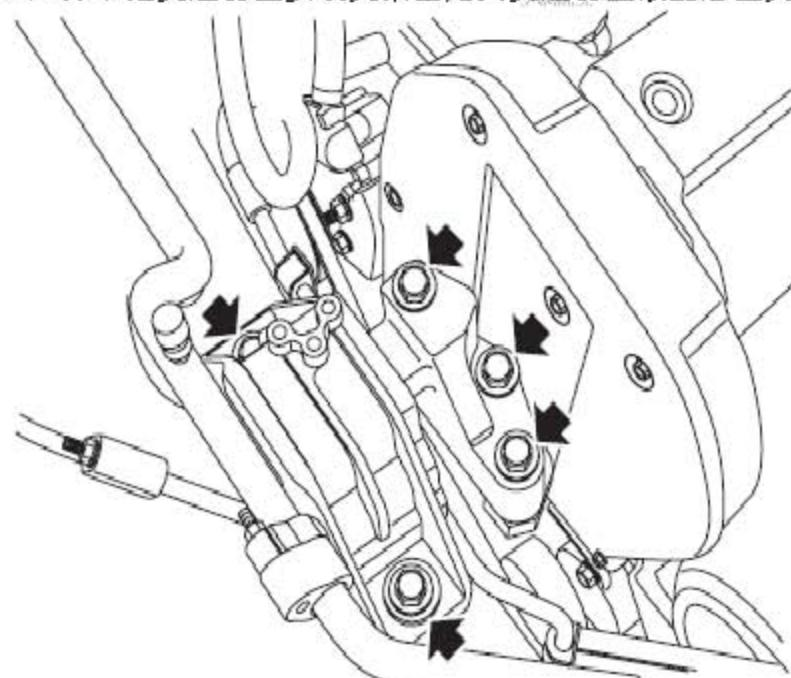
42). 拧下固定发动机右液压悬置到发动机的3个螺栓。
