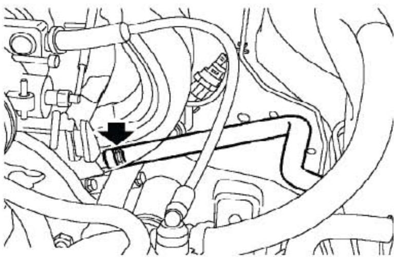
25). 松开把加热器软管固定到缸体的夹箍并断开软管的连接。
