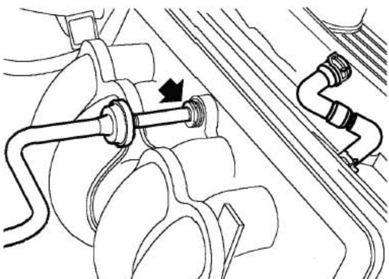
26). 从进气歧管上断开真空管的连接。
