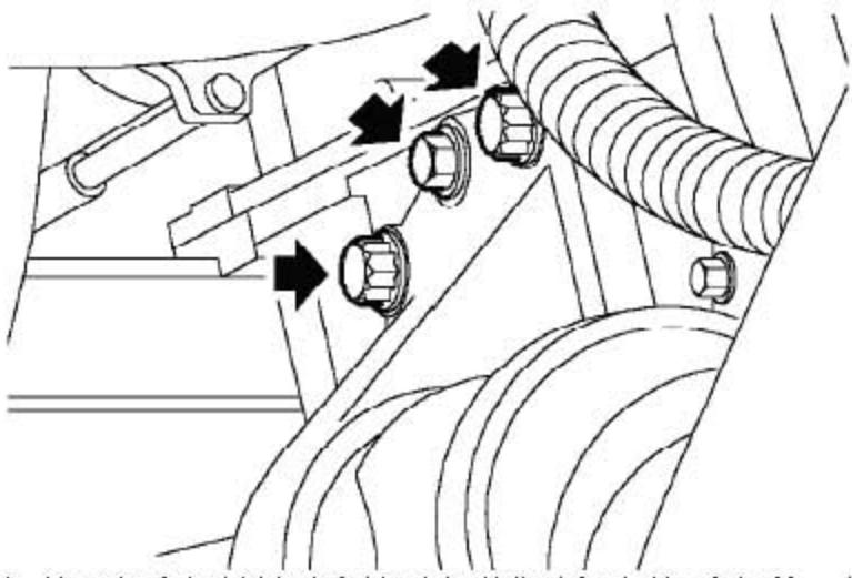
36). 拧下把中间轴轴承支撑固定到发动机上的3个螺栓，从变速器上取下传动轴并放置一旁。
