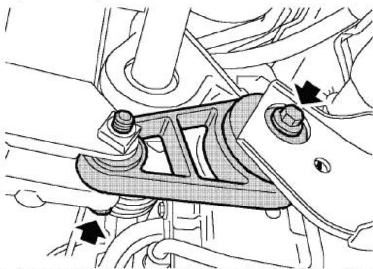
4). 拧下把发动机下系杆固定到发动机下系杆支架上的螺栓。
