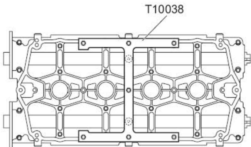
6). 将凸轮轴锁止工具T10038的定位销对准凸轮轴上的定位孔，并装上7个缸盖螺栓固定。
