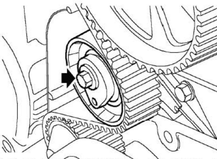
12). 拧下并废弃掉正时带张紧轮螺栓，并拆下张紧轮。如果还要装原来的皮带，标记下皮带上的转动方向。
