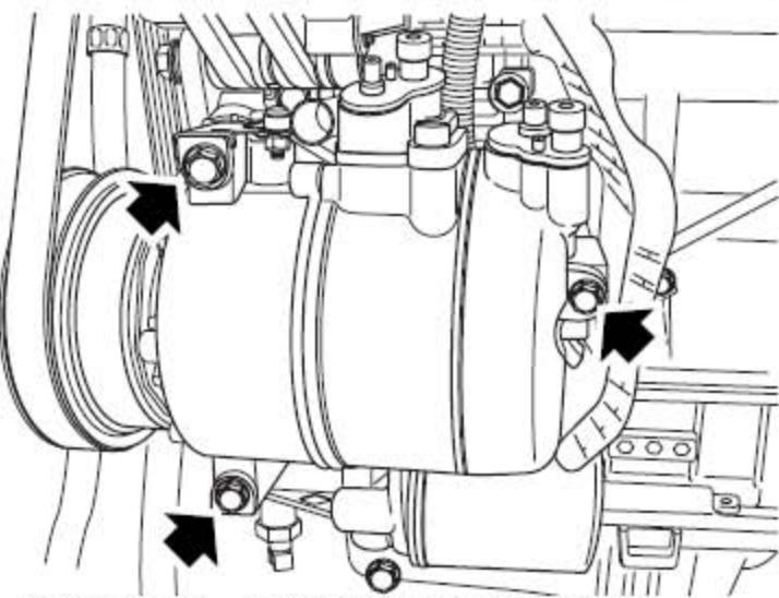
13). 拧下3个螺栓，取下空调压缩机并移到旁边。
