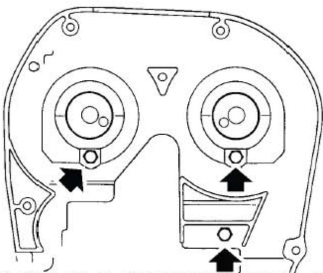
10). 拧下把正时带后上盖固定到发动机上的螺栓，拿开盖子。
