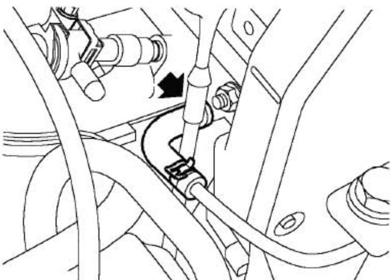
22). 在缸体上松开固定回液软管到散热器的夹箍，并断开软管的连接。
