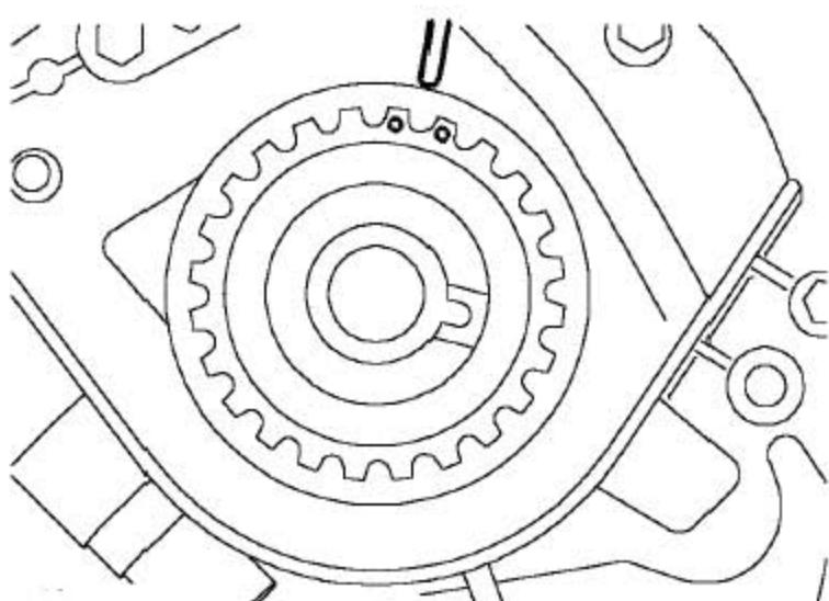
3). 检查曲轴齿轮上的孔和机油泵上的法兰是否对准。
