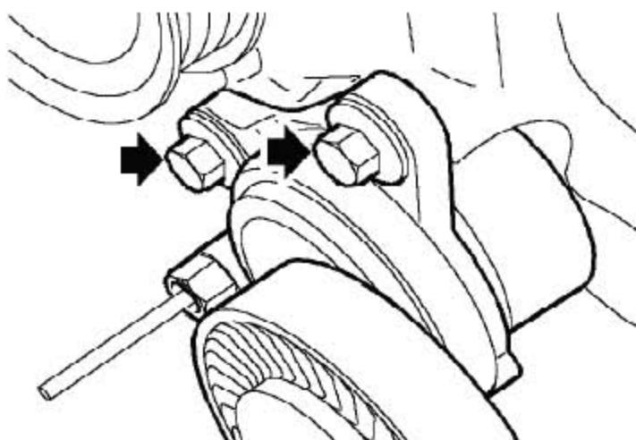
8). 拧下2个固定PAS泵张紧轮的螺栓并拆下张紧轮。
