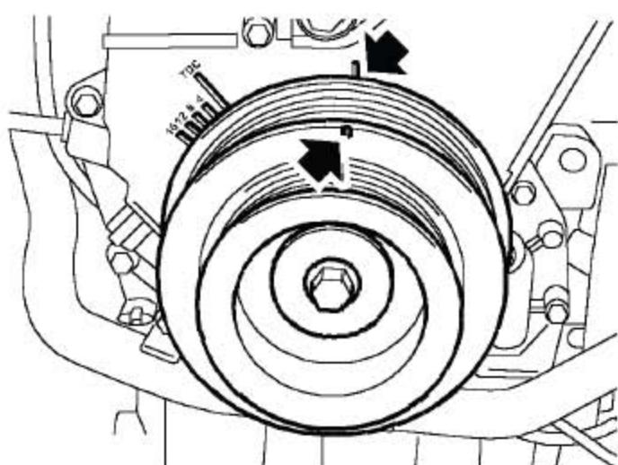
4). 顺时针转动曲轴以确保曲轴皮带轮上的正时标记和正时带下前上盖的标记对准。
