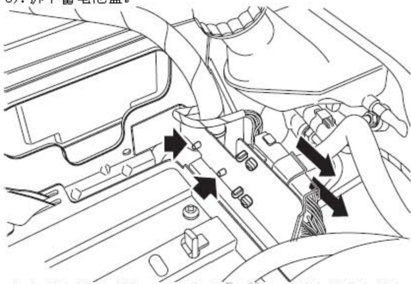
9). 把蓄电池接地端子和线束连接器固定到蓄电池盒上的夹子松开。
