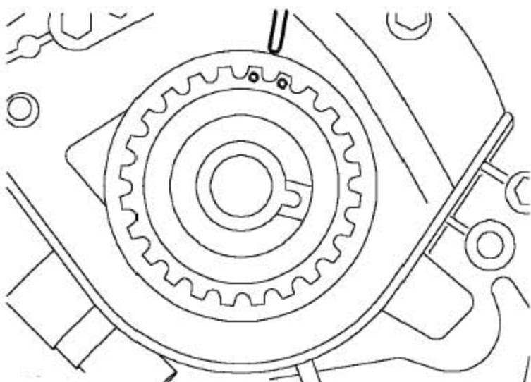
3). 检查曲轴齿轮上的孔和机油泵上的法兰是否对准。
