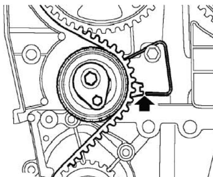
16). 如果要装原来的皮带，那么指针就必须对准好，这样指针线就靠近指针的下区域。
