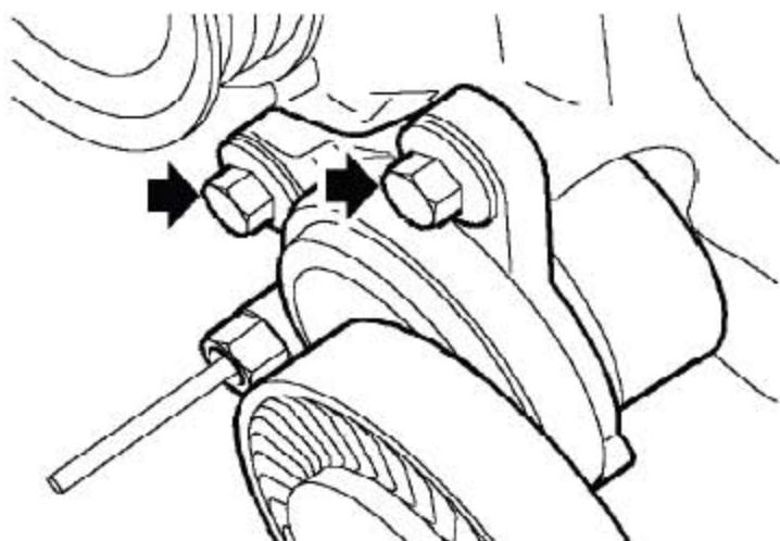
10). 拧下2个固定PAS泵张紧轮的螺栓并拆下张紧轮。
