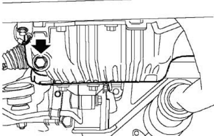
3). 把一合适的容器放在发动机油底壳的放油塞下面，拧开塞子并废弃密封垫圈。把油放掉。
