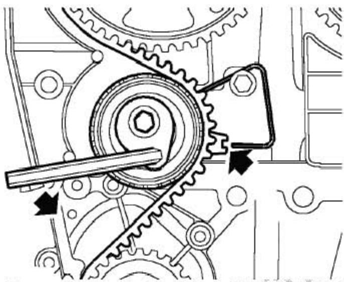
15). 用一6mm的Allen键，逆时针方向转动张紧轮杆，并使指针和如图所示的指针线对准。
