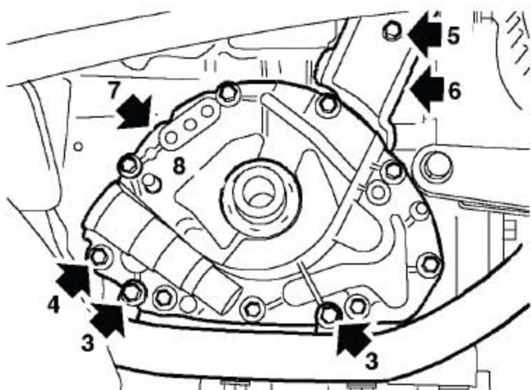
3). 拧下个把发动机线束固定到机油泵上的螺栓并拿开线束以使机油泵可见。
