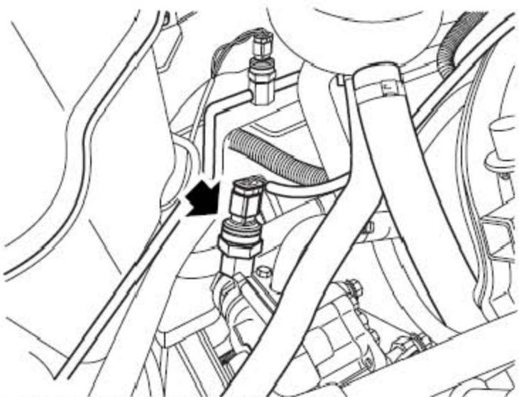
20). 断开PAS压力传感器连接器的连接。
