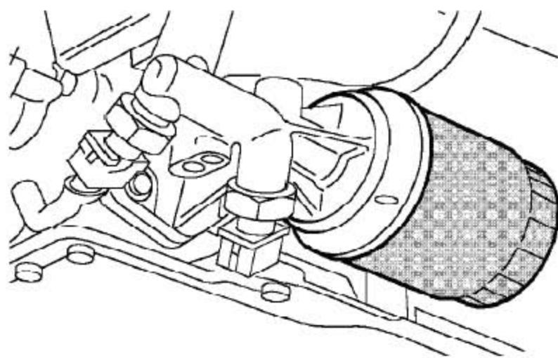
5). 拆下并废弃发动机机油滤清器。
