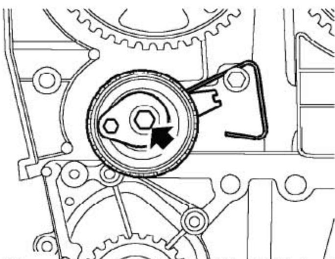
4). 装上正时带张紧轮，固定在如时钟9点的位置，拧紧新的夹紧螺栓，直到刚好能移动张紧轮杆。
