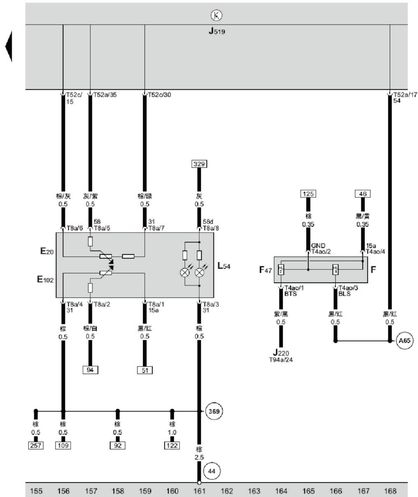
BCM 车身控制单元、开关和仪表照明调节器、大灯光线水平调整调节器、制动踏板开关、刹车灯开关、大灯照明距离调节器照明灯泡
