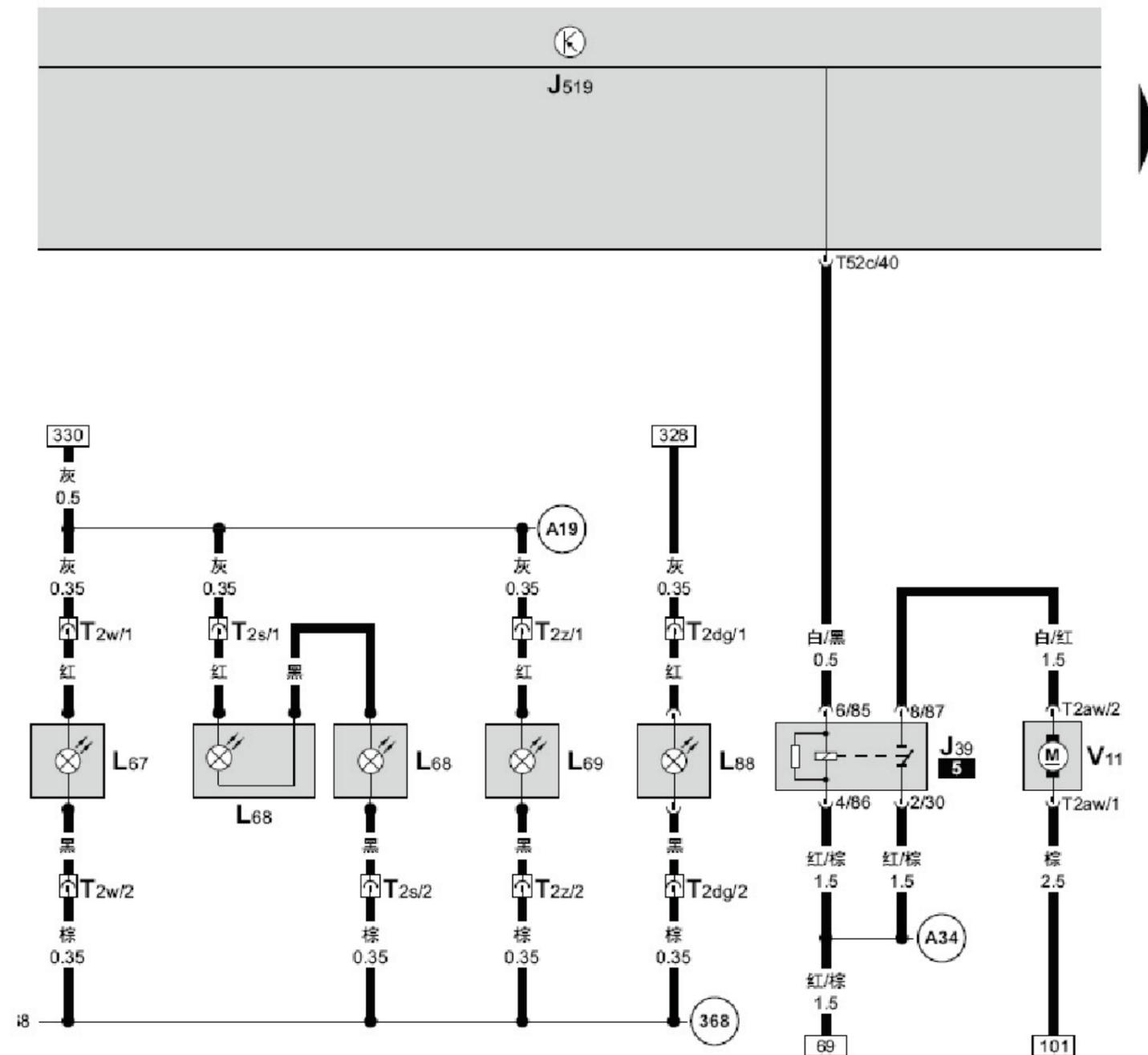
J39 — 大灯清洗装置继电器，在仪表板左侧上部继电器板上 5 号位 (53 继电器)
