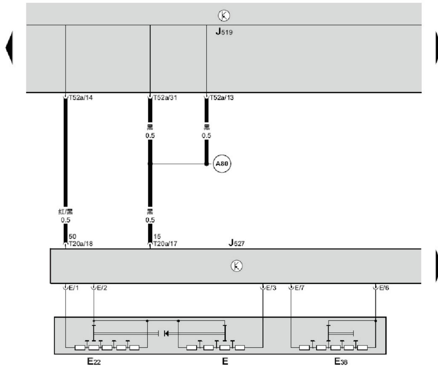
BCM 车身控制单元、转向柱电子装置控制单元、间歇式刮水器运行开关、车窗玻璃刮水器间歇运行调节器、车窗玻璃刮水器开关
