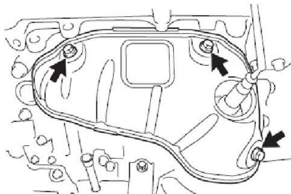
9). 拆卸左侧排气歧管分总成
