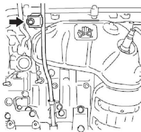
C). 从 2 号发动机机油油位计导管上拆下 O 形圈。
