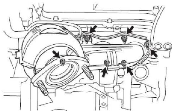
6). 拆卸 2 号发动机机油油位计导管
