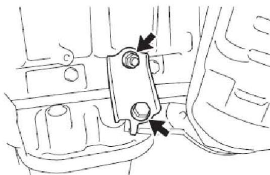
8). 拆卸排气歧管 2 号隔热罩
