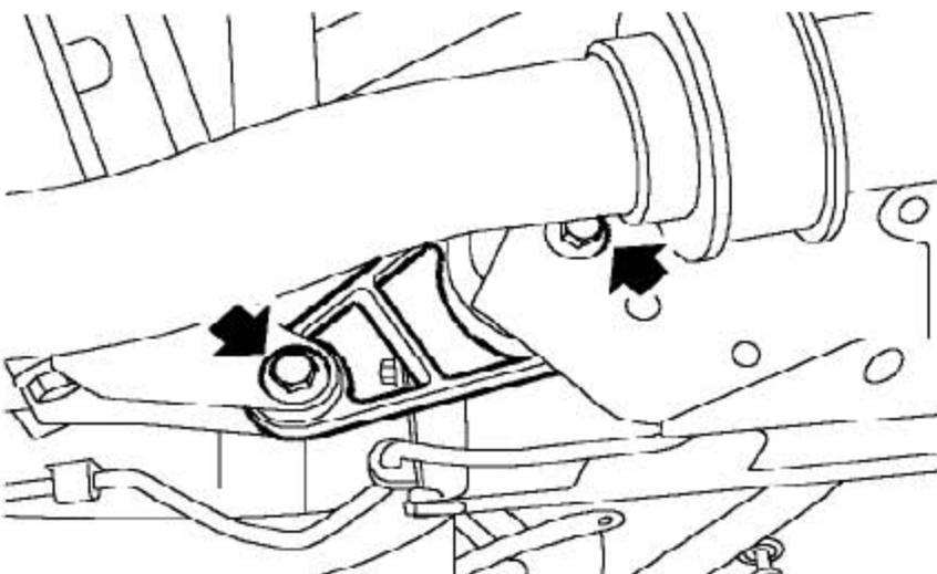
47). 拧下把发动机下后系杆固定到下前系杆和副车架上的2个螺栓，拿开下后系杆。
