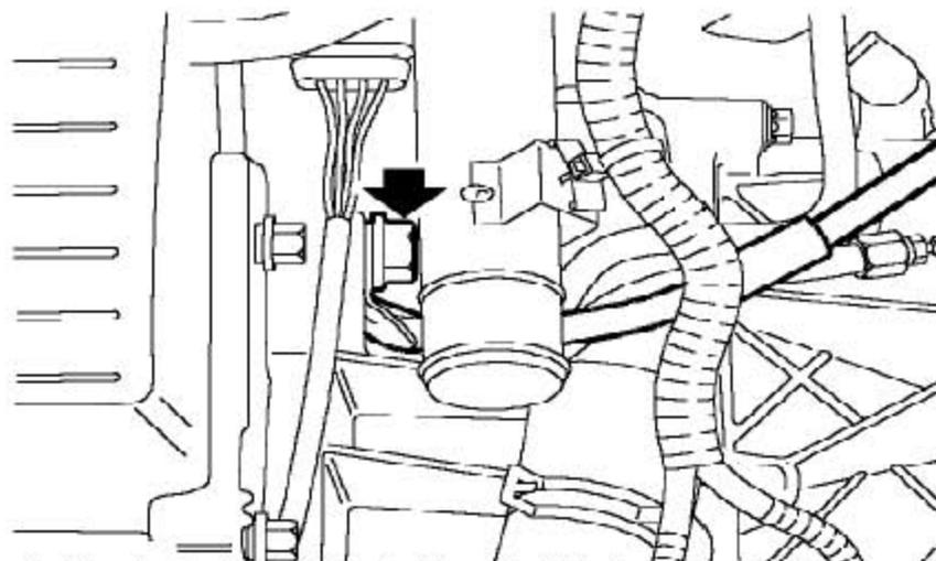
18). 拧下螺栓并从变速器上松开接地导线。
