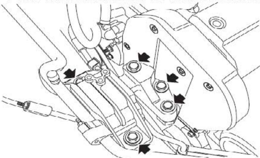
73). 拧下固定发动机右液压悬置到发动机的3个螺栓和到车身的2个螺栓，取下右液压悬置。
