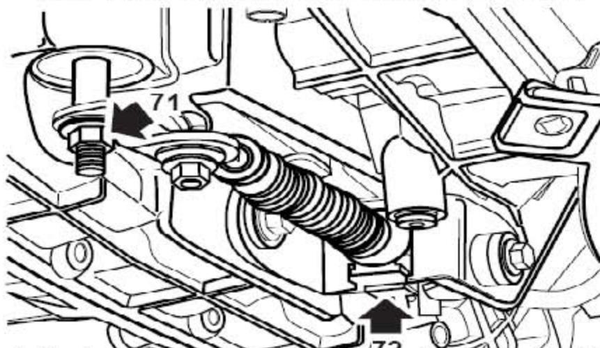
71). 拧下把换档杆固定到变速器上的螺母，从变速器上松开换档杆。
