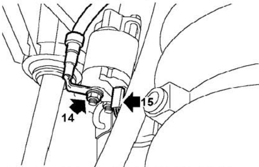
14). 拧下螺母并从起动电动机上断开蓄电池导线的连接。
