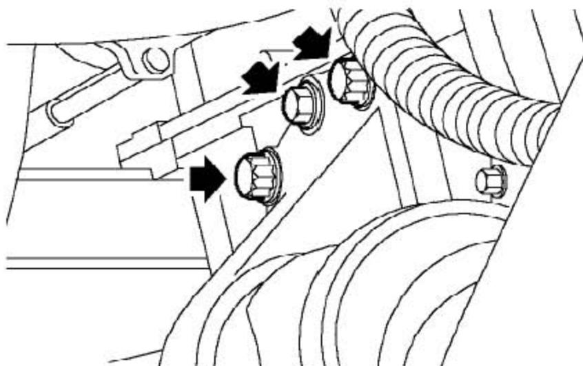
56). 拧下把中间轴轴承支撑固定到发动机上的3个螺栓。
