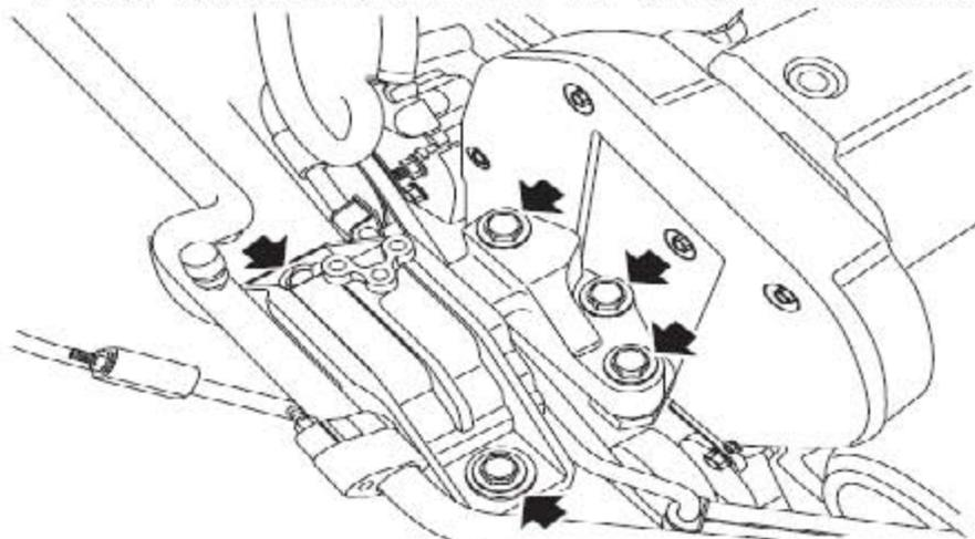
78). 拧下固定发动机右液压悬置到发动机上的3个螺栓和到车身的2个螺栓，并拿开液压悬置。
