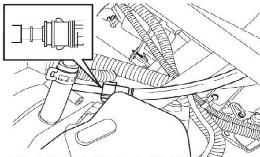
24). 松开夹箍并从燃油轨上断开软管的连接。
