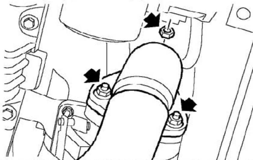
40). 拧下3个把前排气管法兰固定到涡轮增压器上的螺母，松开前排气管。
