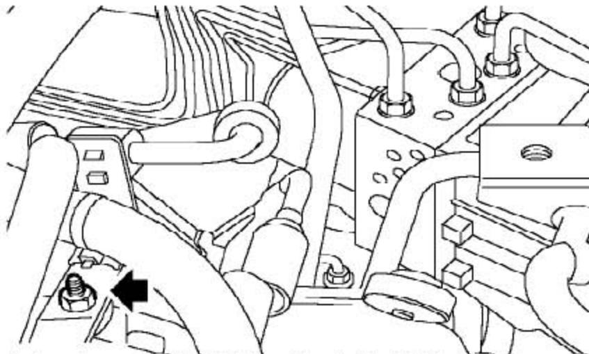
23). 拿开把PAS 软管支撑支架固定到冷却导管上的螺栓。
