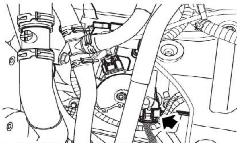
10). 断开变速器上起动机电磁阀的连接。
