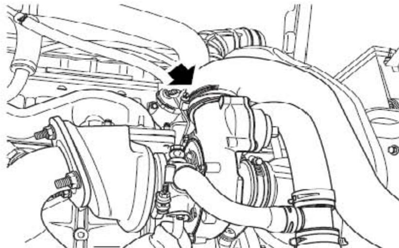
44). 松开把空气出气软管固定到涡轮增压器上的夹箍，并拿开软管。
