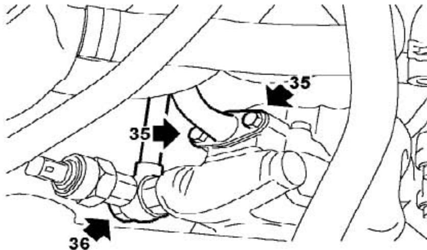
33). 拧下2个把进液软管固定到PAS泵上的螺栓，松开软管，取下O型圈并废弃。
