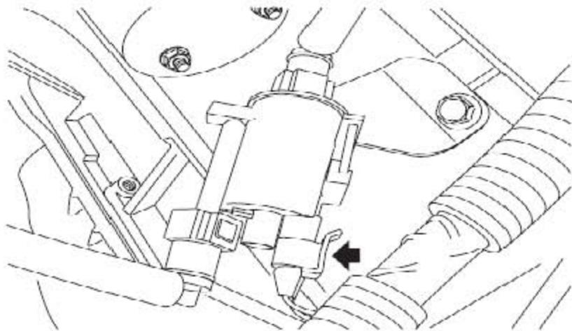
21). 断开炭罐控制阀连接器的连接。
