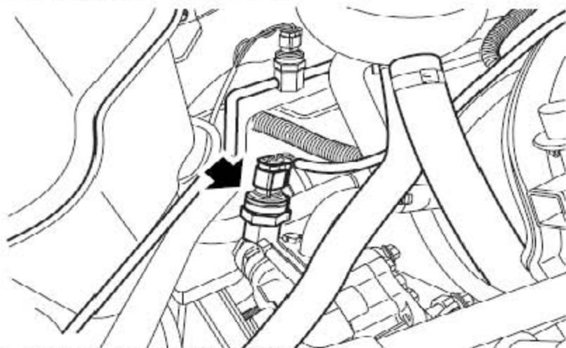
28). 断开PAS压力传感器连接器的连接。
