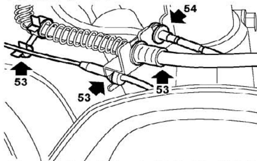
51). 取下固定右制动软管的夹子，从支撑支架上松开制动软管盒ABS 传感器线束上的夹子。松开制动蹄磨损传感器线束，从支撑支架上松开ABS 传感器线束。
