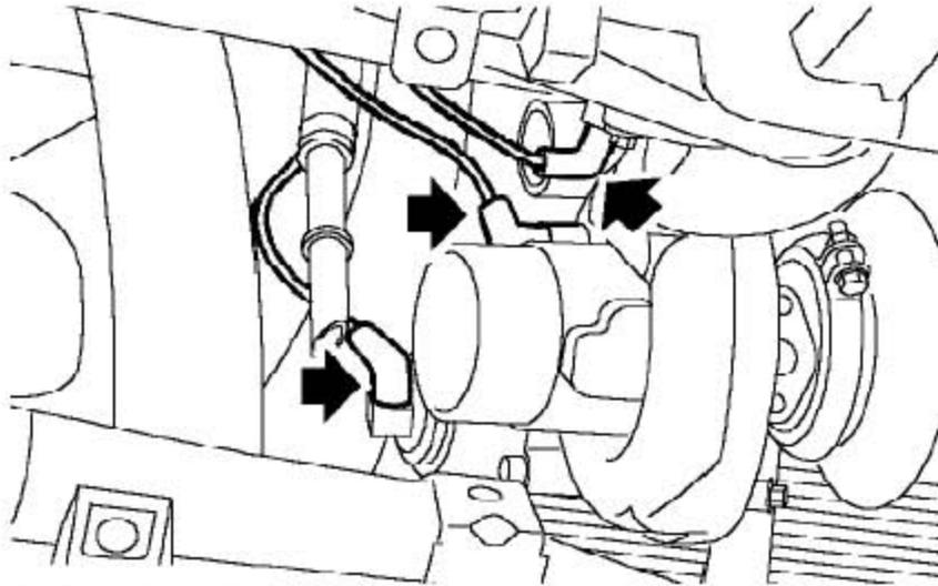
43). 从涡轮增压器和废气口处松开压力控制软管。
