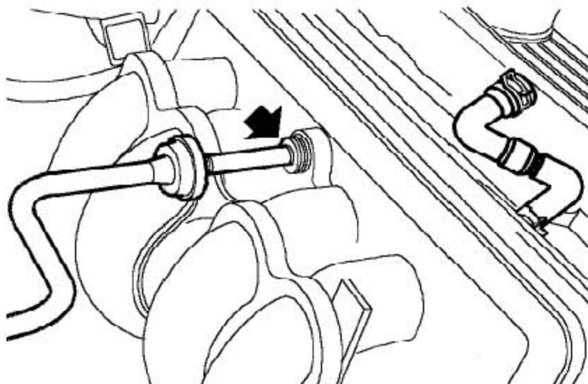
13). 从进气歧管上断开真空管的连接。
