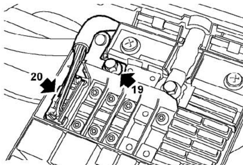
19). 拧下螺栓并从发动机舱保险丝盒上断开发动机接地导线的连接。
