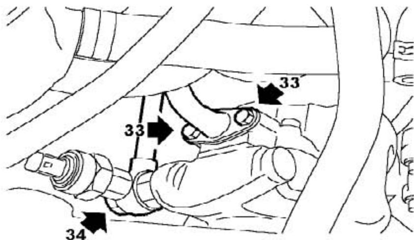
31). 拧下2个把进液软管固定到PAS泵上的螺栓。
