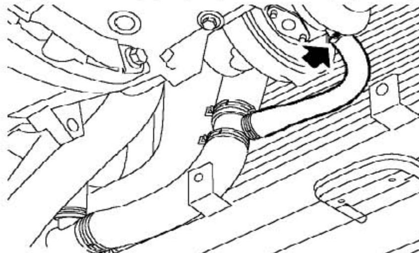
45). 松开把冷却液进液软管固定到增压器上的夹箍，并拆下软管。
