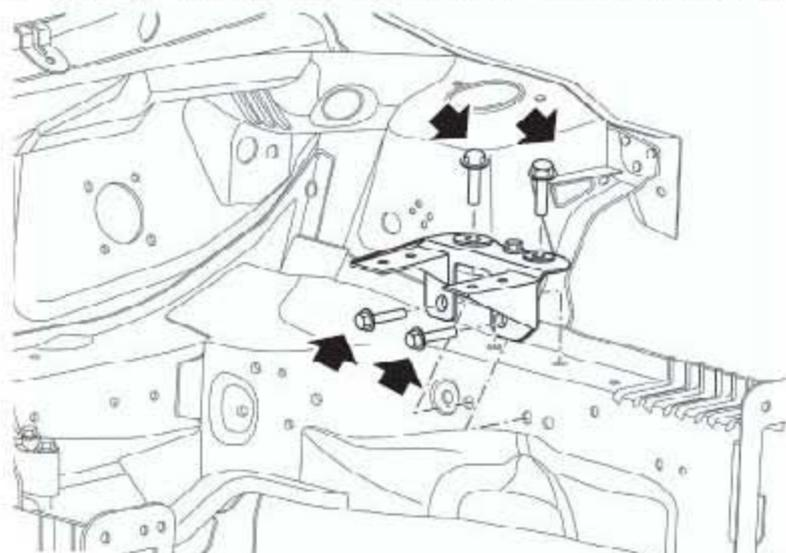
76). 拧下4个固定变速器左液压悬置支架到车身上的螺栓并拿开支架。
