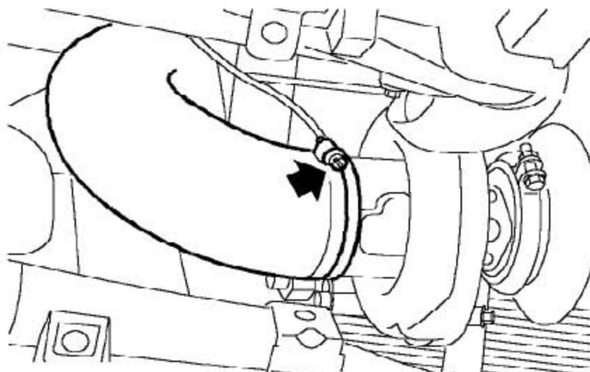
42). 松开把空气进气软管固定到涡轮增压器上的夹箍，并拿开软管。
