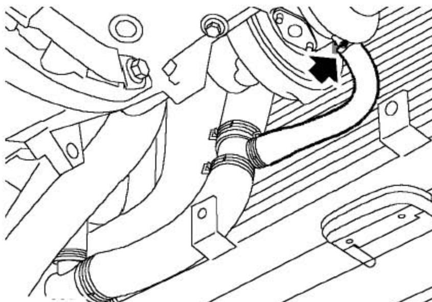
45). 松开把冷却液进液软管固定到增压器上的夹箍，并拆下软管。
