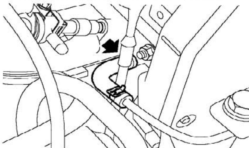
12). 松开把膨胀水箱软管连接到进气歧管上的夹箍，并断开软管的连接。
