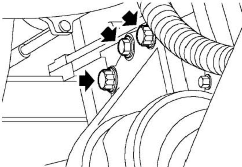
56). 拧下把中间轴轴承支撑固定到发动机上的3个螺栓。
