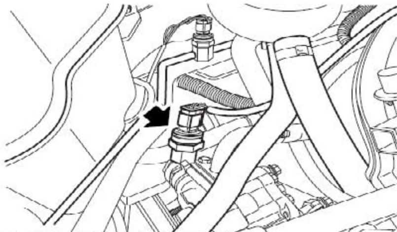
30). 断开PAS压力传感器连接器的连接。
