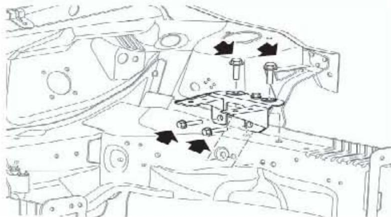
82). 拧下4个固定变速器左液压悬置支架到车身上的4个螺栓, 并拿开支架。
