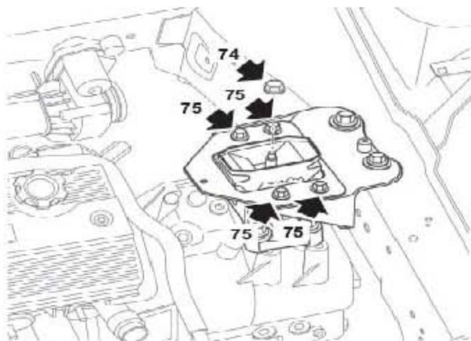
74). 拧下把变速器左安装支架固定到变速器左液压悬置支架的螺母。
