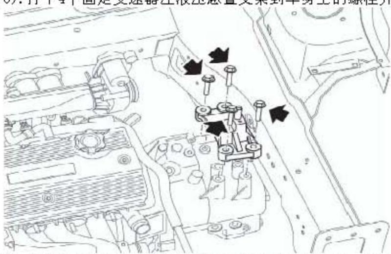
77). 拧下4个将变速器安装支架固定到变速器的螺栓，并拿开安装支架。
