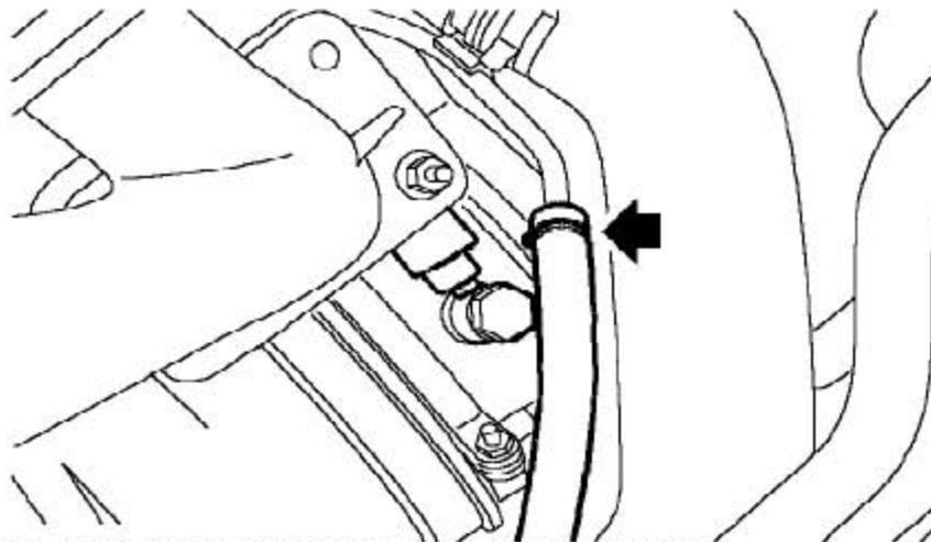
46). 松开夹箍并断开增压器冷却液回液管的连接。
