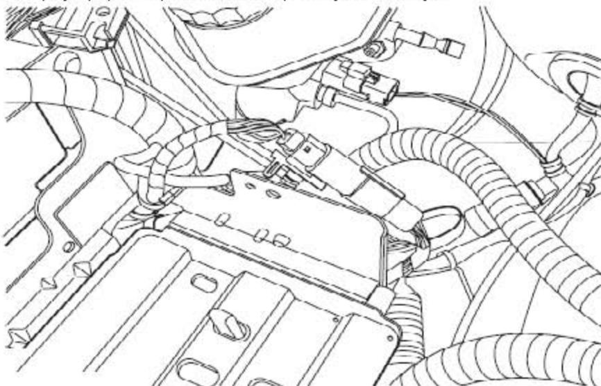
21). 断开发动机线束与发动机舱线束连接器的连接。
