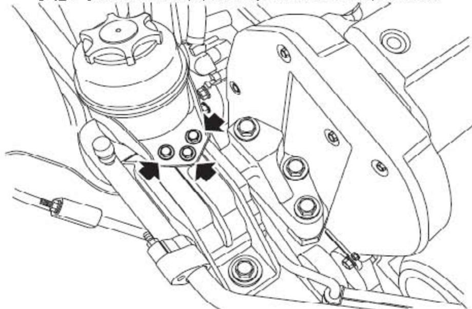
35). 拧下3个把PAS储液罐固定到防水壁上的螺母和1个螺栓，取下储液罐并放在旁边。
