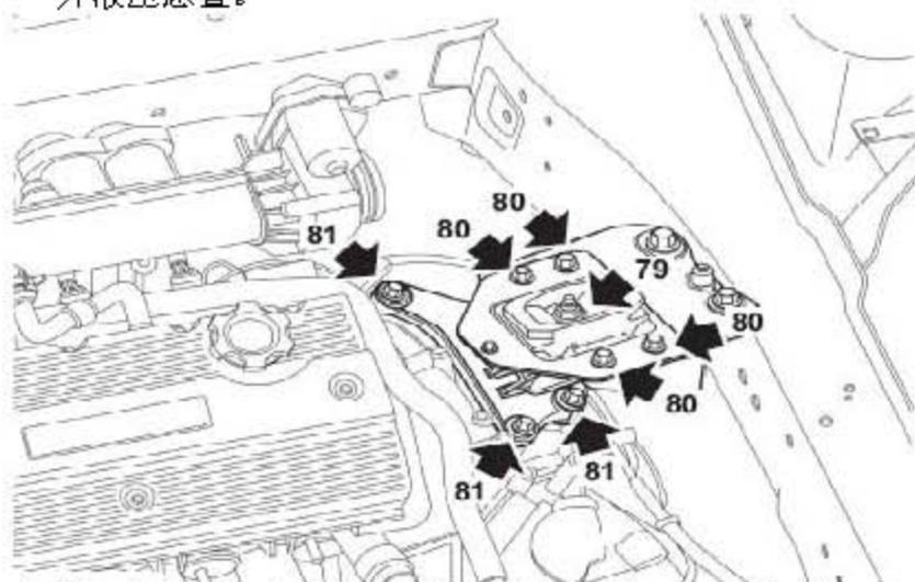
79). 拧下把变速器安装支架固定到变速器左液压悬置的螺母。
