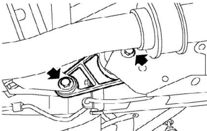
47). 拧下把发动机下后系杆固定到下前系杆和副车架上的2个螺栓，拿开下后系杆。
