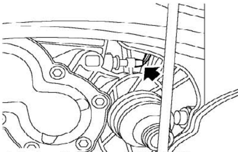
27). 松开夹子并断开倒档灯开关连接器的连接。
