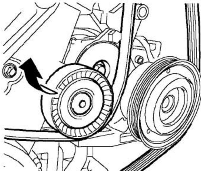
38). 用一13mm的扳手，转动张紧器以放松张紧力，把辅助传动带从空调压缩机皮带轮上拿开。
