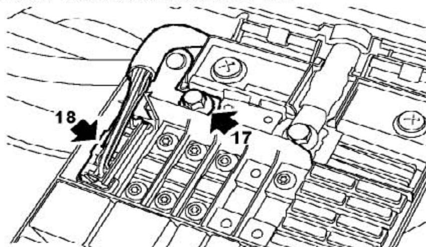
17). 拧下螺栓并从发动机舱保险丝盒上断开发动机接地导线的连接。
