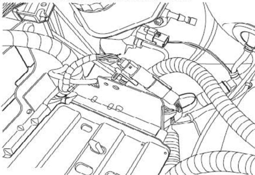
19). 从主线束连接器上断开发动机线束的连接。
