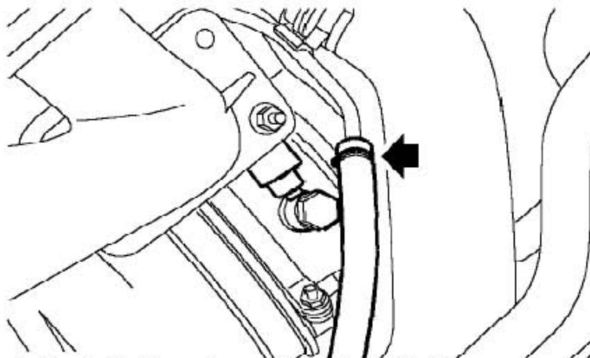
46). 松开夹箍并断开增压器冷却液回液管的连接。
