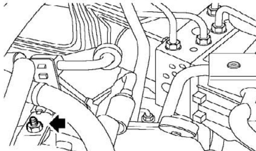
25). 拿开把PAS软管支撑支架固定到冷却导管上的螺栓。
