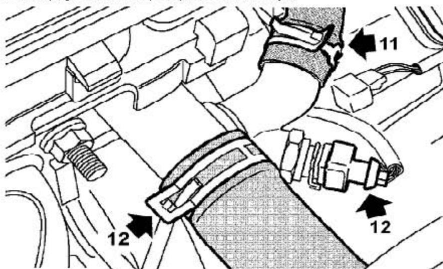
11). 松开把软管固定到冷却出口弯管接头的夹箍，并断开软管的连接。
