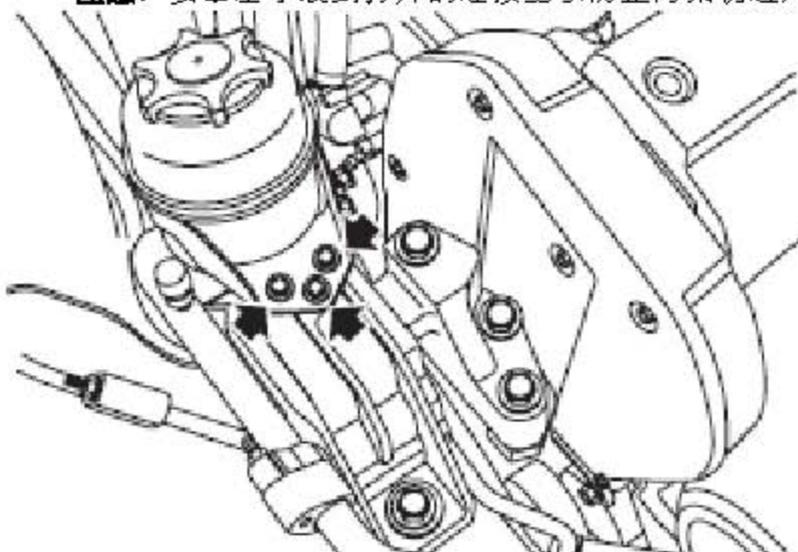
35). 拧下3个把PAS储液罐固定到发动机右液压悬置上的螺栓，取下储液罐并移到旁边。
