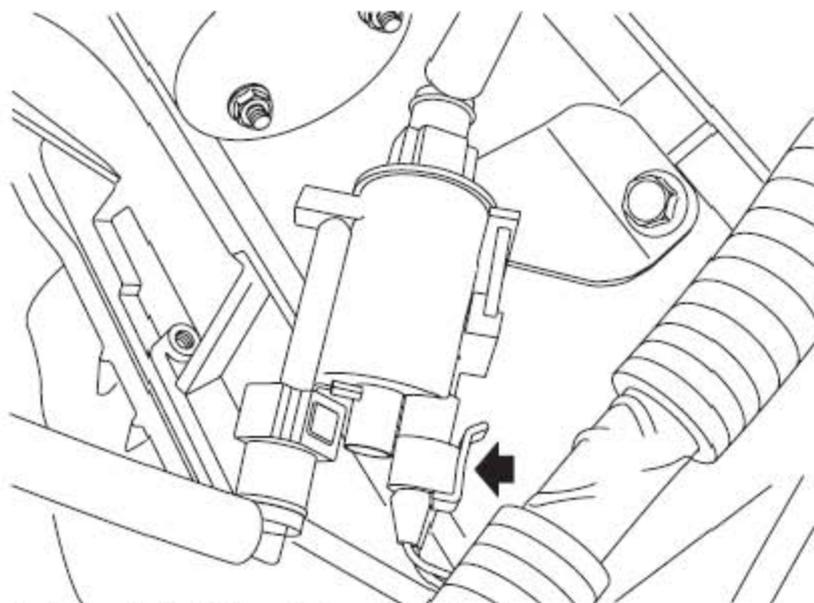
23). 断开炭罐控制阀连接器的连接。
