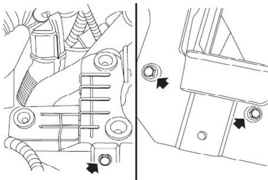
8). 拧下3个固定空气滤清器安装支架到车身上的螺栓并取下支架。
