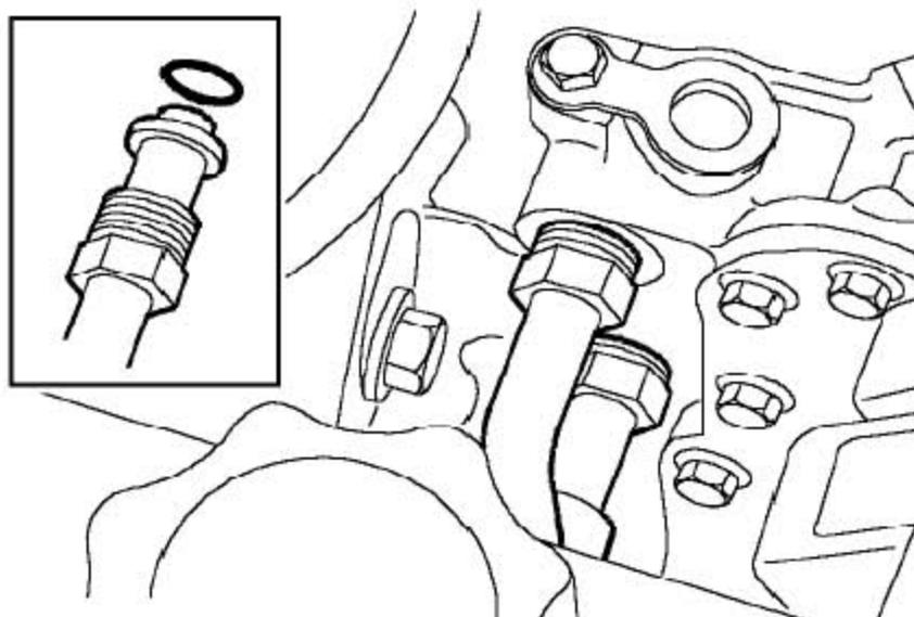
70). 松开并断开2个变速器液体冷却器软管的连接并废弃掉O型圈。
