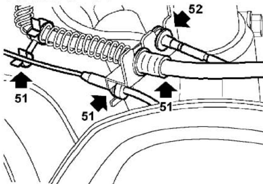
51). 取下固定右制动软管的夹子，从支撑支架上松开制动软管盒ABS传感器线束上的夹子。松开制动蹄磨损传感器线束，从支撑支架上松开ABS传感器线束。
