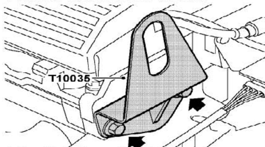
73). 拧下2个螺栓并拿开凸轮轴盖板。
