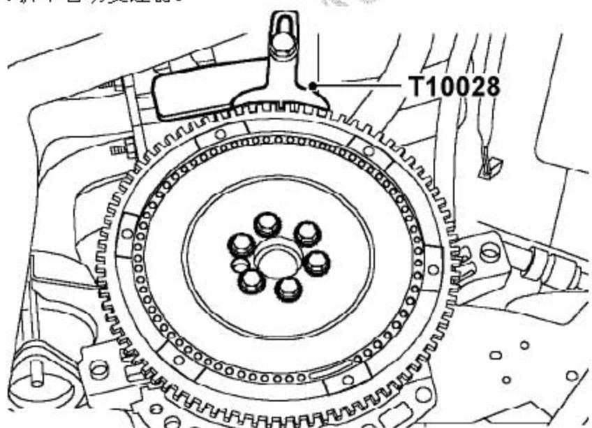
2). 把T10028固定到驱动盘齿圈上，并用螺栓固定在缸体上以限制曲轴。
