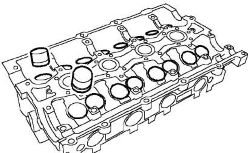
14). 从缸盖上取下16个挺柱，并按其安装顺序倒置存放以防止机油流失。
