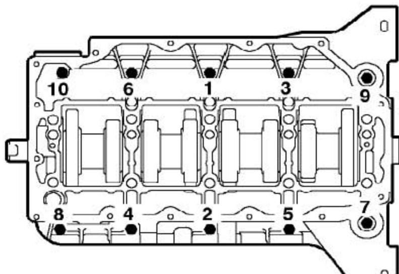
18). 用发动机机油润滑曲轴主轴瓦轴颈。把轴承座装到缸体上，装上螺栓并确保带凸缘头的螺栓安装到位置10上。
