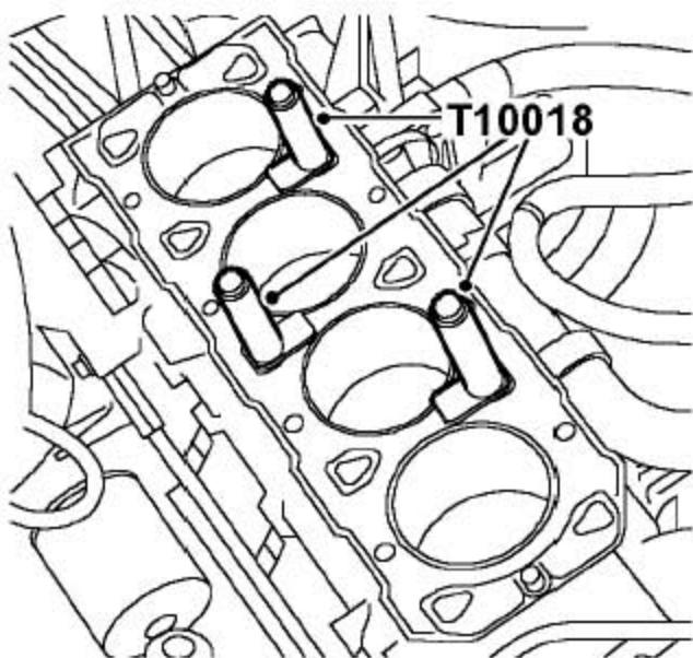
21). 装上 平缸夹T10018并用螺栓固定好。同时确保夹子的底部不突出到缸套的内径。
