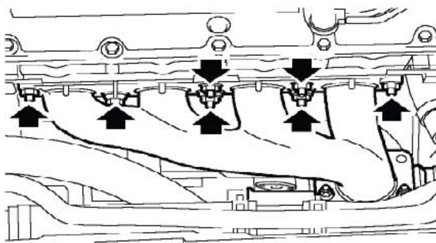
19). 把新的排气歧管衬垫装到缸盖上，装上歧管，装上螺母并按所示的顺序拧紧到45Nm。
