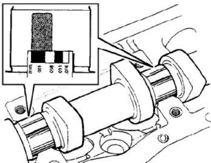
22). 测量每个轴颈上的塑料量规的最宽的部位。（参照“规格”）
