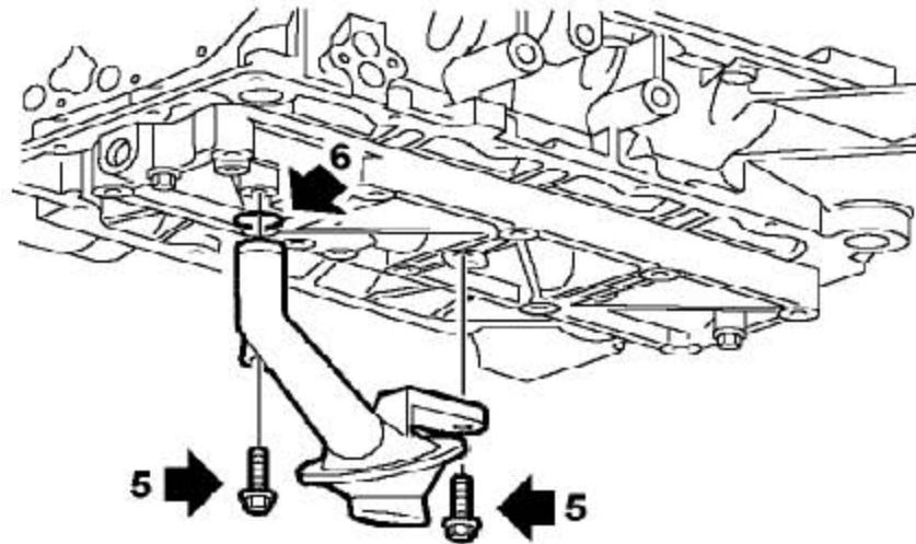
5). 拧下2个把机油集滤器固定到机油道的螺栓，拆下机油集滤器。
