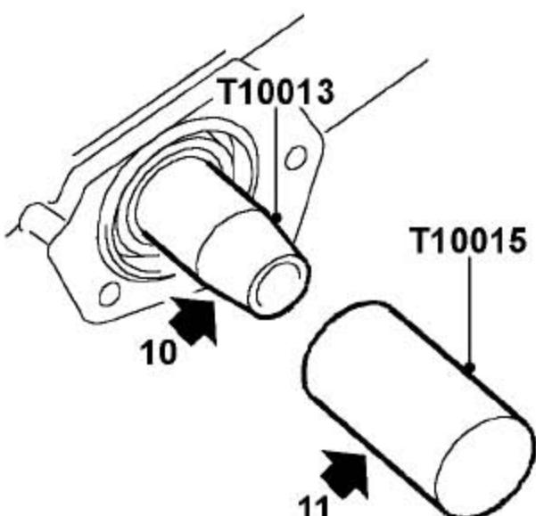
10). 把工具T10013装到凸轮轴端以保护密封。
