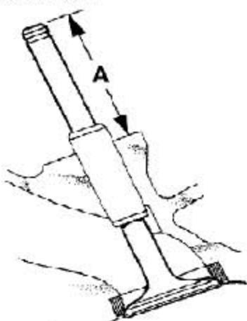
46). 检查气门杆的配合高度。（参照“规格”）
