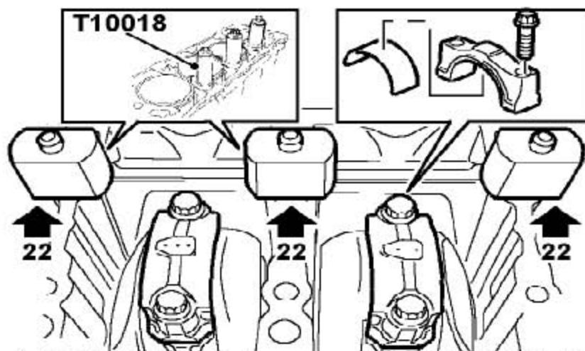
22). 用尼龙螺母固定平缸夹T10018。确保夹子的底部不会突到缸套口的内径。
