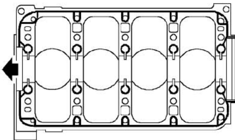
17). 如图所示在缸体路径上涂上连续的密封剂，部件号FLM90018A，然后用滚轮把密封剂抹成均匀的薄膜。
