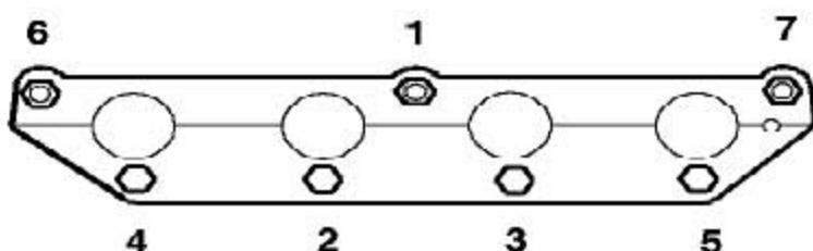
17). 把进气歧管装到缸盖上，装上7个螺母并拧紧，按所示的顺序拧紧至17Nm。
