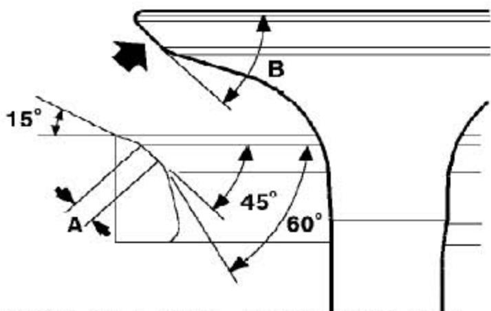
41). 要重新切削气门座的话，用导杆并配合以下切刀：
