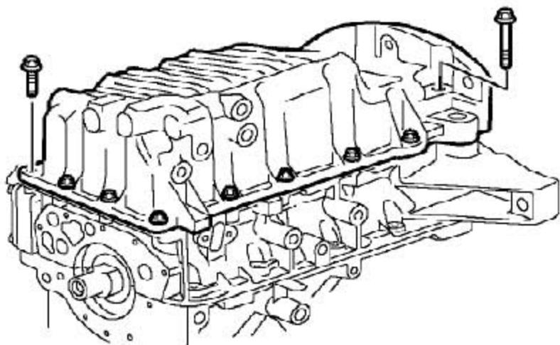
14). 注意安装好的2个最长螺栓的位置，拧下14个把油底壳固定到发动机轴承座上的螺栓。
