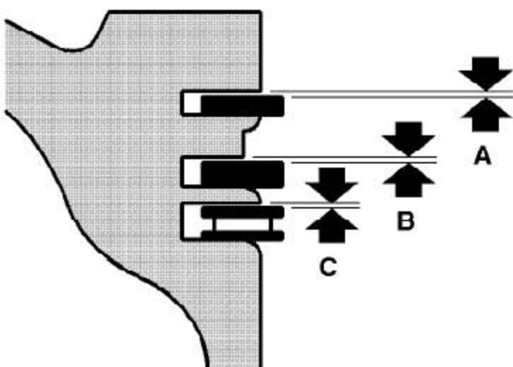
13). 检查新的活塞环至环槽的间隙。 (参照“规格” )
