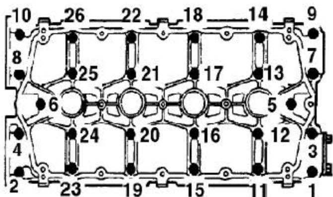
20). 再装上凸轮轴架，按顺序把螺栓拧紧到10Nm。不要转动凸轮轴。
