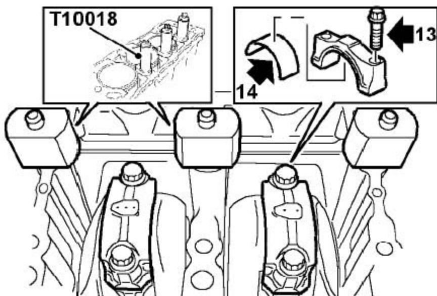
13). 按安装要求保持住把螺栓和连杆大头盖，拧下把连杆大头盖固定到连杆上的螺栓，并拿开连杆大头盖。
