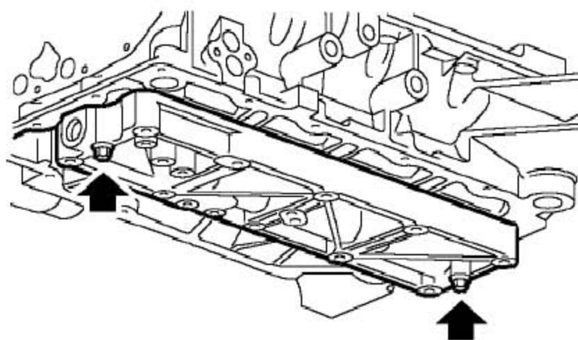
7). 拧下2个固定机油轨的螺母，拆下机油导管。
