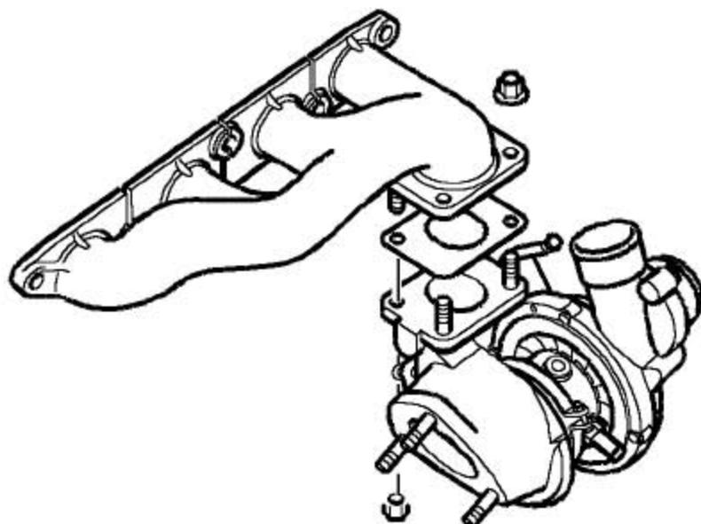
22). 拧下4个把涡轮增压器固定到歧管上的螺母，从涡轮增压器上松开排气歧管，拿开并废弃衬垫。
