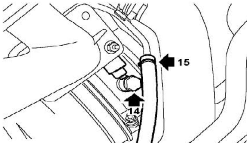
14). 取下把机油进油管固定到涡轮增压器上的螺栓和2个垫圈。
