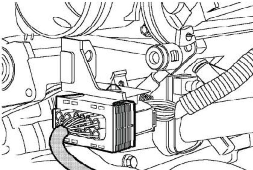
13). 从支架上松开喷嘴线束连接器，并断开连接器的连接。
