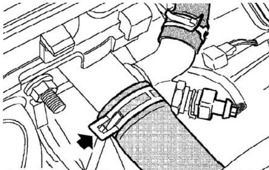
19). 松开把冷却液软管固定到发动机弯管接头上的弹簧挡圈，松开软管并固定到旁边。
