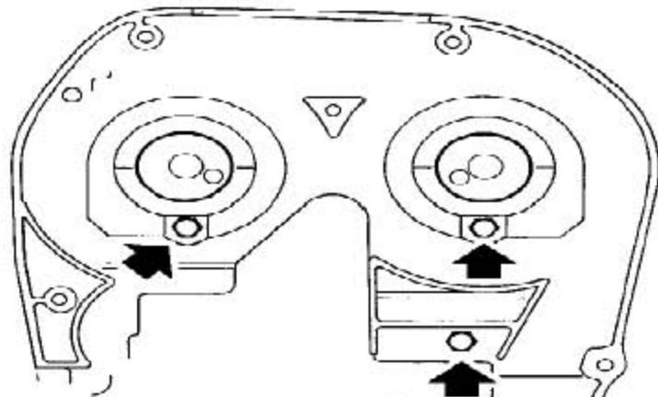
8). 拧下把正时带后上盖固定到发动机上的螺栓，拿开盖子。
