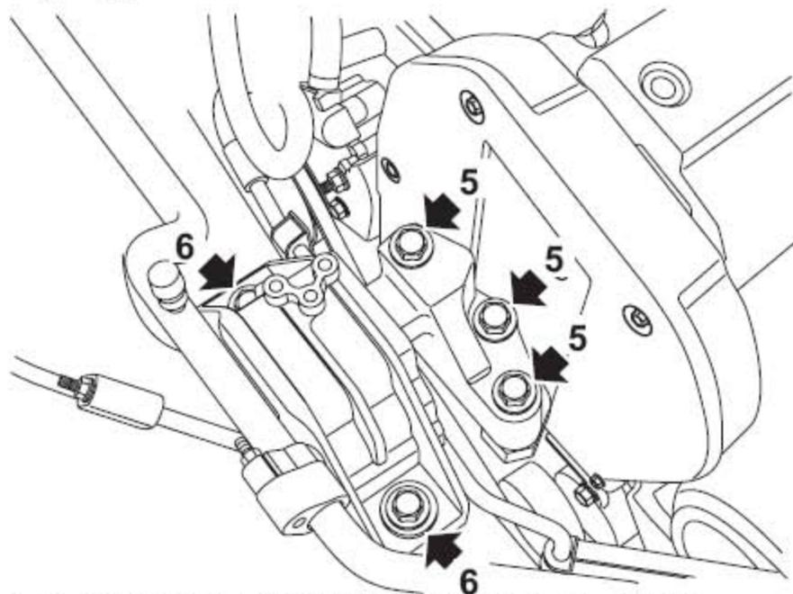
5). 拧下把发动机右液压悬置固定到发动机上的3个螺栓。
