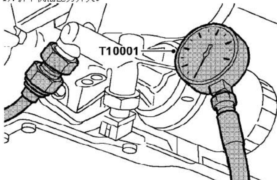
2). 从机油压力开关上取下密封圈，装到机油压力表接头上。
