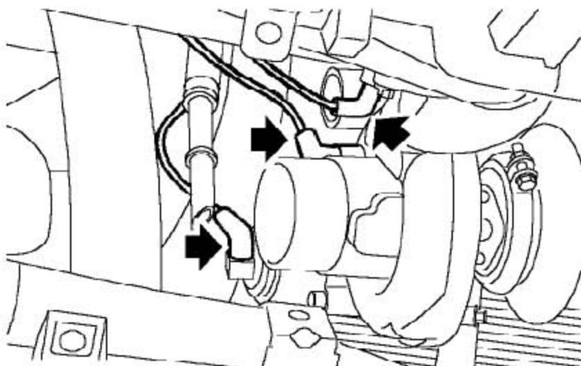
10). 从涡轮增压器和废气口处松开压力控制软管。
