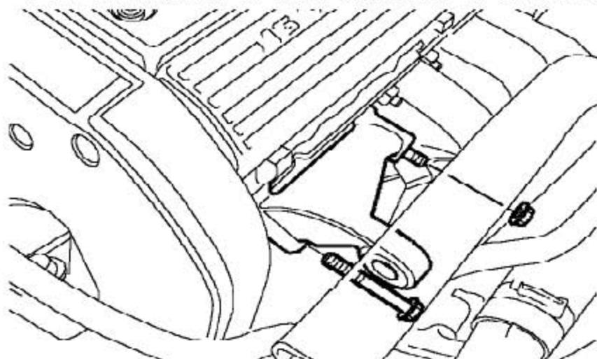
17). 拧下把发电机上支架固定到发动机上的螺母和螺栓并拿开支架。
