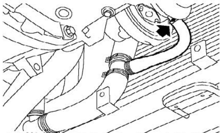
12). 松开把冷却液进液软管固定到涡轮增压器上的夹箍并拿开软管。
