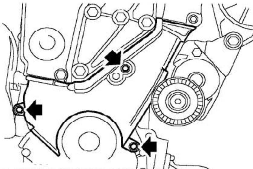
13). 拧下3个螺钉并取下正时带前下盖和密封。
