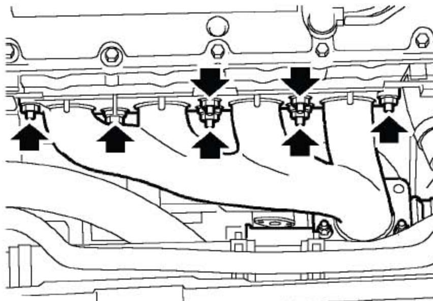
20). 拧下7个把排气歧管固定到发动机上的螺母。
