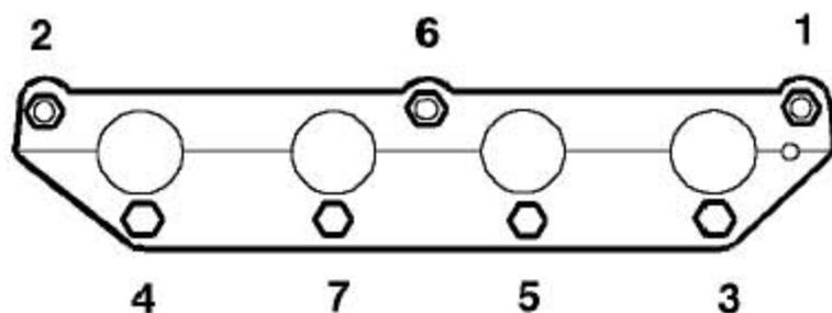
18). 按所示的顺序，渐次把进气歧管固定到缸盖的7个螺母上。
