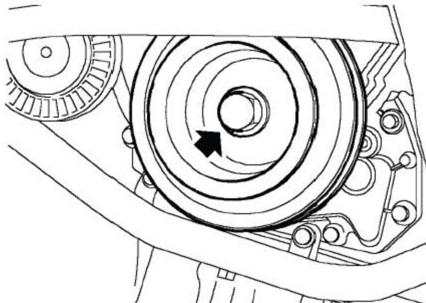
7). 取下固定皮带轮到曲轴上的螺栓和垫圈。
