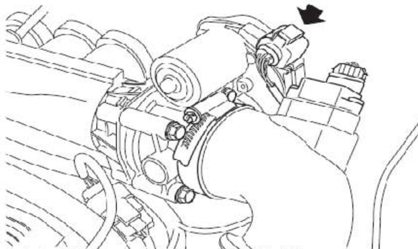
5). 从电子节气门传感器上断开连接器的连接。
