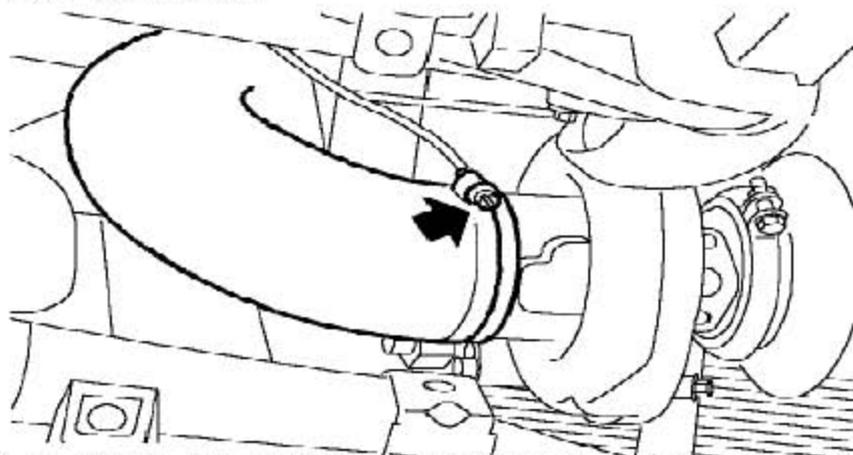
9). 松开把空气进气软管固定到涡轮增压器上的夹箍并拿开软管。
