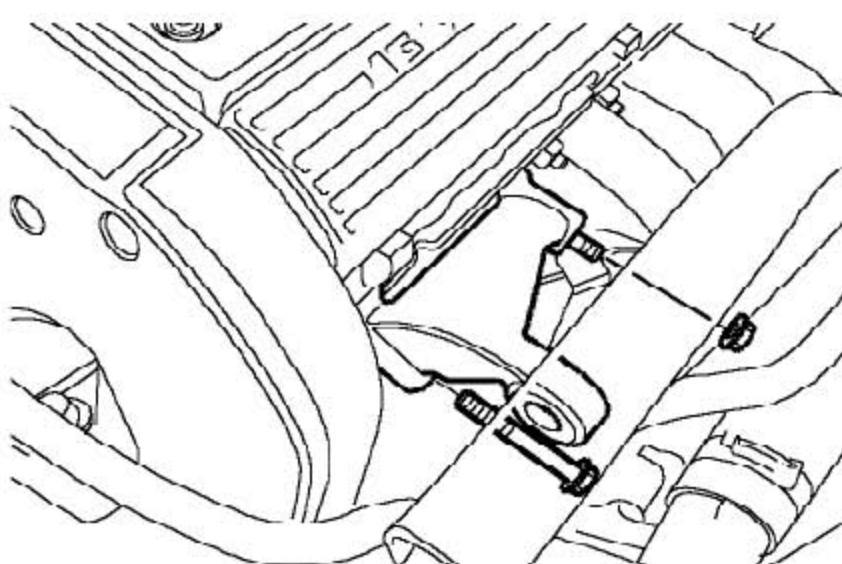
4). 拧下固定隔热板到发电机上支架的螺母和固定上支架到缸盖的螺母和螺栓。
