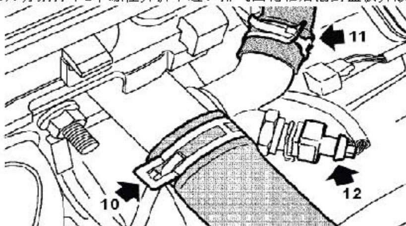
10). 松开夹箍，并从冷却液出口弯接头处断开散热器顶部软管。
