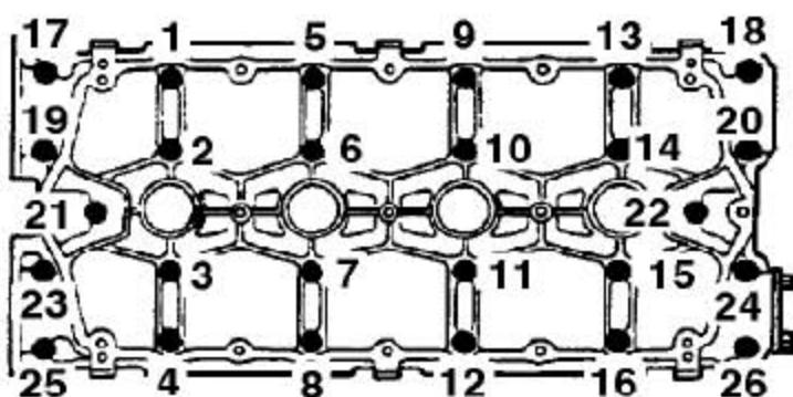
9). 按所示的顺序，渐次松开把凸轮轴架固定到缸盖上的26个螺栓，直到气门弹簧的压力全部释放。
