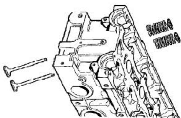
16). 取下气门弹簧，气门弹簧盖和气门。
