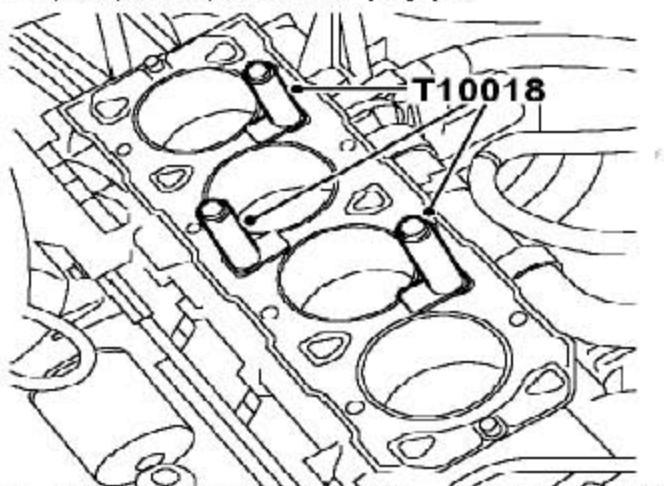
19). 把平缸夹T10018装到缸体上，用缸盖螺栓固定，要保证夹子的边缘不会突出到缸套的内径。
