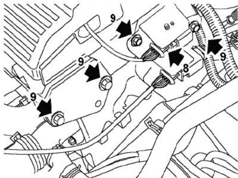
8). 从发动机线束上断开点火线圈和凸轮轴传感器线束连接器的连接。
