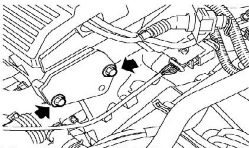
3). 拧下2个把排气凸轮轴后油封盖板固定到缸盖上的螺栓并拿开盖板。
