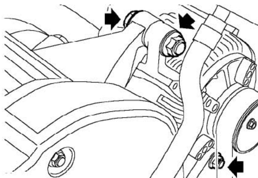
3). 拧下发电机的上下螺栓，并取下发电机。
