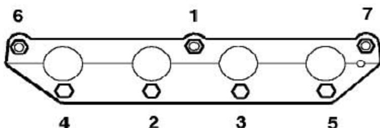
29). 固定进气歧管，装上7个螺母，按所示的顺序拧紧至17Nm。
