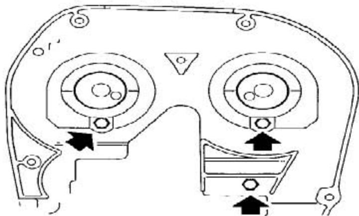
15). 拧下把正时带后上盖固定到发动机上的螺栓。
