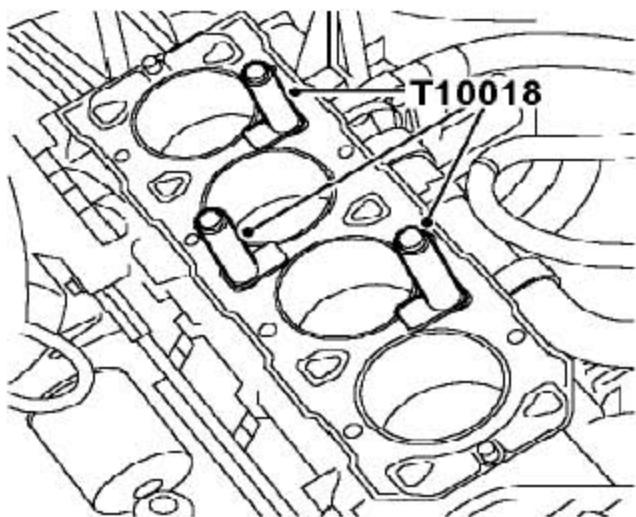
35). 把平缸夹T10018装到缸体上并用缸盖螺栓固定。确保平缸夹的底部没有突到缸套口的内径。
