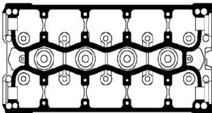
6). 在如图所示的凸轮轴架路径上涂上2mm的密封剂，部件号为FLM90017A，然后用滚轮把密封剂涂成均匀的薄膜。
