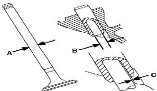
2). 检查现有的气门杆的直径。用新的气门检查气门导管的间隙。(参照“规格”)
