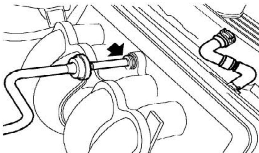
20). 松开快松接头上的塑料边圈，从进气歧管上断开制动伺服真空软管。
