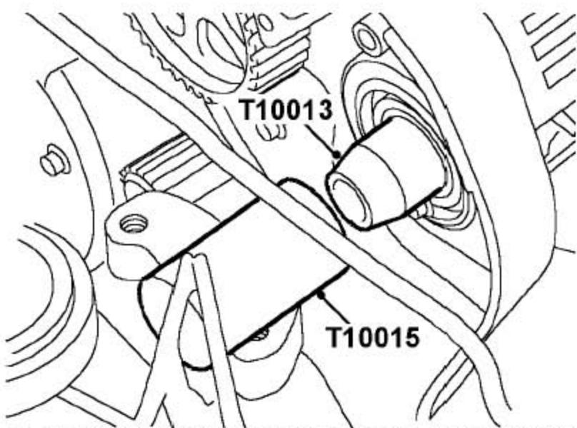
3). 注意此油封为黑色，用工具T10015装上新的凸轮轴油封。
