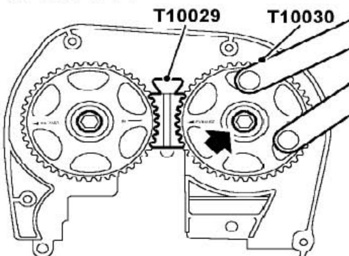
3). 从凸轮轴带轮上取下凸轮轴带轮锁止工具T10029。
