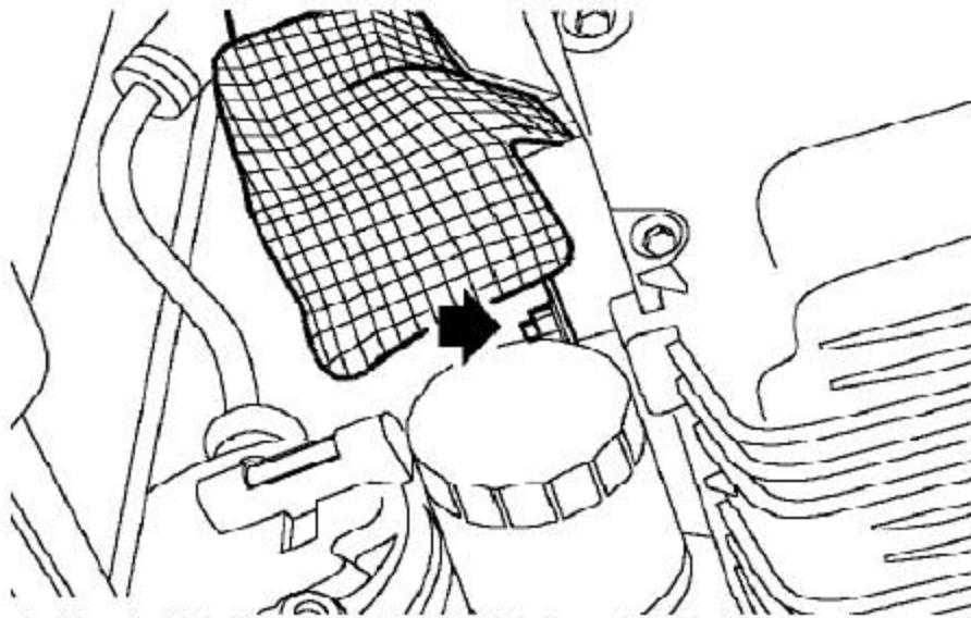
6). 拧下把发电机隔热板固定到发电机下支架上的螺栓并取下隔热板。
