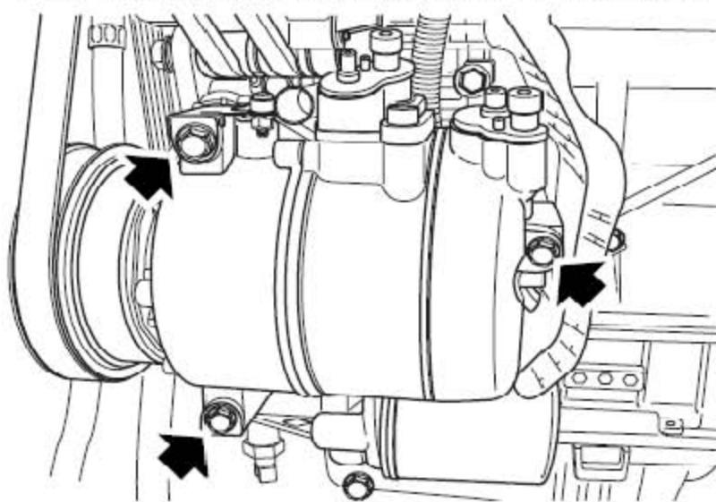
5). 拧下把空调压缩机固定到发电机下支架的3个螺栓，并拆下压缩机。
