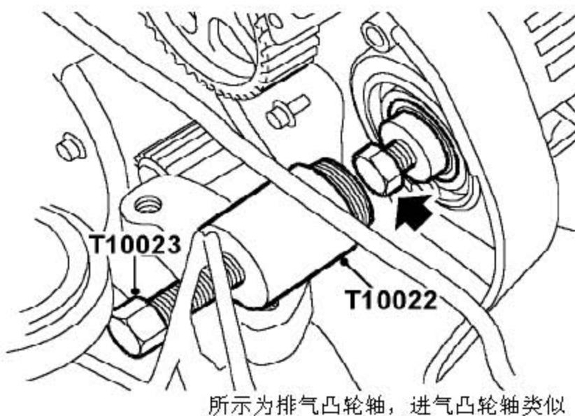
6). 把固定凸轮轴带轮的螺栓装到凸轮轴上。
