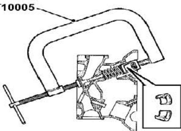
13). 用工具T10005压缩气门弹簧。
