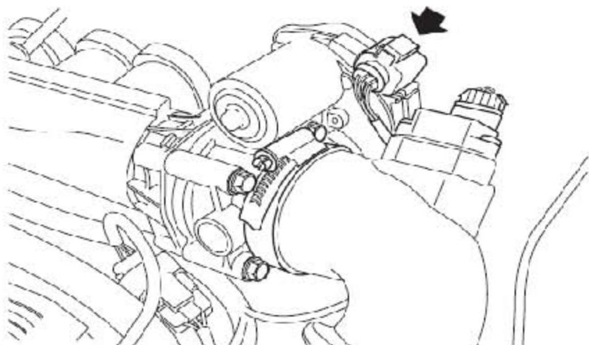
14). 从电子节气门传感器上断开连接器的连接。
