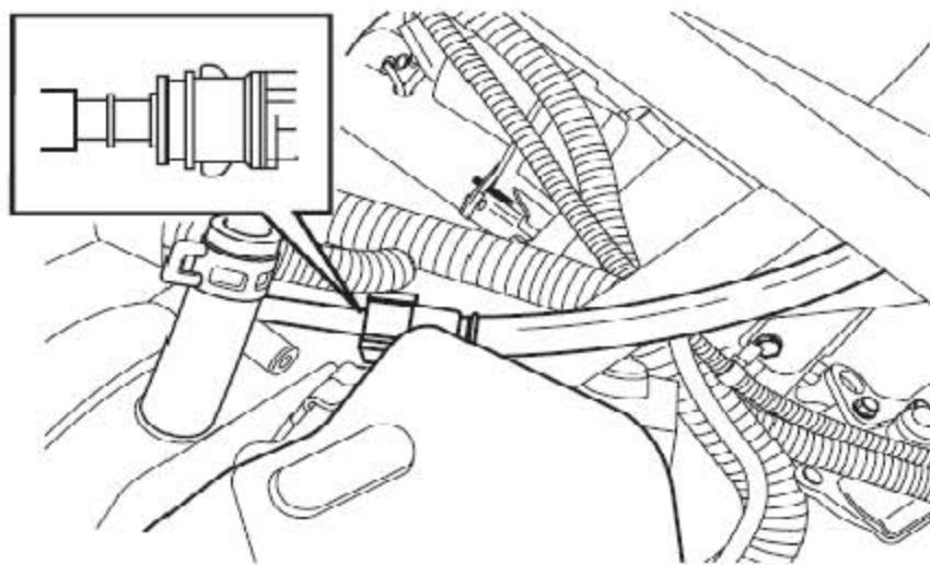
18). 压下供油管的塑料边圈，从燃油轨上松开供油管。
