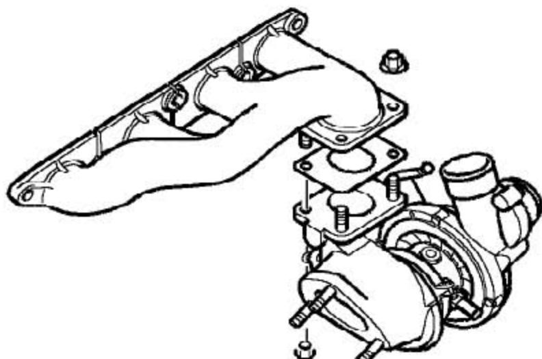
6). 拧下4个把排气歧管固定到涡轮增压器上的螺母。
