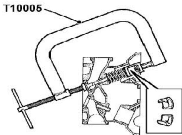
15). 装上气门。装上弹簧和弹簧盖，把T10005固定到气门和压缩弹簧上。
