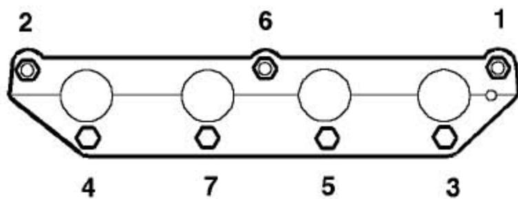
7). 按所示的顺序，渐次松开把进气岐管固定到缸盖上的7个螺母。
