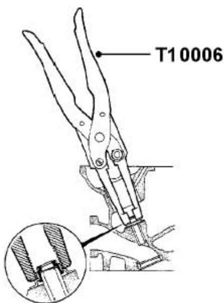
14). 用T10006把气门杆油封装到气门导管上。
