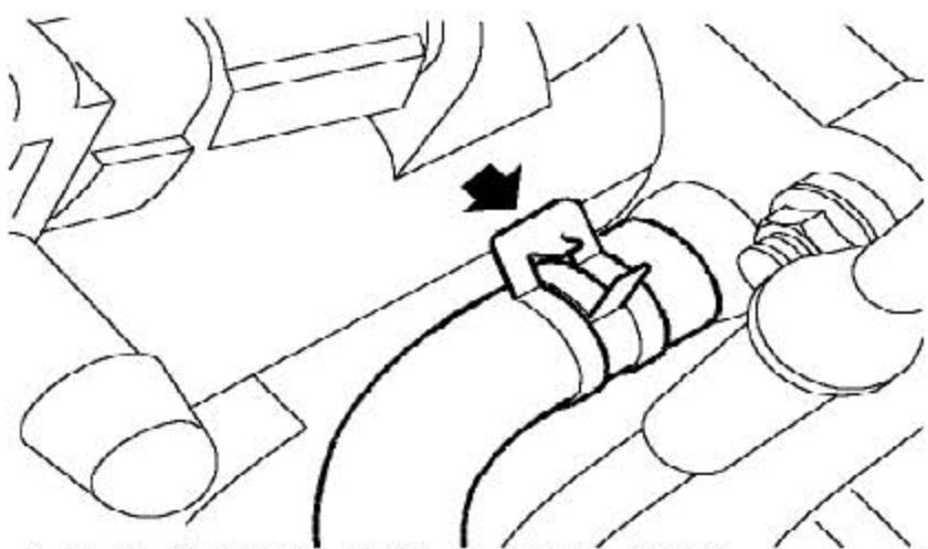
21). 松开夹箍并从进气歧管上断开膨胀水箱软管。
