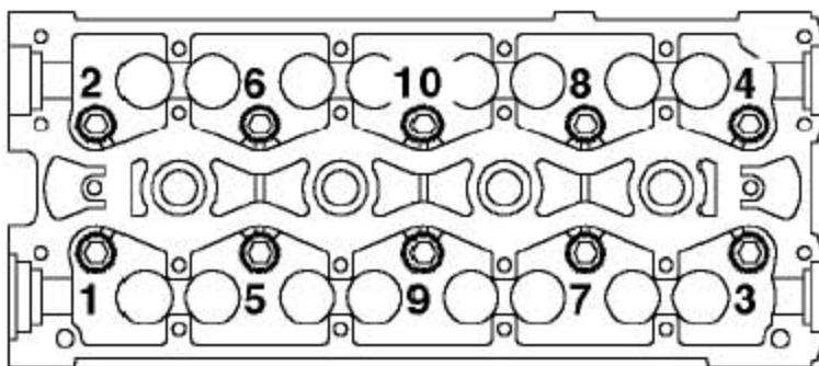
7). 按所示的顺序，充分松开缸盖上的螺栓1至6，拿开螺栓并按安装顺序放好。
