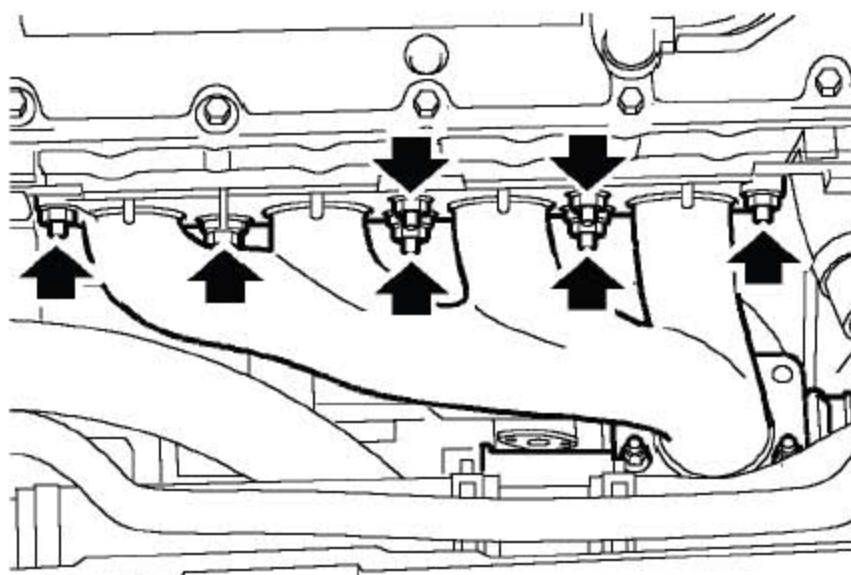
3). 按所示的顺序，拧下7个把排气歧管固定到缸盖上的螺母。
