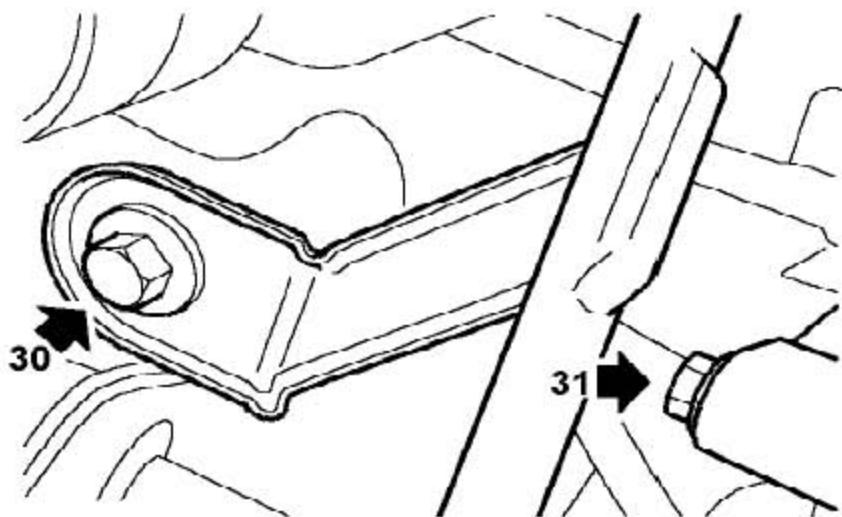
30). 拧下固定油标尺管支架的螺栓。
