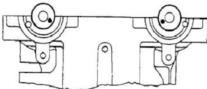
5). 装上凸轮轴并固定进气驱动销于4点（120度）的位置，把排气凸轮轴驱动销固定于8点（240度）的位置。
