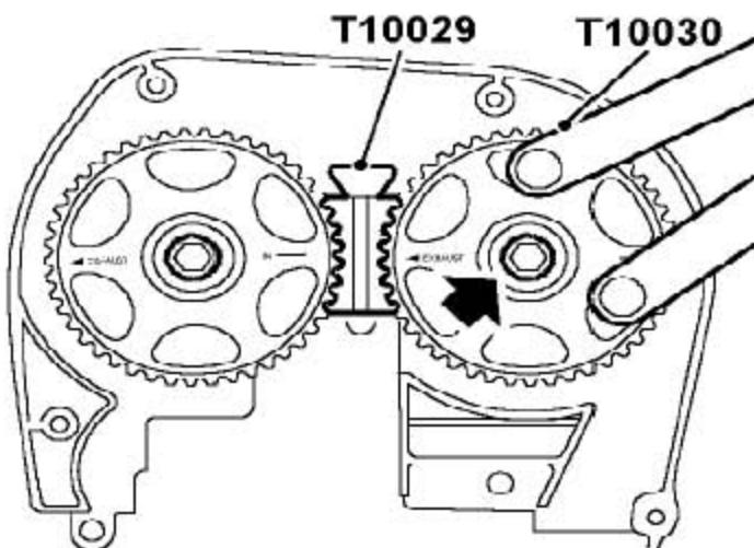
5). 把凸轮轴带轮装到凸轮轴上，确保驱动销定位在带轮的正确的切槽中。装上平垫圈和螺栓，用工具T10030固定住带轮并将螺栓拧紧至65Nm。
