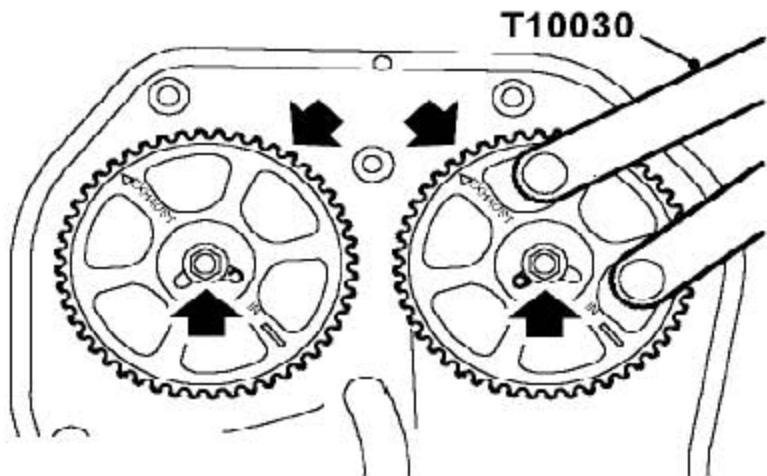
15). 给凸轮轴装上凸轮轴带轮，确保正时标记对准，并将驱动销置于正确的带轮切槽。
