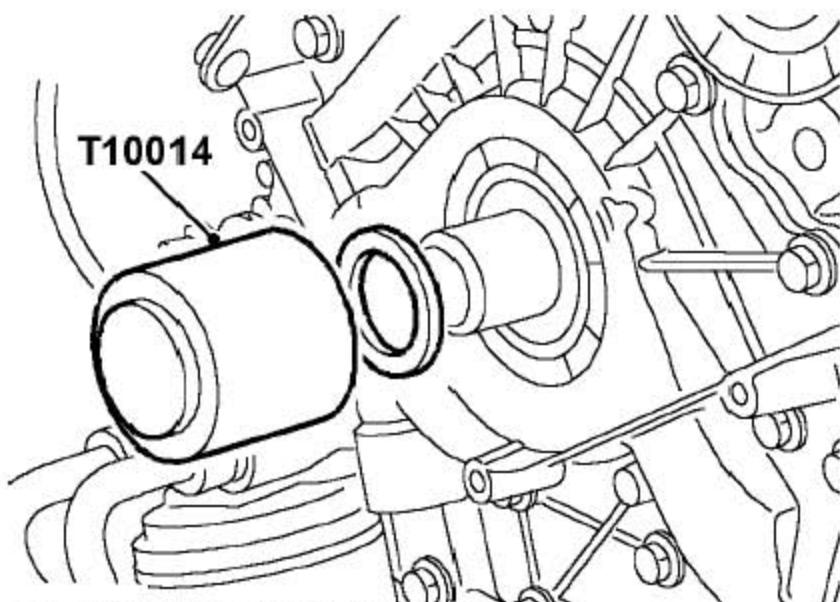
23). 把密封成套工具的油封套装到曲轴上。
