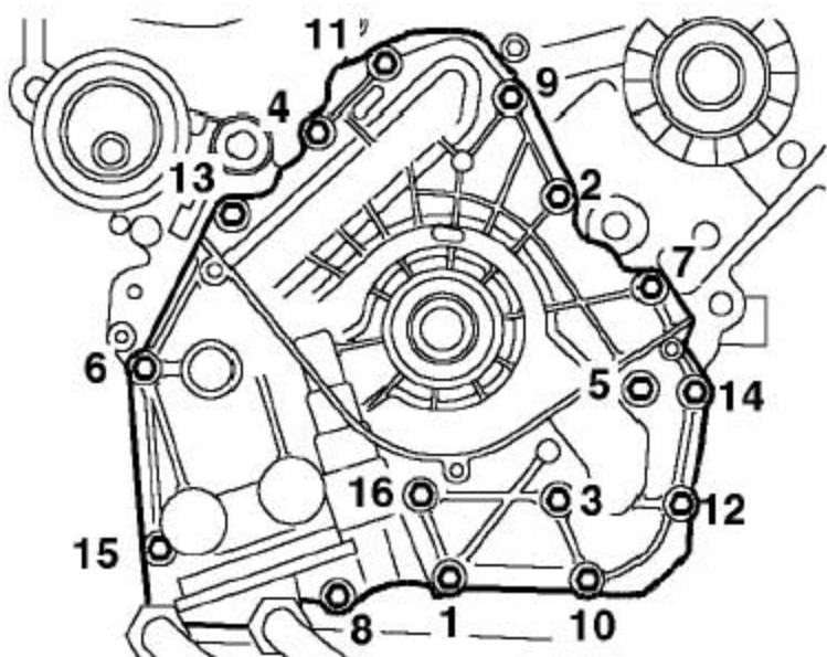
22). 装上新的固定机油泵到缸体上的Patchlok螺栓，并按图所示的顺序，拧紧到25Nm。
