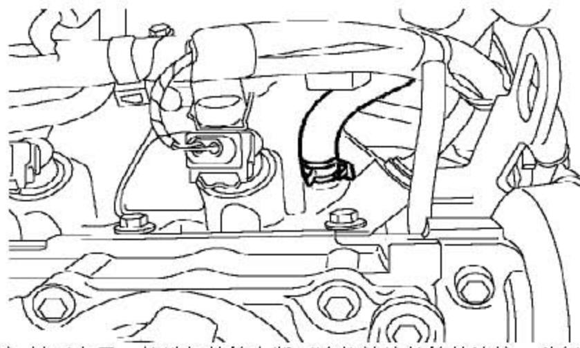
14). 松开夹子，从进气歧管上断开冷却放液软管的连接，并把软管放到旁边。
