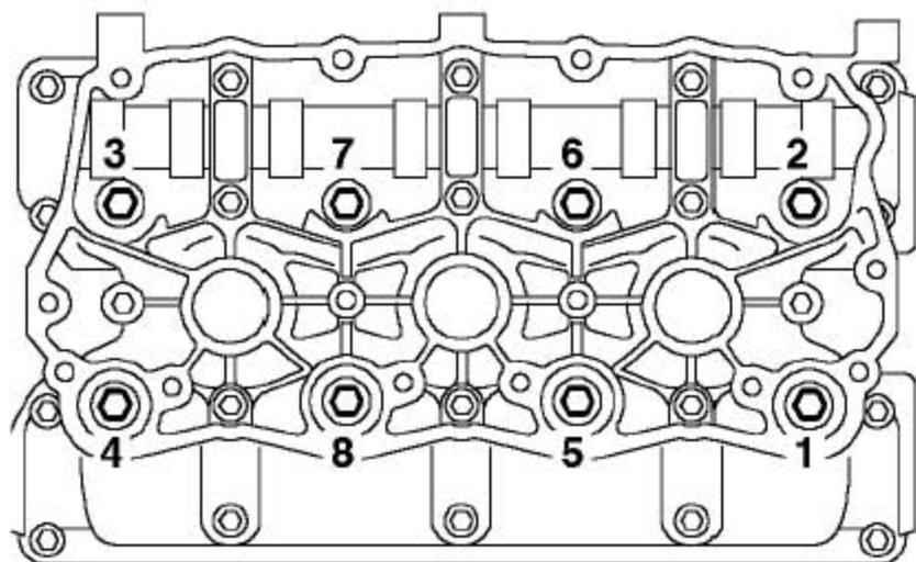
23). 按图示的顺序，渐次松开并取下8个缸盖螺栓。
