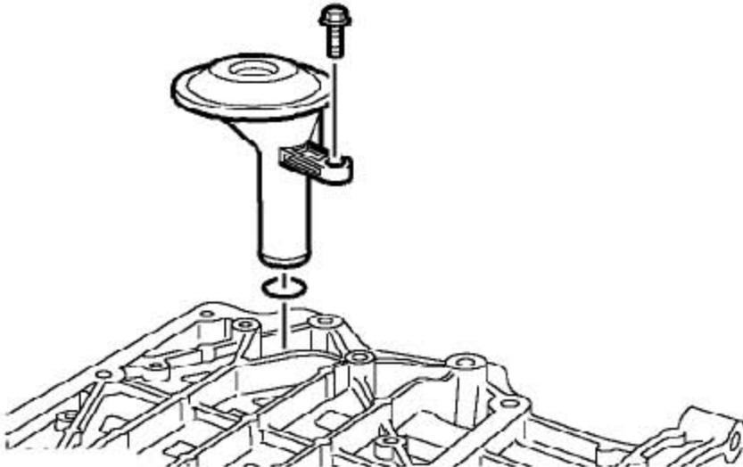
12). 拆下固定集滤器的螺栓，从集滤器上取下O形圈并废弃。
