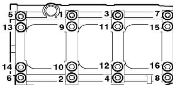
12). 装上新的螺栓，按主轴承座上所示的顺序拧紧到20Nm。然后按顺序，再拧90°。
