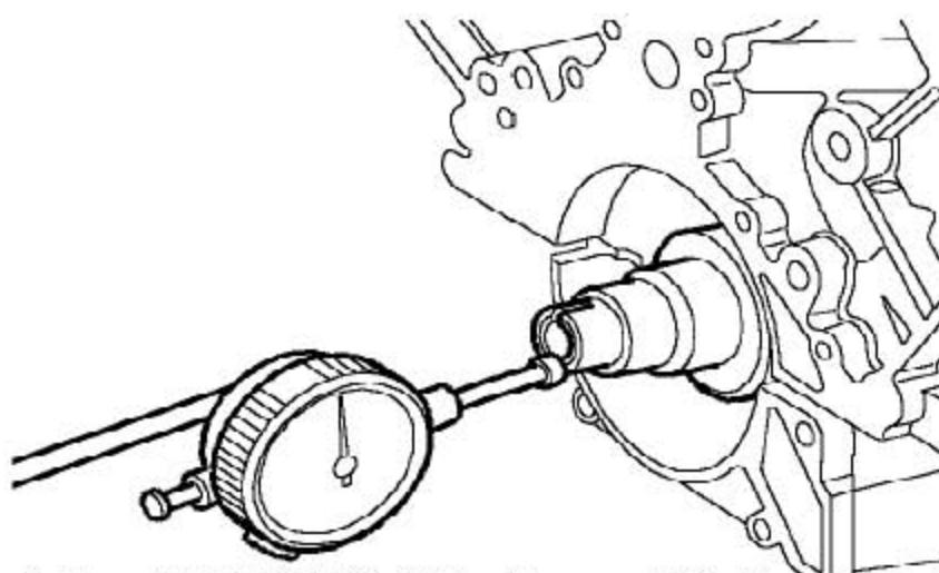
12). 用DTI检查曲轴的轴向间隙。从DTI 一侧推开曲轴，使DTI调零，朝表盘方向推曲轴。
