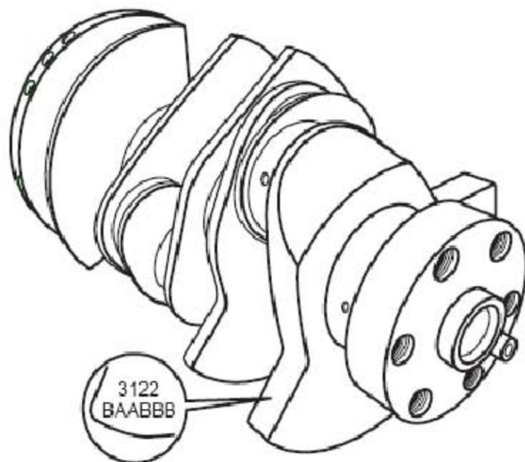
22). 从曲轴后平衡块外侧面读取主轴颈和连杆轴颈的直径尺寸分组代码。上层为主轴颈等级，分1, 2, 3 三等，从左向右读，第一个代码为第一主轴颈的直径等级，共四位数字。下层为连杆轴颈等级，分A、B、C 三等，从左向右读，第一个代码为第一连杆轴颈的直径等级，共六个字母。
