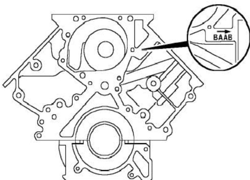
21). 主轴瓦 - 选择：从缸体的前面，记录下主轴承孔的代码字母。主轴承孔分A、B、C 三个等级。从左向右读取，第一个字母对应第1个（前）主轴承孔代码。
