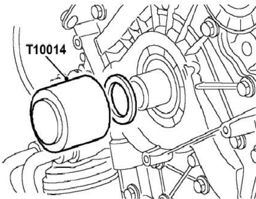
29). 把密封成套工具的油封导套装到曲轴上。
