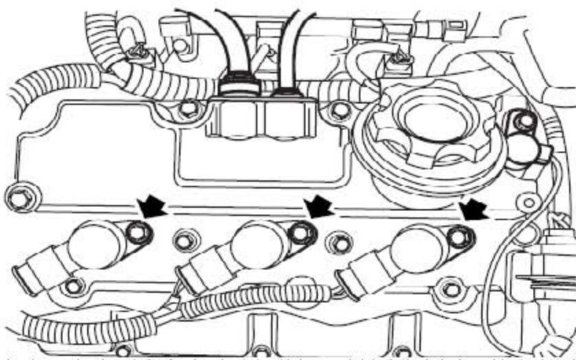
13). 拆下把左列点火线圈固定到左凸轮轴支架罩盖，拔出左列气缸盖上的3个点火线圈的连接器。
