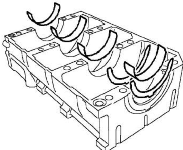
15). 从轴承座上拿下主轴瓦和2个止推垫圈，按安装顺序放好。
