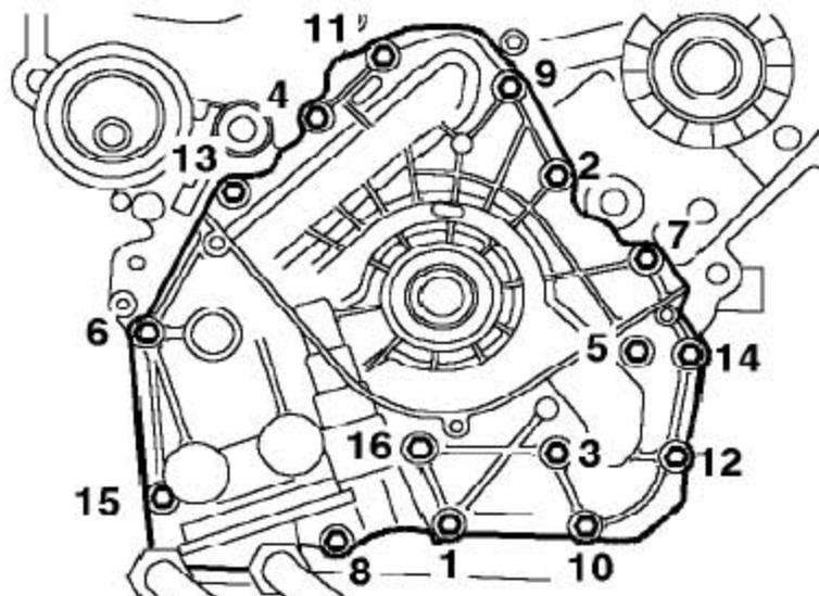
22). 装上新的固定机油泵到缸体上的Patchlok 螺栓, 并按图所示的顺序, 拧紧到25Nm。
