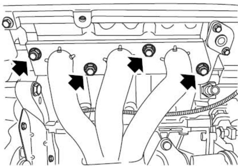
21). 拧下固定右排气岐管到缸盖的螺母，拿开岐管。
