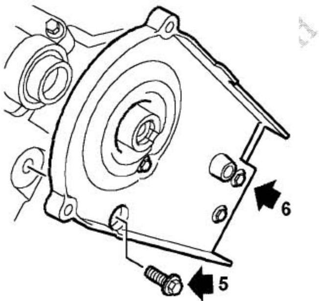
5). 拧下4个固定凸轮轴正时皮带盖底盖的螺栓。
