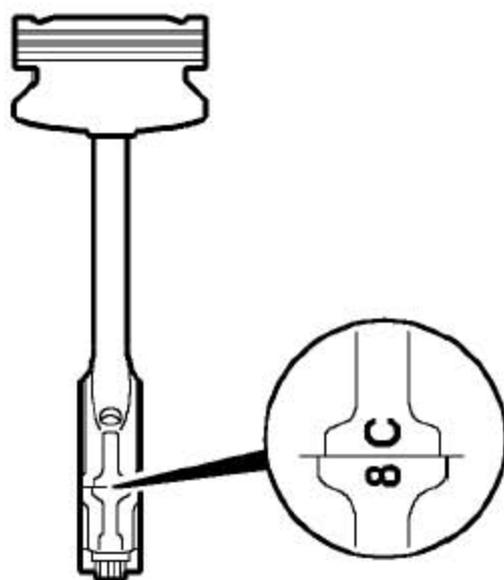
21). 从连杆大头的轴承盖上记录下连杆大头孔径，连杆大头孔分7、8、9 三个直径等级。
