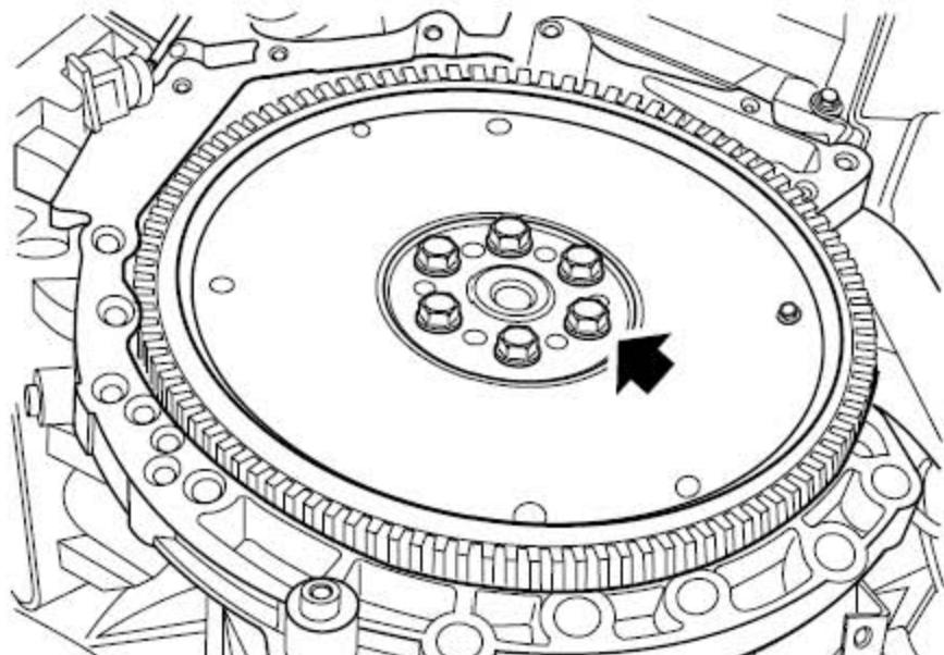
3). 拆下将驱动盘固定到曲轴上的6个Patchlok螺栓，并废弃。
