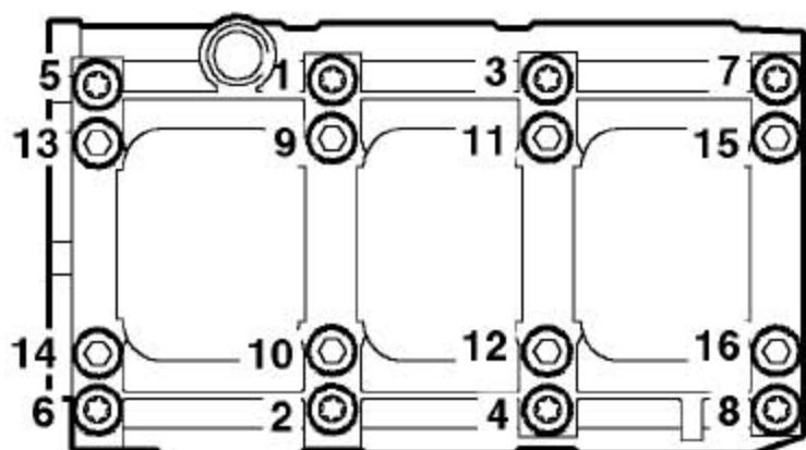
18). 装上新的螺栓并按轴承座上所示的顺序拧紧到20Nm，然后按顺序再拧90°。
