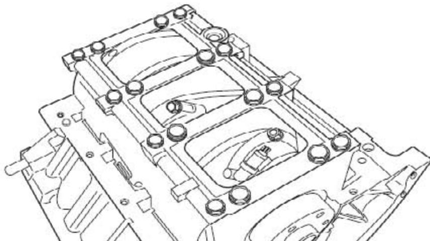
13). 拆下把轴承座固定到缸体的16个螺栓并废弃。
