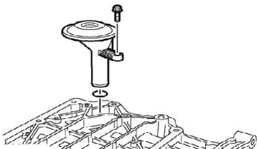
10). 拆下固定机油集滤器的螺栓，从吸油管上取下O形圈，并废弃。
