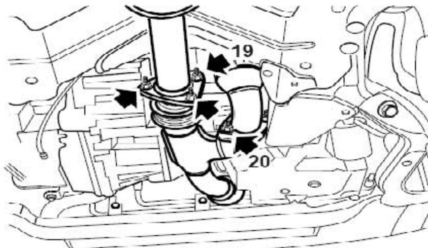
19). 拧下固定排气管到排气歧管法兰上的3个螺母。
