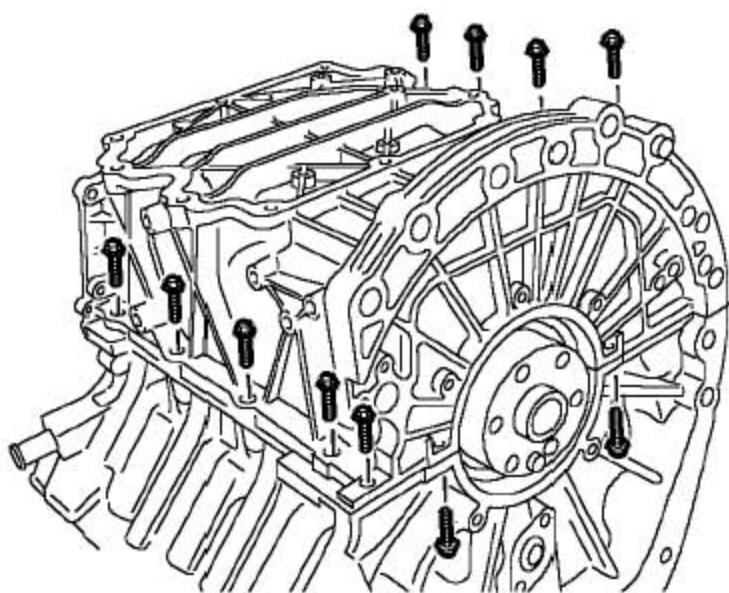
11). 拆下11个把下曲轴箱固定到缸体上的螺栓，从缸体上拿开下曲轴箱。
