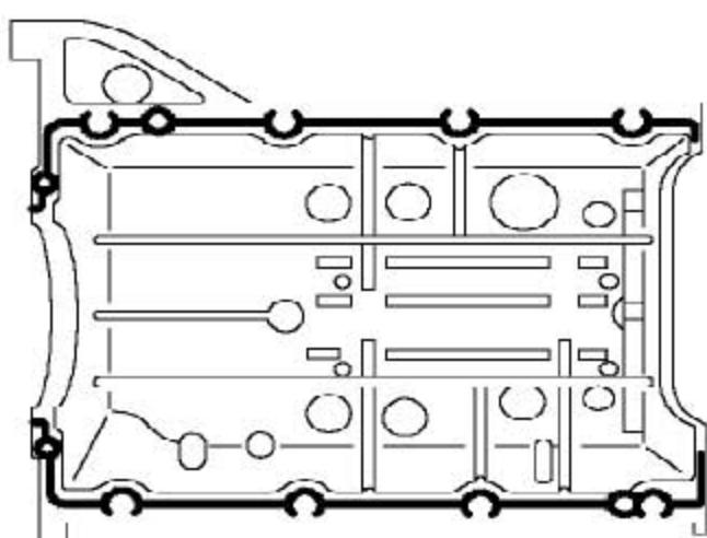
14). 在如图所示的下曲轴箱上，涂上连续的密封剂，部件号FLM 90018A，然后用滚轮把密封剂分散成均匀的薄膜。
