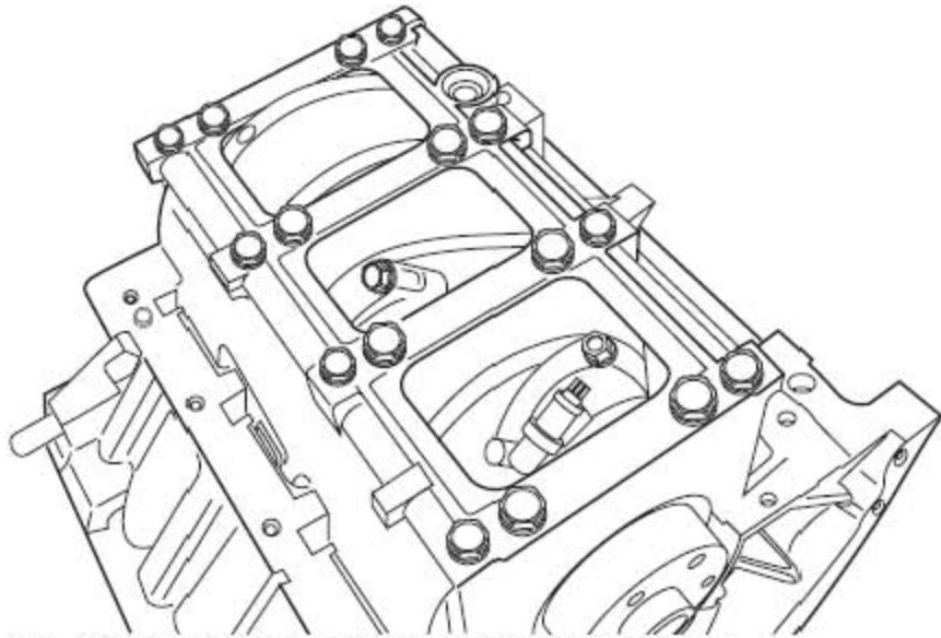
15). 拆开把轴承座固定到缸体的16个螺栓并废弃。
