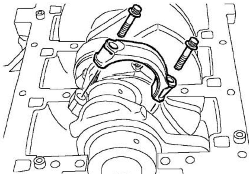
19). 拧下4个定位螺栓，从第1和第2缸连杆上拿开连杆大头盖。把大头盖和螺栓按顺序放好。
