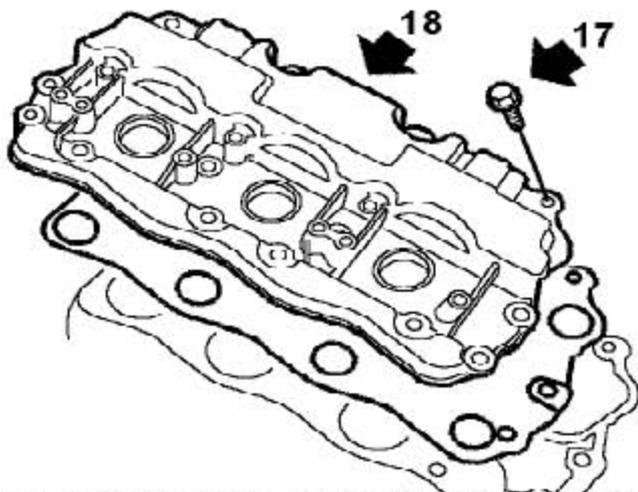
17). 逐渐松开固定右凸轮轴盖的14个螺栓并拿开。
