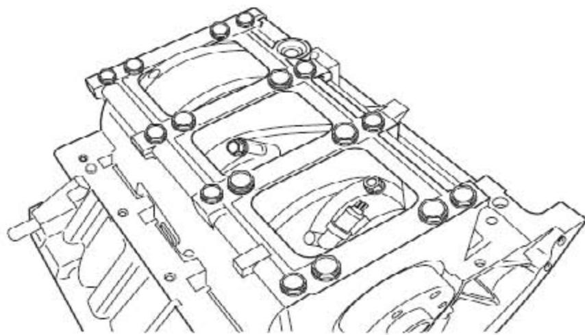
13). 拆下把轴承座固定到缸体的16个螺栓并废弃。
