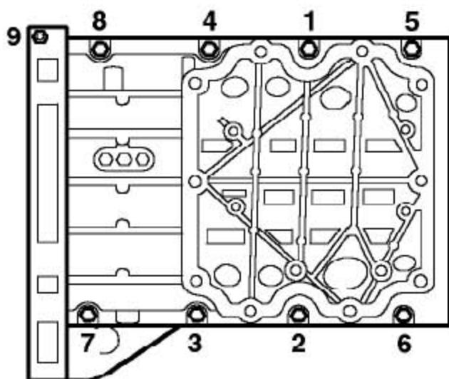
21). 放上下曲轴箱，按图示顺序装上9个M8螺栓并拧紧到35Nm，2个M5的螺栓拧紧到9Nm。
