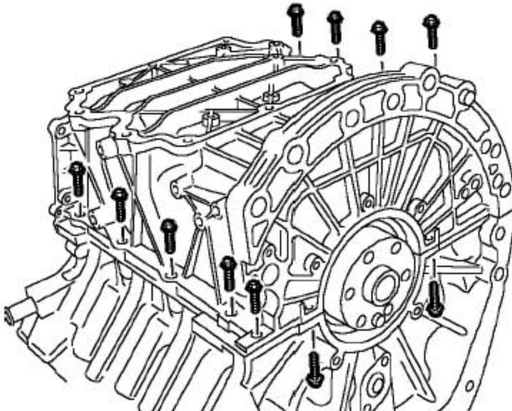
13). 把固定下曲轴箱和缸体的11个螺栓拧开，从缸体上拿开下曲轴箱。
