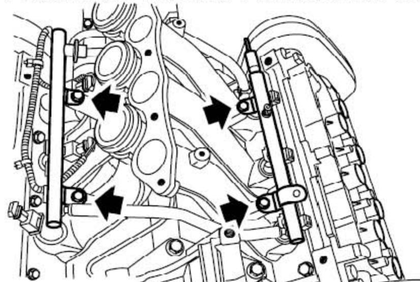
15). 拧下4个把燃油导轨总成固定到进气歧管上的螺栓。
