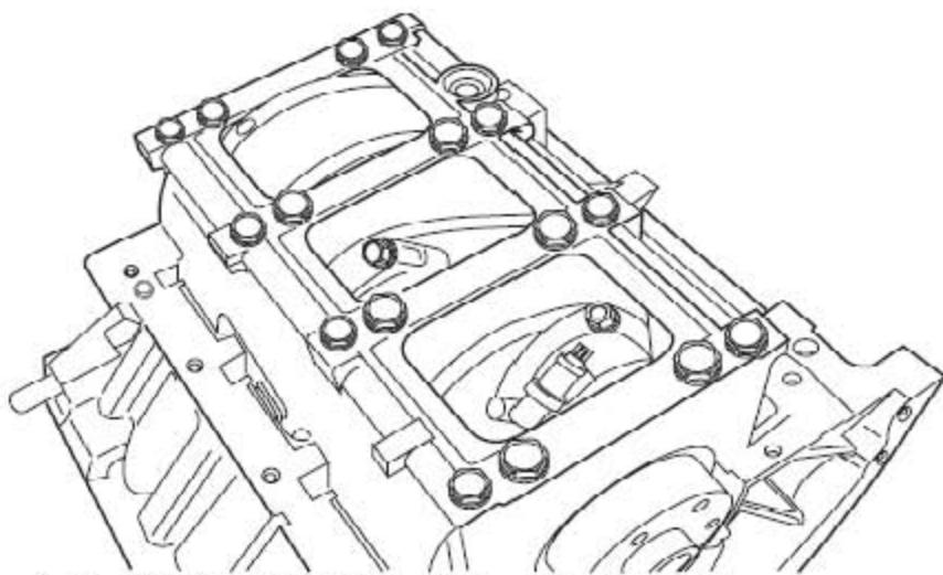
12). 拿开把轴承座固定到缸体的16个螺栓并废弃。
