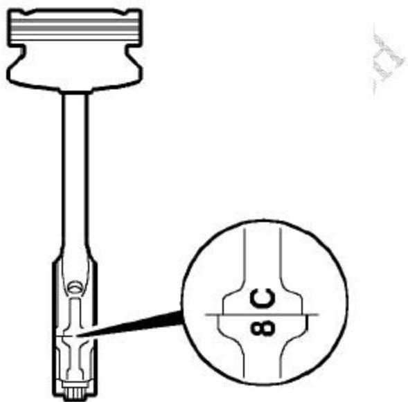
21). 从连杆大头的轴承盖上记录下连杆大头孔径，连杆大头孔分7、8、9 三个直径等级。
