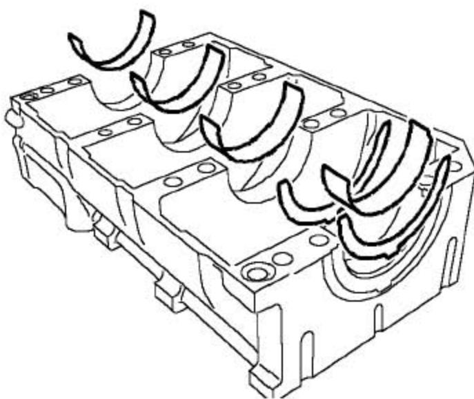
15). 从轴承座上拿下主轴瓦和2个止推垫圈，按安装顺序放好。
