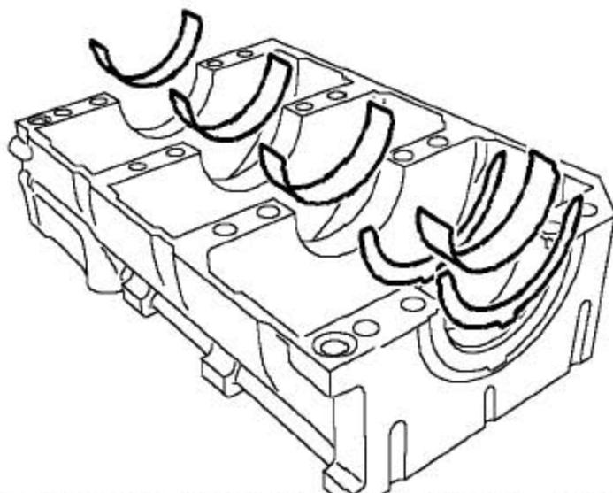
14). 从轴承座上取下主轴瓦和2个止推垫片，按安装顺序放好。
