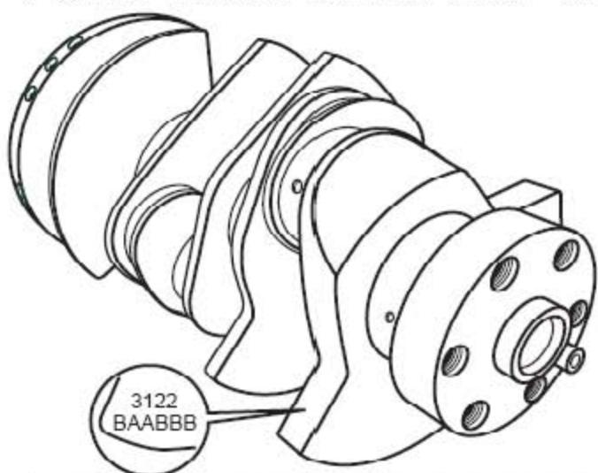
20). 从曲轴后平衡块外侧面读取主轴颈和连杆轴颈的直径尺寸分组代码。上层为主轴颈等级，分1, 2, 3 三等，从左向右读，第一个代码为第一主轴颈的直径等级，共四位数。下层为连杆轴颈等级，分A、B、C 三等，从左向右读，第一个代码为第一连杆轴颈的直径等级，共六个字母。
