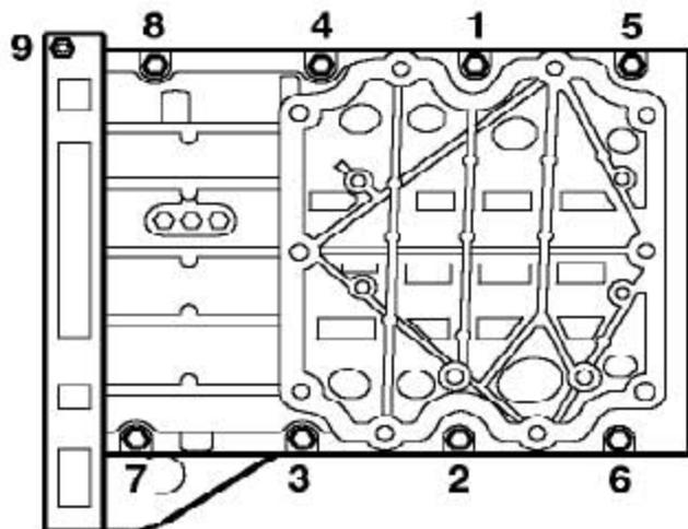
15). 固定下曲轴箱, 按图所示的顺序装上9个M8螺栓并拧紧到35Nm。2个M5的螺栓拧紧到9Nm。
