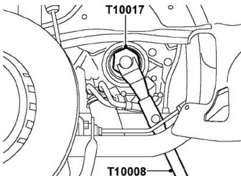
2). 把工具T10017和T10008固定到曲轴皮带轮上以限制曲轴转动。
