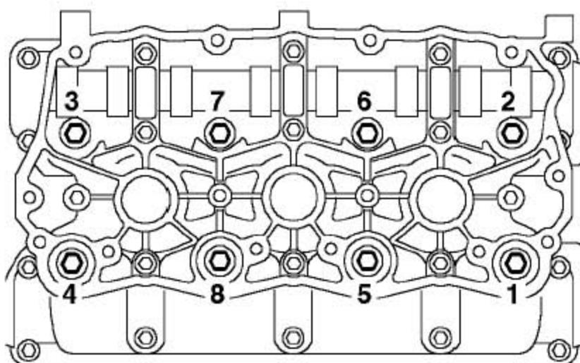
23). 按图示的顺序，渐次松开并取下8个缸盖螺栓。
