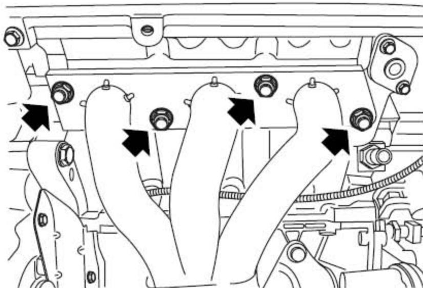
21). 拧下固定右排气歧管到缸盖的螺母，拿开歧管。
