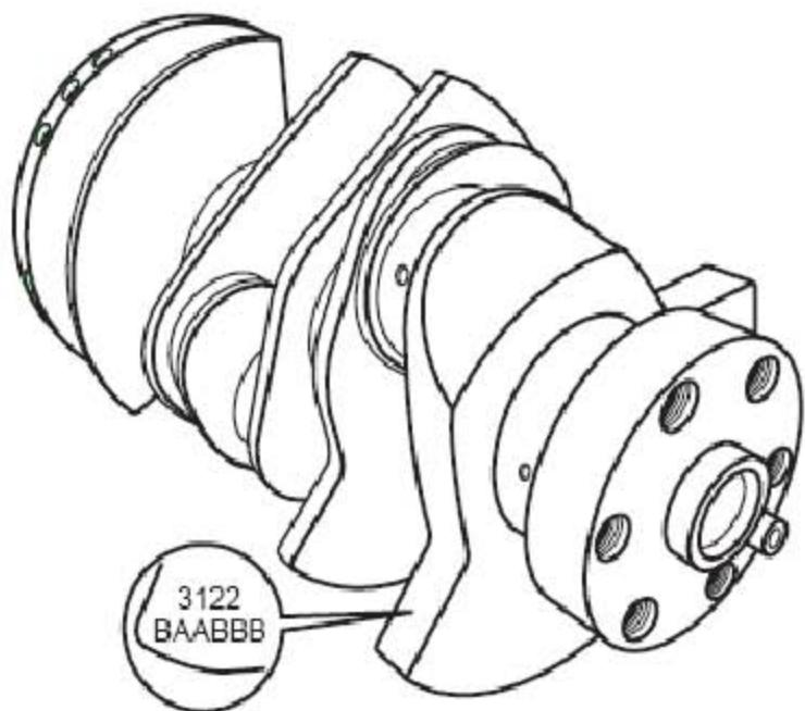
22). 从曲轴后平衡块外侧面读取主轴颈和连杆轴颈的直径尺寸分组代码。上层为主轴颈等级，分1, 2, 3 三等，从左向右读，第一个代码为第一主轴颈的直径等级，共四位数。下层为连杆轴颈等级，分A、B、C 三等，从左向右读，第一个代码为第一连杆轴颈的直径等级，共六个字母。
