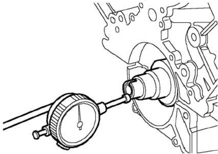
14). 测量曲轴的轴向间隙：用一DTI（千分表）量规
