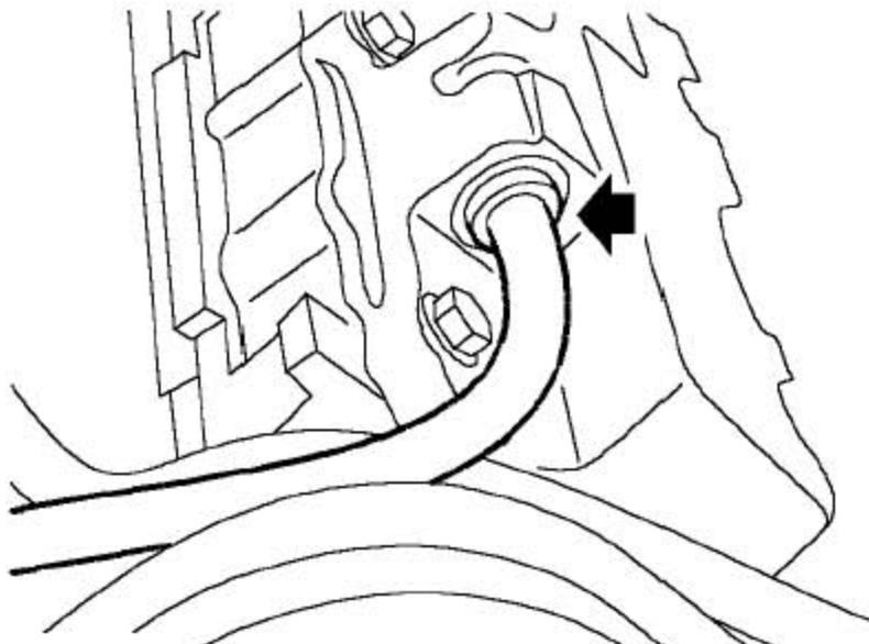
7). 按锁止边圈，从凸轮轴右盖上松开发动机呼吸管。
