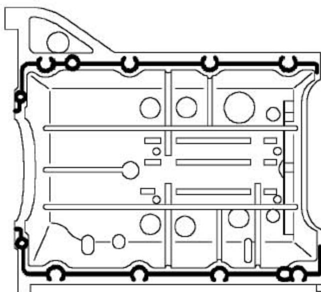
20). 在如图所示下曲轴箱路径上，涂连续的密封剂，部件号为FLM 90018A，然后用滚轮把密封剂抹成均匀的薄膜。
