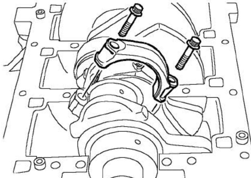
16). 拧开4个定位螺栓，从第1和第2缸连杆上取下连杆大头盖。把大头盖和螺栓按顺序放好。
