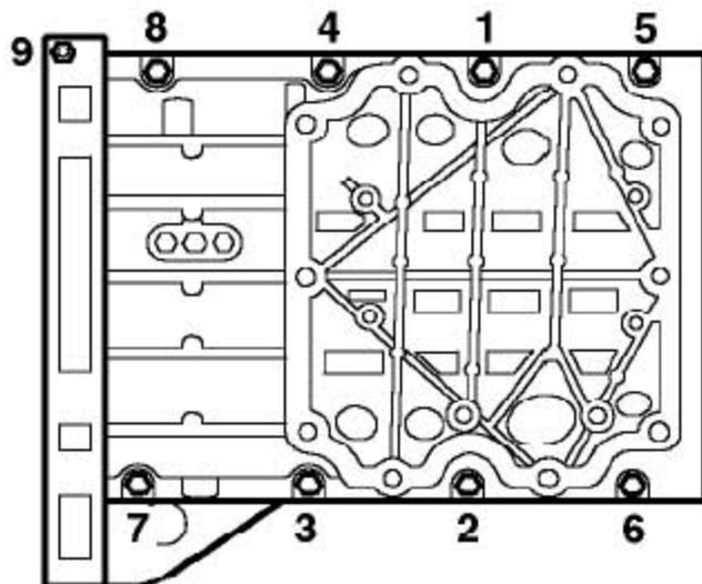
21). 放上下曲轴箱, 按图示顺序装上9个M8螺栓并拧紧到35Nm, 2个M5的螺栓拧紧到9Nm。
