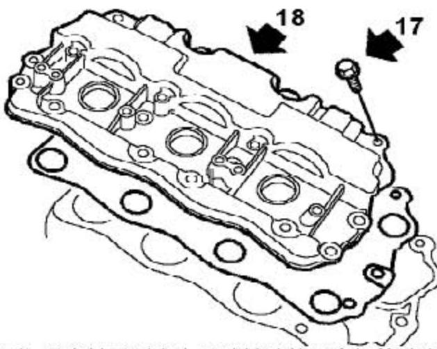
17). 逐渐松开固定右凸轮轴盖的14个螺栓并拿开。
