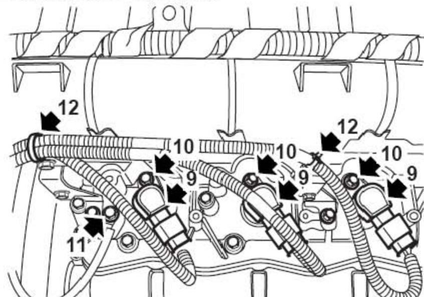
9). 拔出右列气缸盖的3个点火线圈的连接器。
