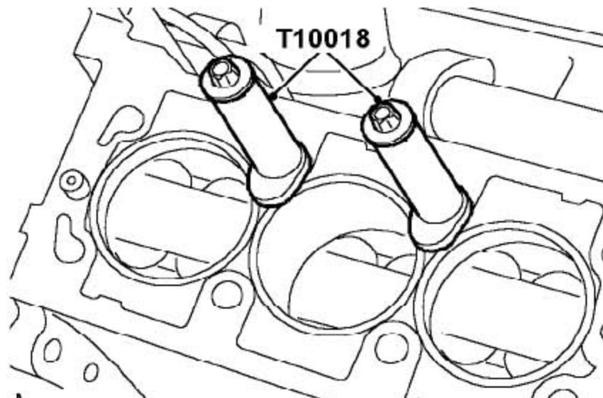
26). 放上平缸夹T10018并用缸盖螺栓固定。确保夹子的底部没有突出到缸套的内径。
