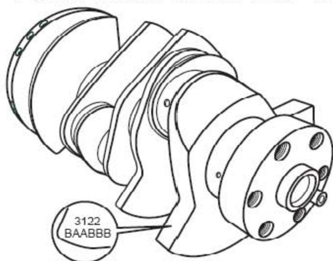
20). 从曲轴后平衡块外侧面读取主轴颈和连杆轴颈的直径尺寸分组代码。上层为主轴颈等级，分1, 2, 3 三等，从左向右读，第一个代码为第一主轴颈的直径等级，共四位数字。下层为连杆轴颈等级，分A、B、C 三等，从左向右读，第一个代码为第一连杆轴颈的直径等级，共六个字母。
