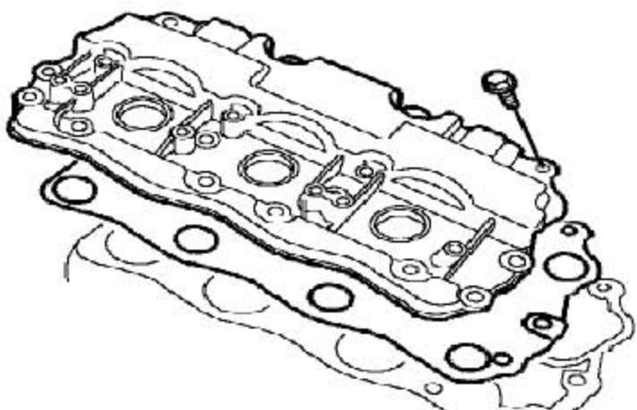
13). 拧下14个螺栓，拿开右凸轮轴罩盖和垫片。
