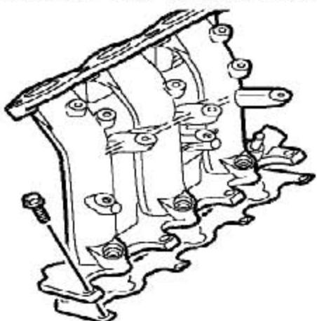
6). 慢慢松开7个把进气歧管固定到缸盖上的螺栓。
