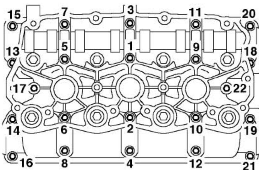
18). 装上凸轮轴支架，按顺序把螺栓拧紧到10Nm。不要转动凸轮轴。
