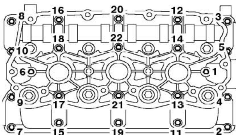
14). 按图所示的顺序，渐次松开把凸轮轴支架固定到缸盖上的22个螺栓，直到气门弹簧压力不再作用到凸轮轴上，拿开螺栓。
