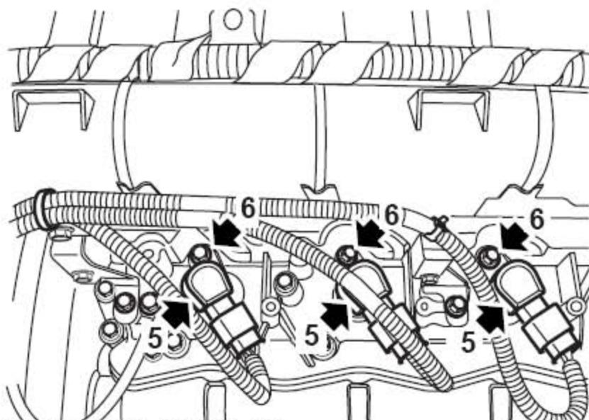
5). 从点火线圈上拔出3个连接器。
