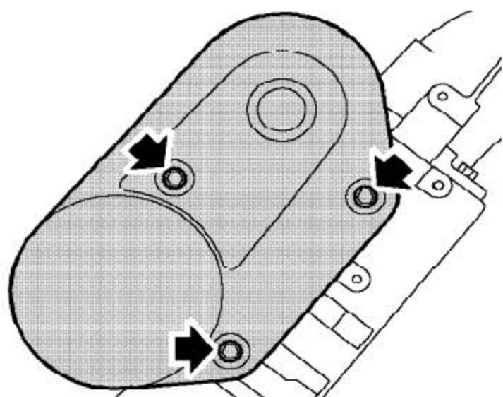
1). 拧开固定凸轮轴后正时带盖的3个螺栓并取下盖子。
