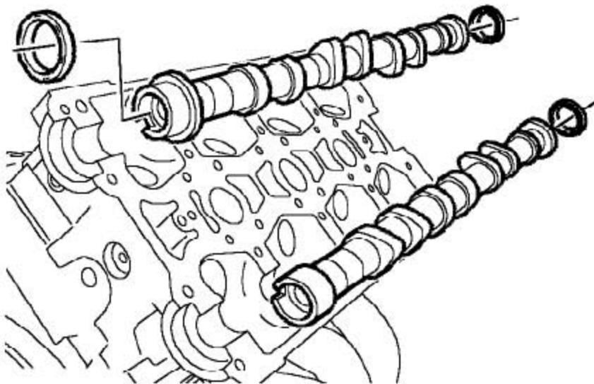
13). 取下凸轮轴，并废弃凸轮轴油封。
