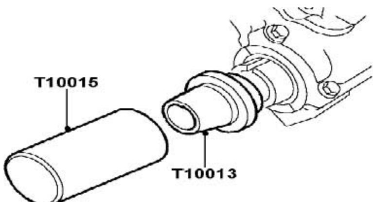
6). 注意前油封为黑色，后油封为红色，用工具T10015和T10013装上新的凸轮轴油封。
