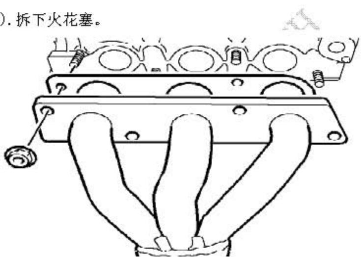
5). 慢慢松开4个把排气歧管固定到缸盖上的螺母，拿开排气歧管并废弃掉垫片。
