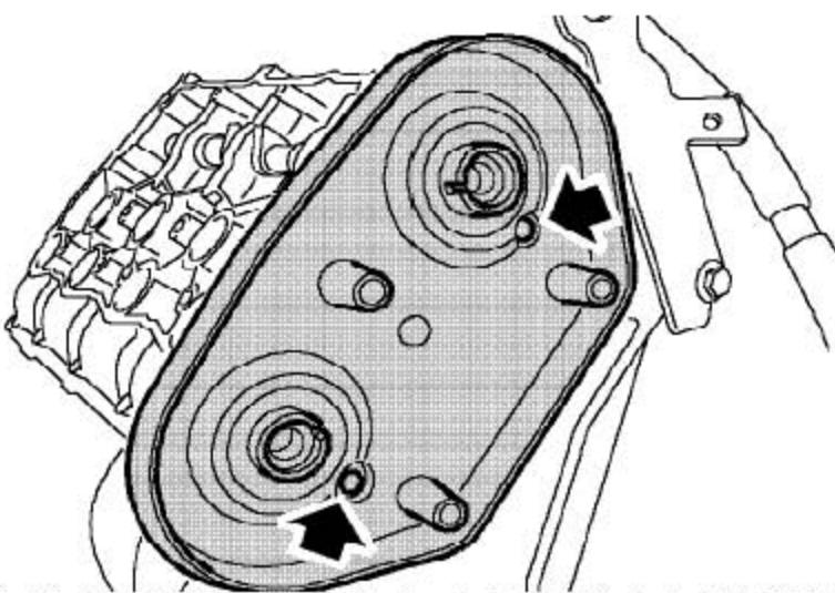
10). 拧开2个螺栓，从缸盖上取下后凸轮轴正时皮带盖的背板。
