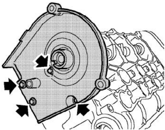
7). 拧下4个把前凸轮轴正时皮带盖背板固定到缸盖上的螺栓，并拿开背板。
