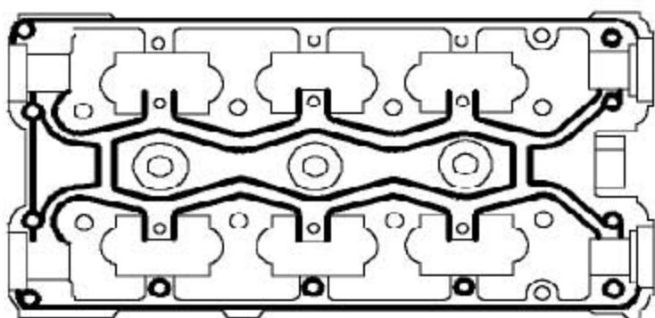
12). 在如图所示的凸轮轴支架路径上，用滚轮把密封剂涂成均匀的薄膜，密封剂部件号：FLM90017A。
