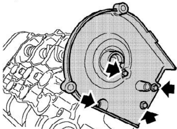
5). 拧开4个螺栓，从缸盖上取下前凸轮轴正时带盖的背板。
