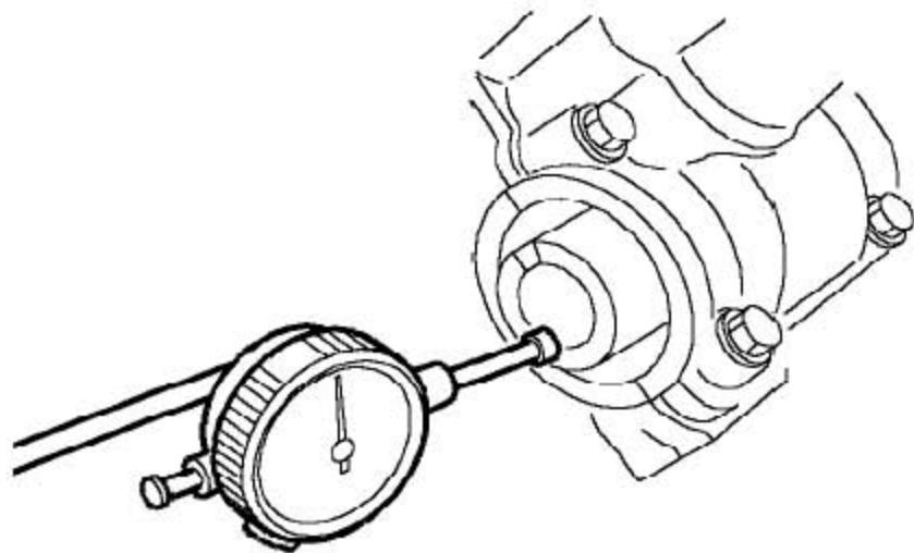
9). 用DTI千分表检查凸轮轴的轴向间隙。凸轮轴的轴向间隙: =0.08至0.21mm。
