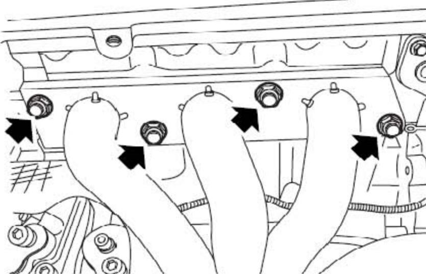
19). 拧下固定左侧排气歧管到缸盖的4个螺母。
