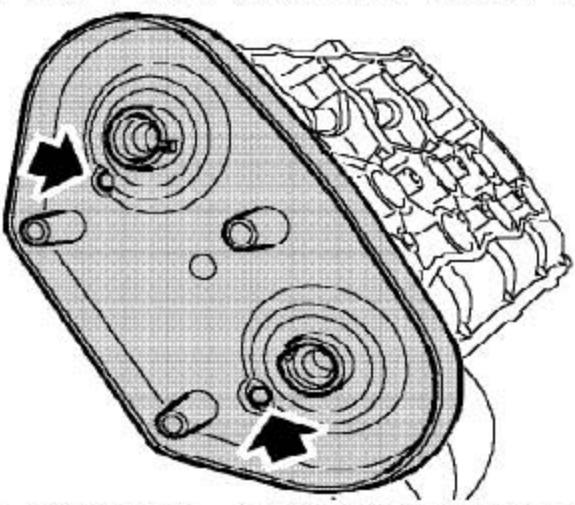
6). 拧开2个螺栓，从缸盖上取下后凸轮轴正时带盖的背板。
