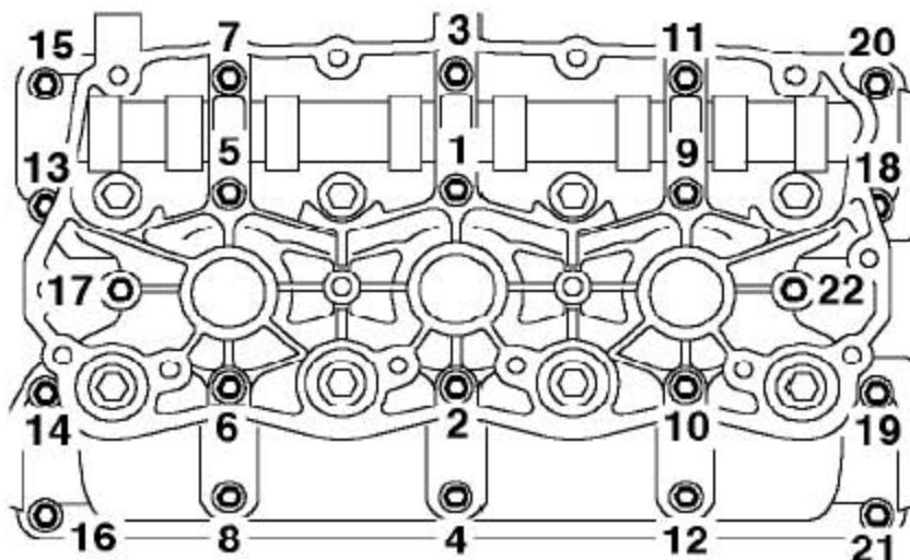
4). 再装上凸轮轴支架，按图示顺序把螺栓拧紧到10Nm。不要转动凸轮轴。
