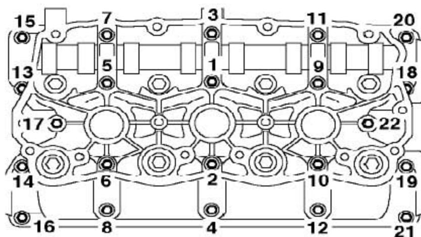
4). 再装上凸轮轴支架，按顺序把螺栓拧紧到10Nm。不要转动凸轮轴。
