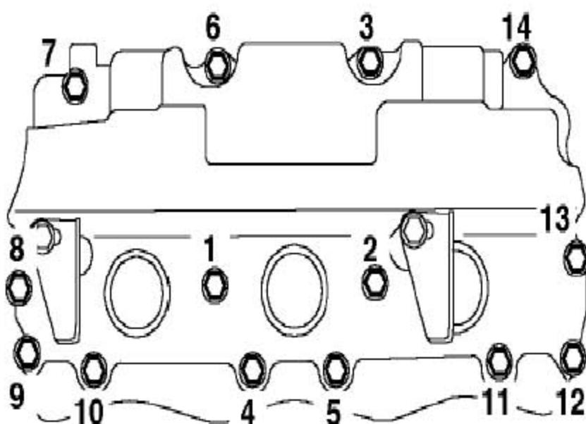
4). 装上螺栓，按图中所示的顺序依次把螺栓拧紧至9Nm。
