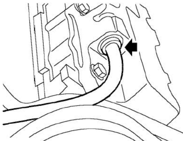
3). 压锁止边圈，从凸轮轴盖上松开发动机呼吸管。
