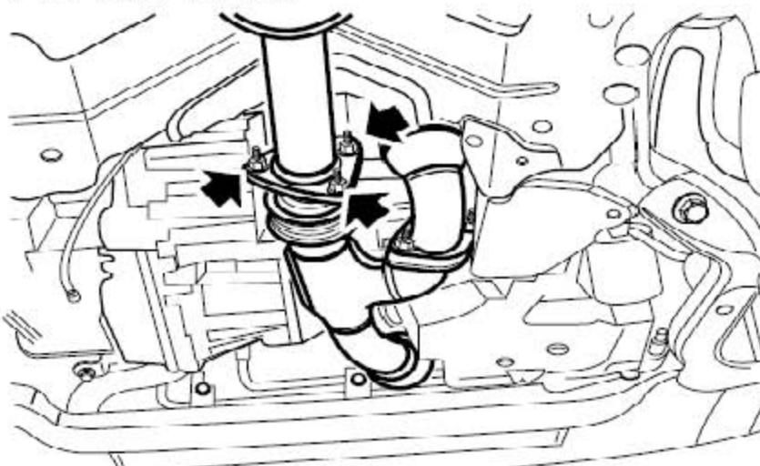
17). 拧下3个把排气管固定到左侧排气歧管的螺母。
