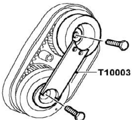
2). 如图所示，把T10003固定到后凸轮轴齿轮上，拧下把齿轮固定到凸轮轴上的螺栓并废弃。
