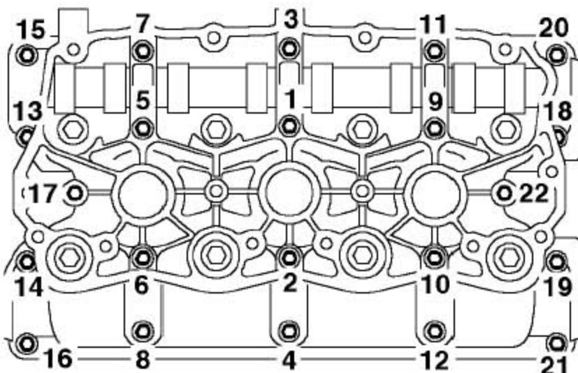
13). 装上凸轮轴支架，按顺序逐渐加力，把螺栓拧紧到10Nm。
