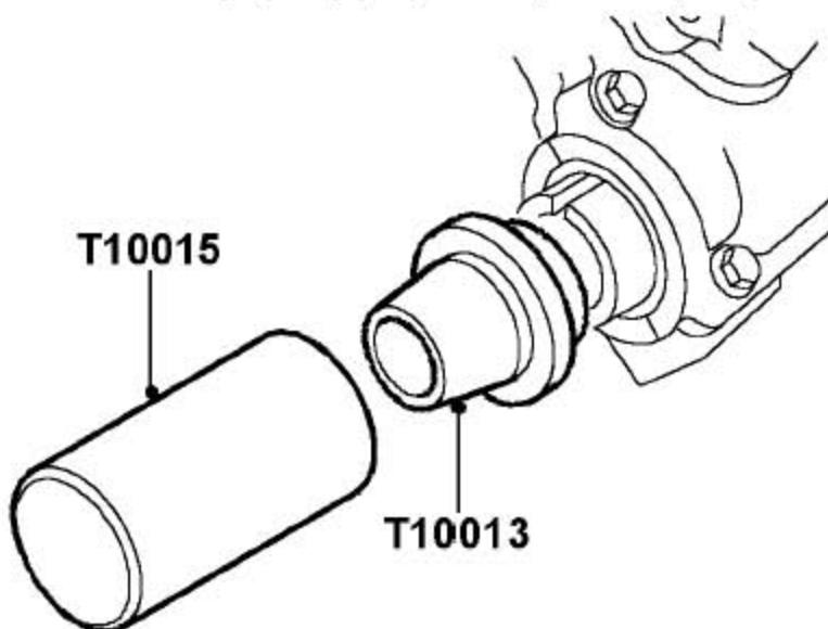
14). 注意前油封为黑色，后油封为红色，用工具T10015和T10013装上新的凸轮轴油封。
