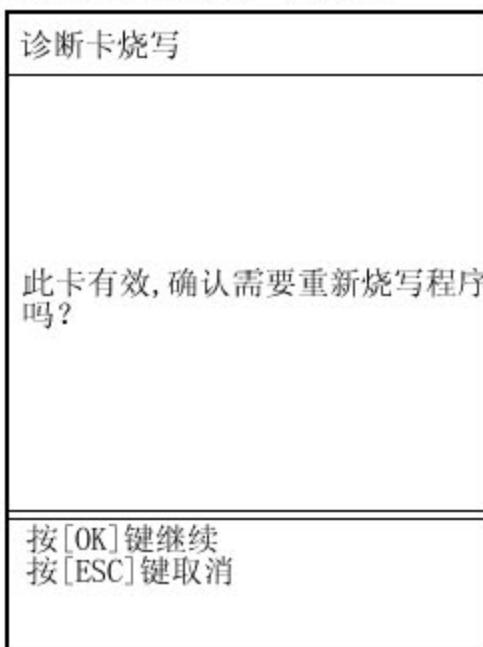
在上述界面中按[OK]键，主机提示“主机已就绪，请运行专用烧写程序 DTcard\_Updata.exe...”，如右图所示。此时，用户请在电脑端运行专用烧写软件 DTcard\_Updata.exe，正确配置该软件并选定所需烧写的程序文件后即可对诊断卡进入更新升级。
