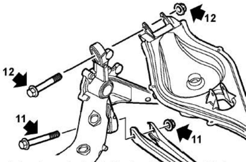
11). 拆下把后下摆臂总成固定到纵臂总成上的螺栓和螺母。
