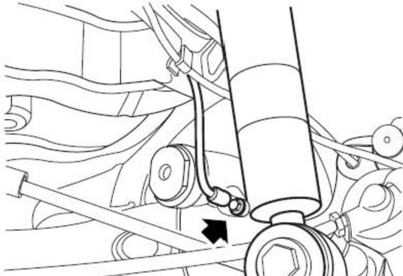
9). 拆下固定后轮ABS传感器的螺栓，取下后轮ABS传感器并放到一边。
