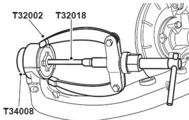
5). 用工具T32002, T32018和T34008拆下纵臂衬套。
