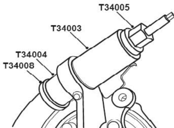
3). 用工具T34005, T34003和T34004T 和34008 从纵臂上拆下固定后上摆臂和后下摆臂衬套。
