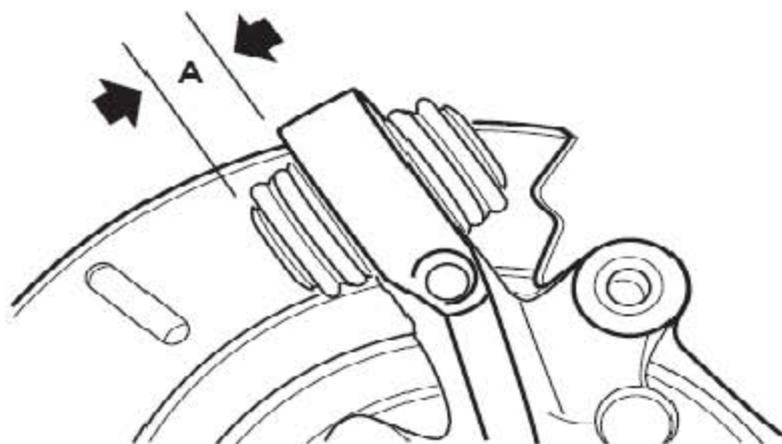
2). 注明并记录下后上摆臂和后下摆臂衬套在纵臂总成上的凸起A。
