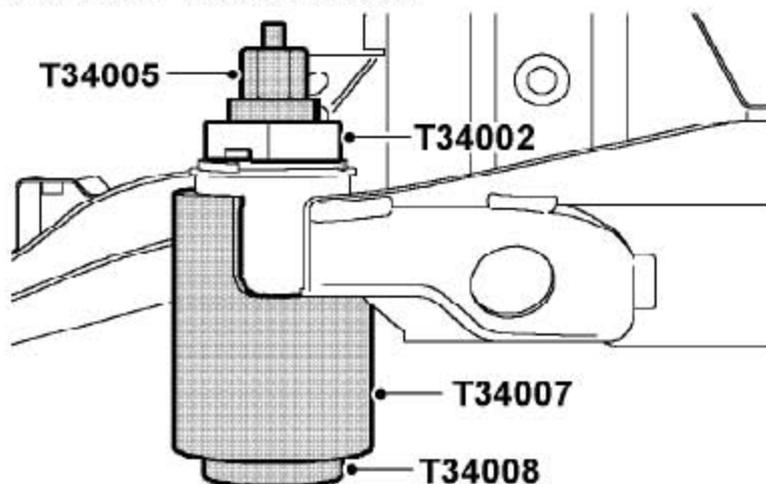
2). 用工具T34005, T34008, T34007和T34002, 装上后副车架橡胶衬套。
