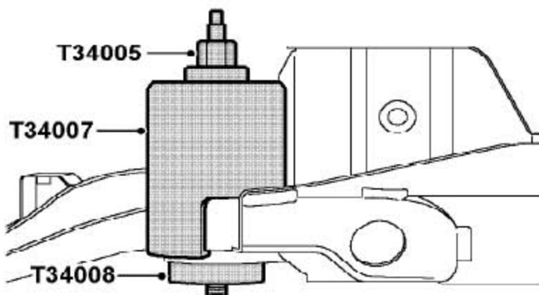
2). 用工具T34007, T34008和T34005, 拆下后副车架橡胶衬套。
