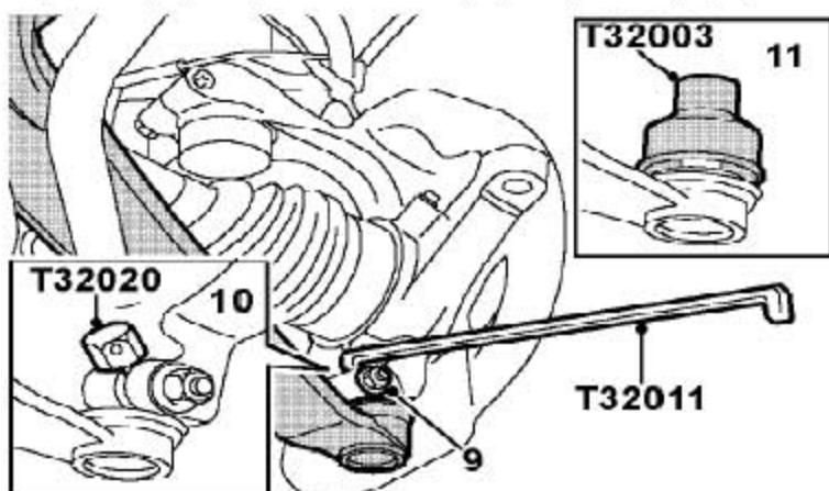
9). 拆下把前下摆臂外球节固定到前轮毂上的螺母和螺栓。
