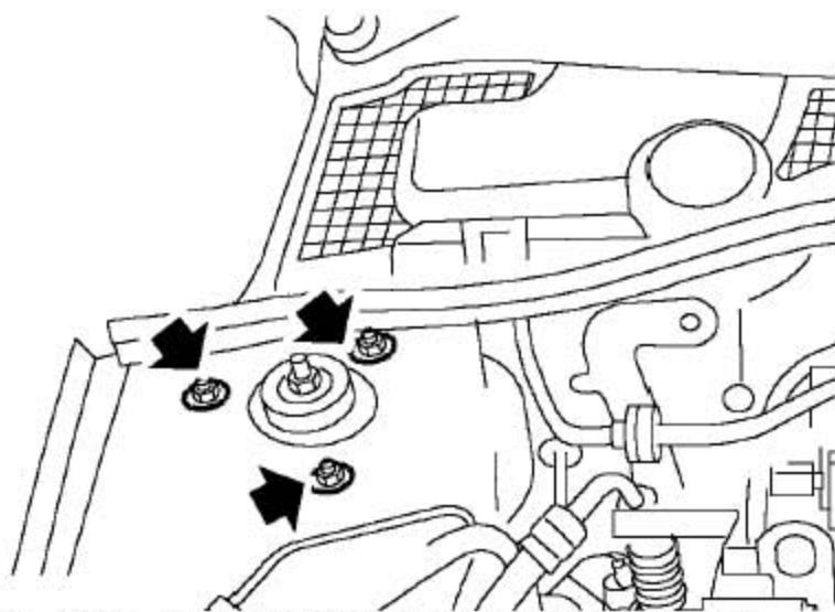
14). 拆卸3个把前减振器总成固定到车身上的螺母。
