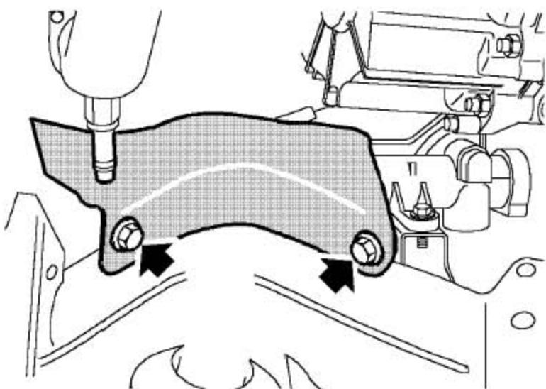
3). 拆下转向机隔热罩的2个螺栓并取下转向机隔热罩。
