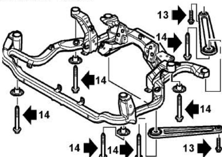
13). 拆卸2个把前副车架支撑杆固定到车身上的螺栓并废弃。
