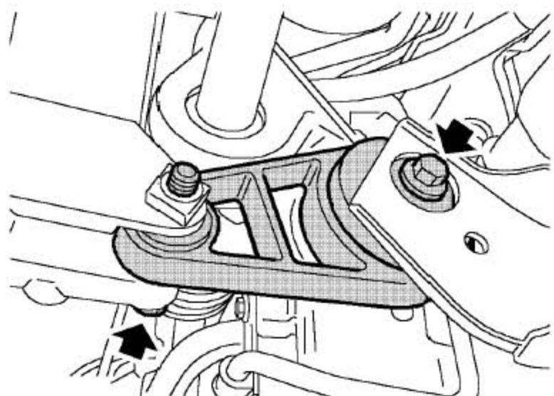
8). 拆下2个固定发动机下后系杆的螺栓并拆下发动机下后系杆。
