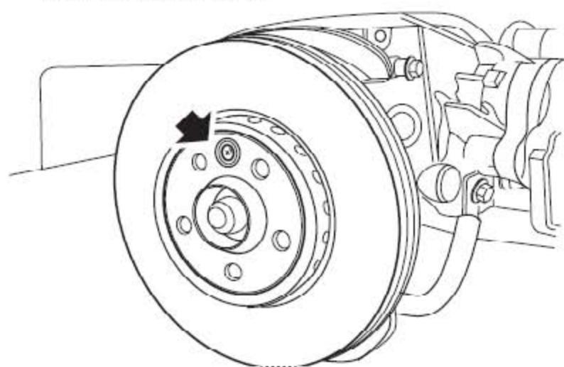
8). 拆下把前制动盘总成固定到前驱动法兰上的沉头螺钉。
