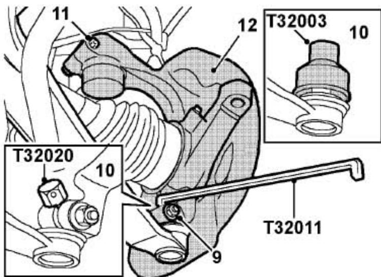
9). 拆下把前下摆臂外球节固定到前轮毂上的螺母和螺栓。
