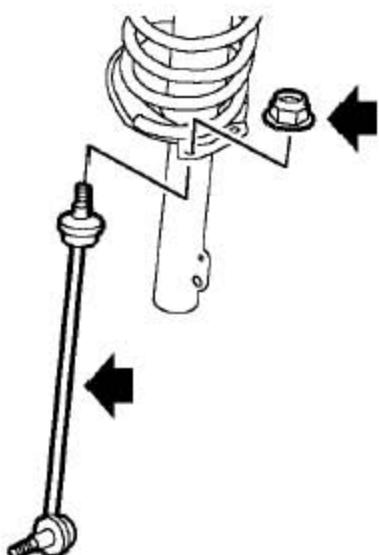
16). 拆下把前横向稳定杆连接杆固定到前减振器总成上的螺母并取下前横向稳定杆连接杆。
