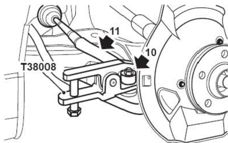
10). 拆下把转向横拉杆固定到转向臂上的螺母，给转向横拉杆球节装上一个M10的螺母，与转向横拉杆球节端头平齐。
