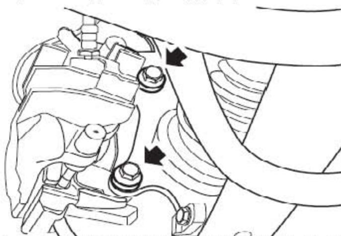
7). 拆下2个把前制动钳总成固定到前轮毂总成上的螺栓。从前轮毂上总成松开前制动钳总成并放到旁边。
