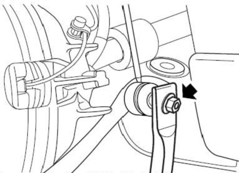
4). 用一开口扳手卡住前横向稳定杆连接杆，以防止前横向稳定杆连接杆球节转动。拆卸固定在前横向稳定杆连接杆上的螺母，并从前横向稳定杆上松开前横向稳定杆连接杆。
