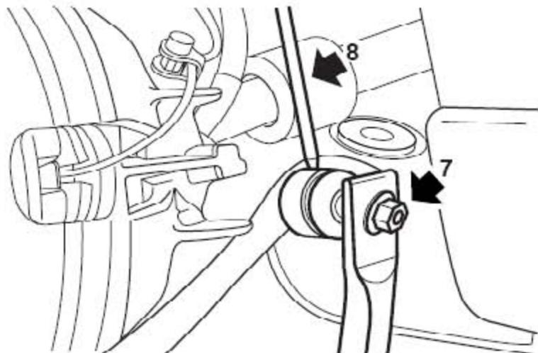
7). 用扳手卡住前横向稳定杆连接杆，以防止前横向稳定杆连接杆球节转动。拆下把前横向稳定杆连接杆固定到前横向稳定杆上的螺母。
