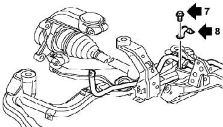
7). 拆下2个前横向稳定杆固定支架固定到前副车架上的螺栓。
