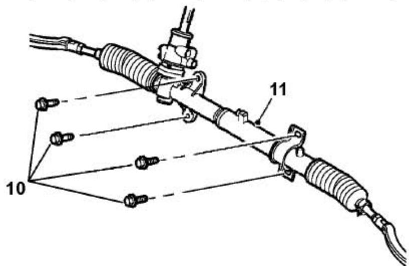
10). 拆下4个把动力转向机固定到前副车架总成上的螺栓。
