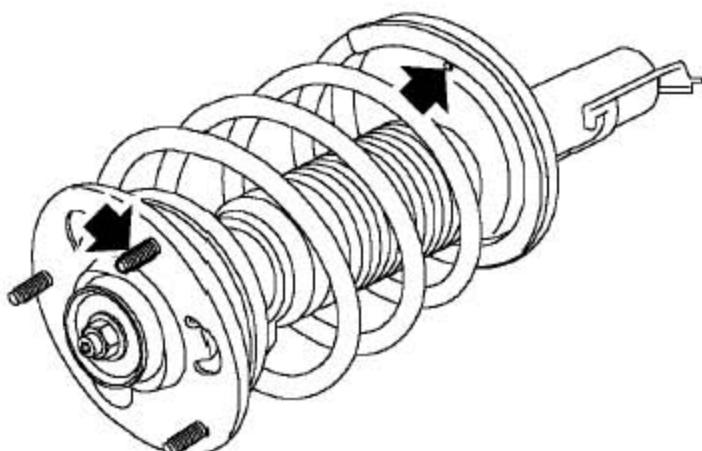
17). 标记和注明前减振器上部安装支座和前减振器弹簧安装支座排水孔的相对位置。
