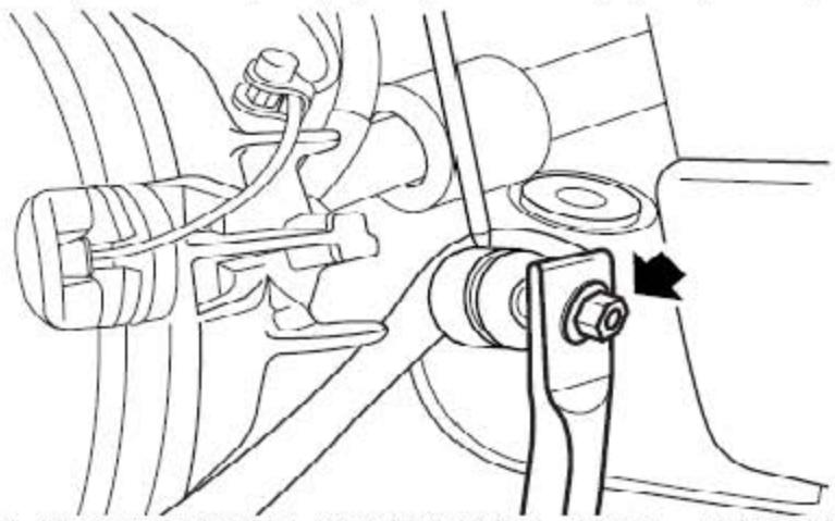
5). 拆下固定到前横向稳定杆连接杆上的螺母，并从前横向稳定杆上松开前横向稳定杆连接杆。
