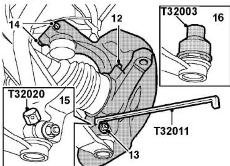
12). 拆下固定前轮ABS传感器的螺钉，松开前轮ABS传感器并放到一边。
