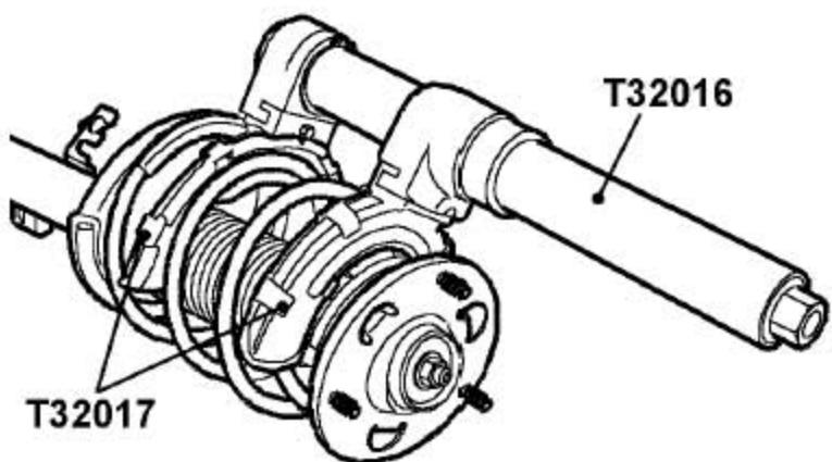
18). 按如图所示把弹簧压缩器T32016和T32017固定到前减振器弹簧上。
