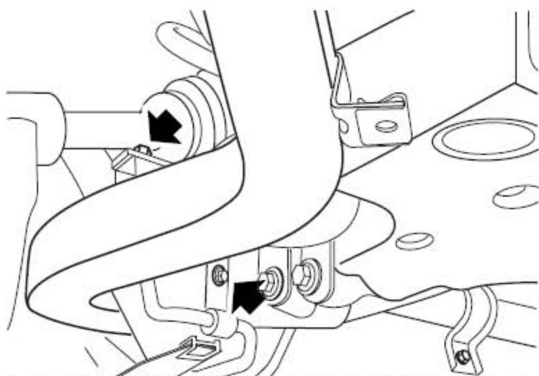
5). 拆下把动力转向机回油管支架固定到前副车架总成上的2个螺栓。
