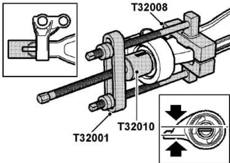
2). 把前下摆臂衬套和支架总成定位到前下摆臂上，确保衬套和前下摆臂上的标记对准。
