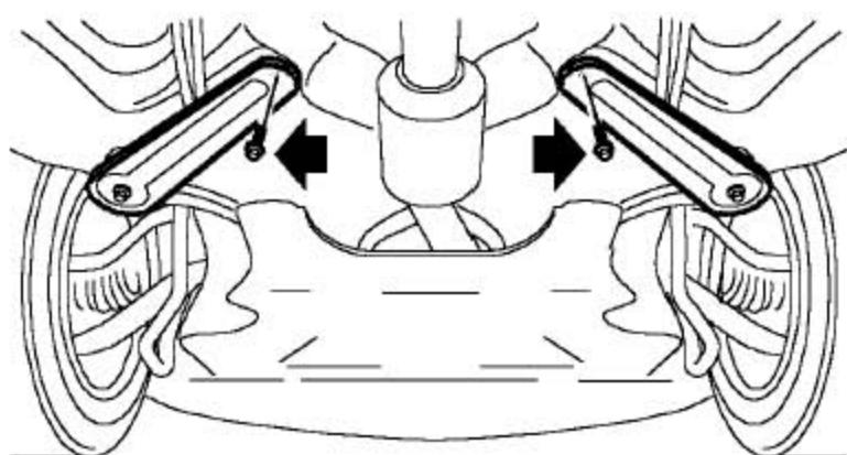
2). 拆下把前副车架支撑杆固定在车身上的螺栓，并废弃不用。
