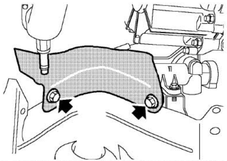
9). 拆下2个固定转向机隔热板的螺栓并拆卸转向机隔热板。
