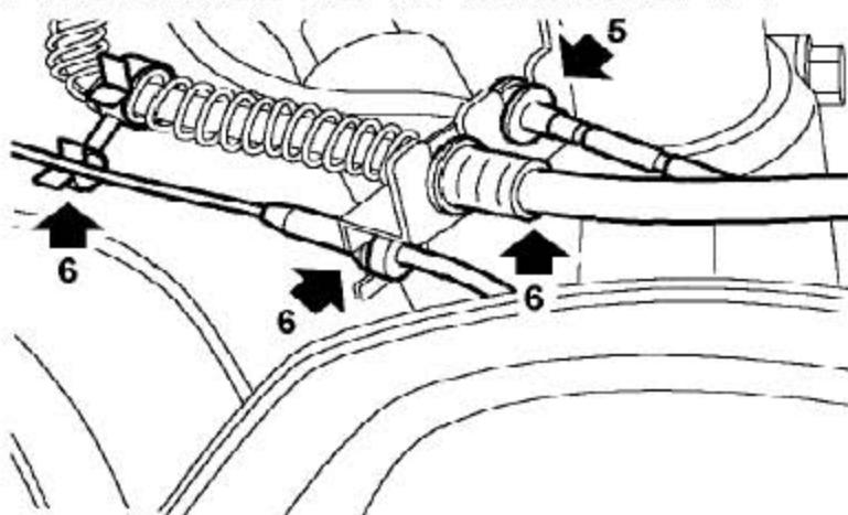
5). 针对右侧：断开前制动衬块磨损传感器的连接，从前减振器柱跨接支架上松开前制动衬块磨损传感器，并松开线束。
