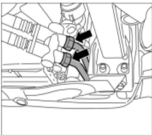
节温器上的 ATF 冷却器管路
