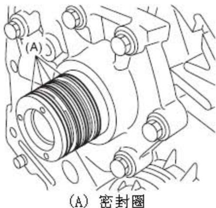
B). 拆下安装螺栓，然后轻敲起动机轴的尾部，拆下油泵盖。
