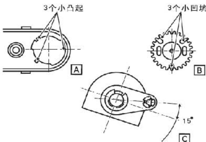
2). 定位并把驾驶员侧门外手柄衬板总成装到车门上，用螺栓固定并拧紧至2-2.5Nm。如果运输过程中由于震动等原因使齿轮初始位置变动，应自行调整，如A、B图所示主动轮的3个凹坑与驱动底座的3个凸器配合，装配好后，要达到C图状态。
