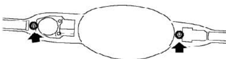
8). 松开把前排乘客侧门外手柄衬板总成固定到车门上的2个螺栓。
