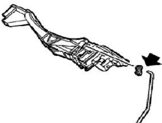
10). 从后车门外手柄衬板总成上松开后车门外手柄释放连杆。
