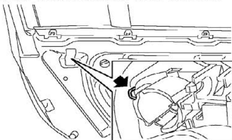
3). 拨动后车门外手柄衬板总成上的夹箍，松开后车门外手柄闷盖。
