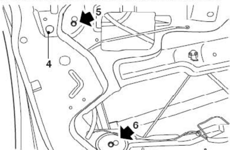
4). 提升玻璃直到电动玻璃升降器橡胶夹固定螺栓对准门孔处，松开螺栓，把玻璃从电动玻璃升降器上松开。
