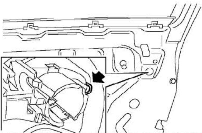
3). 拨动前排乘客侧门外手柄衬板总成上的夹箍, 松开前排乘客侧门外手柄闷盖。
