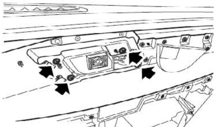
2). 拧开把前车门内拉手总成固定到内饰板总成上的4个自攻螺钉。
