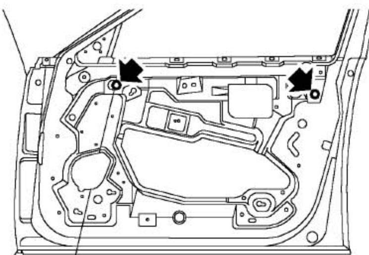
7). 拧紧玻璃升降器橡胶夹固定螺栓至6.5-7.5Nm。
