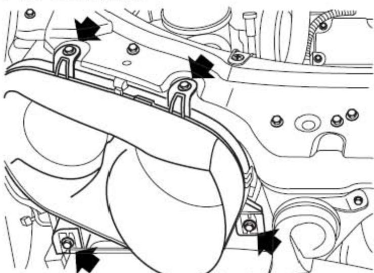
3). 拆下4个把前照灯固定到水箱上横梁上的螺栓。
