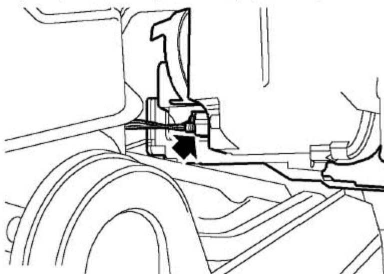
4). 松开前照灯，断开连接器，取下前照灯总成。
