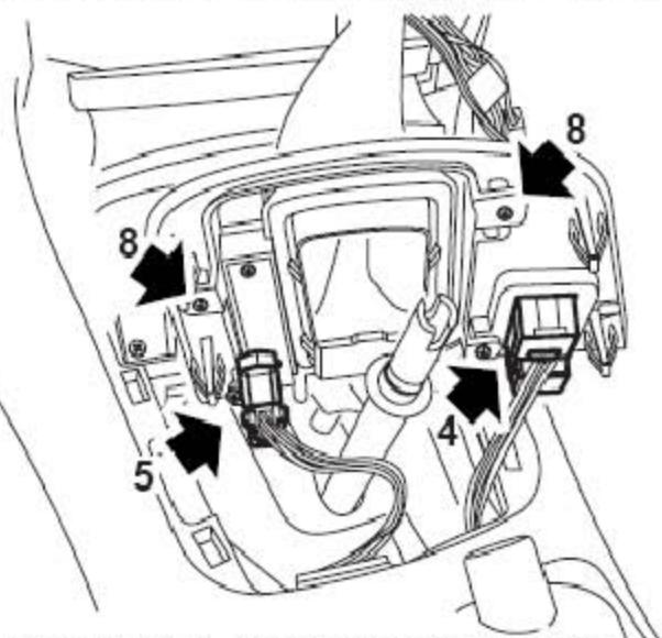
4). 断开变速箱模式控制开关的连接器的连接。
