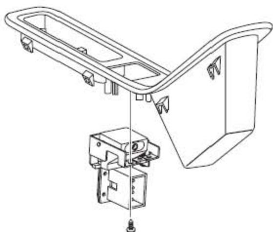
14). 拧开3个把音频插头面板或者音频 / 视频插头面板固定到中控台开关盒上的自攻螺钉。
