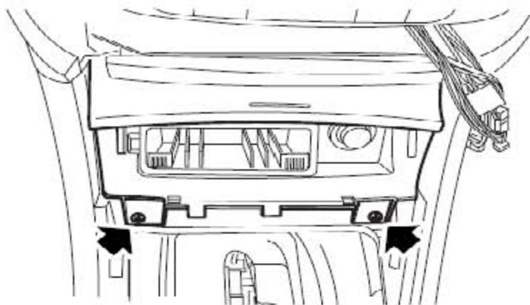
4). 拧开把前烟灰缸总成固定到中控台上的2个自攻螺钉。
