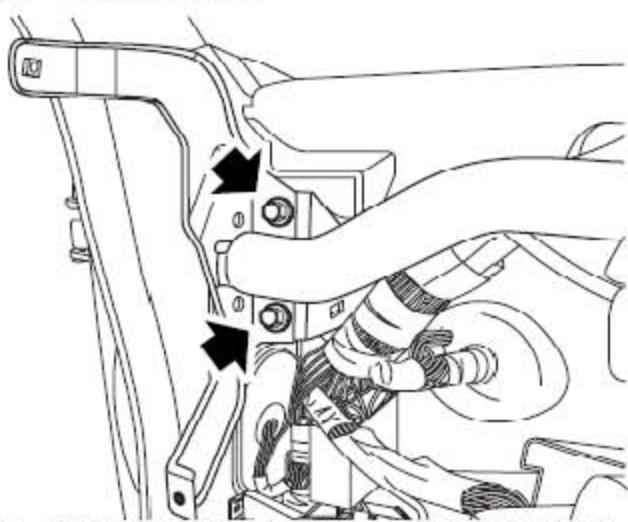
7). 拆下把仪表板骨架总成固定到安装支架总成上的螺栓。
