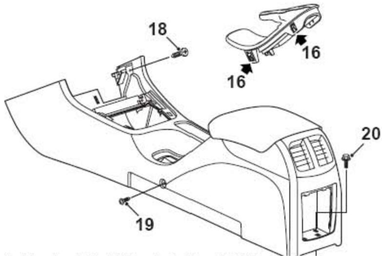
16). 松开把手制动护套总成固定到中控台上的卡扣。
