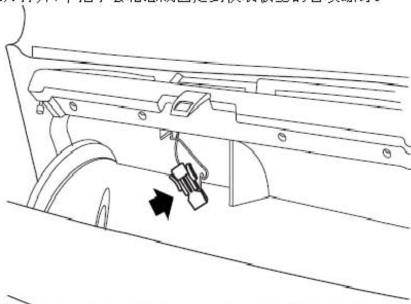
5). 松开手套箱总成并断开手套箱灯的连接器的连接。
