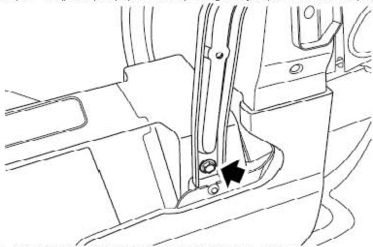
8). 拆下把仪表板骨架总成固定到车身上的螺栓。
