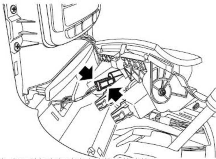
6). 断开前烟灰缸总成上连接器的连接。
