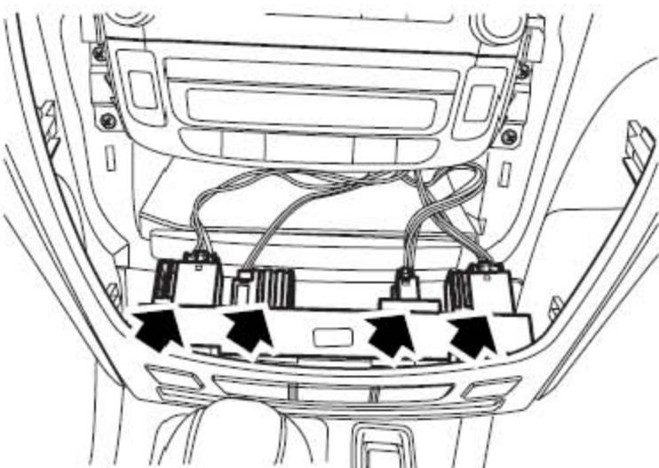
6). 断开开关连接器的连接，并拿开中央面板总成。
