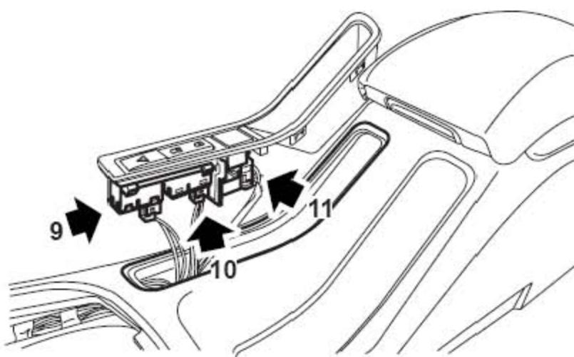
9). 断开报警灯开关的连接器的连接。
