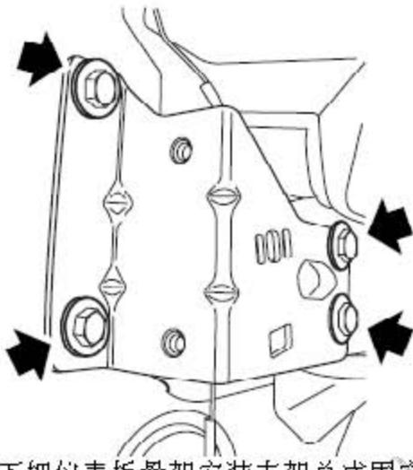
2). 拆下把仪表板骨架安装支架总成固定到车身上的螺钉。
