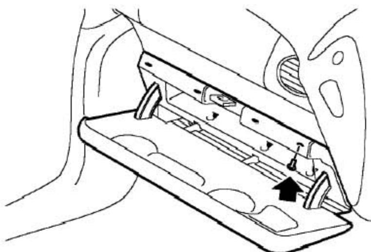
4). 拧开7个把手套箱总成固定到仪表板上的自攻螺钉。
