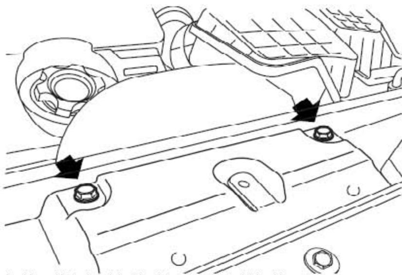
1). 拧下将空气进气管固定到水箱上横梁的二个螺钉。
