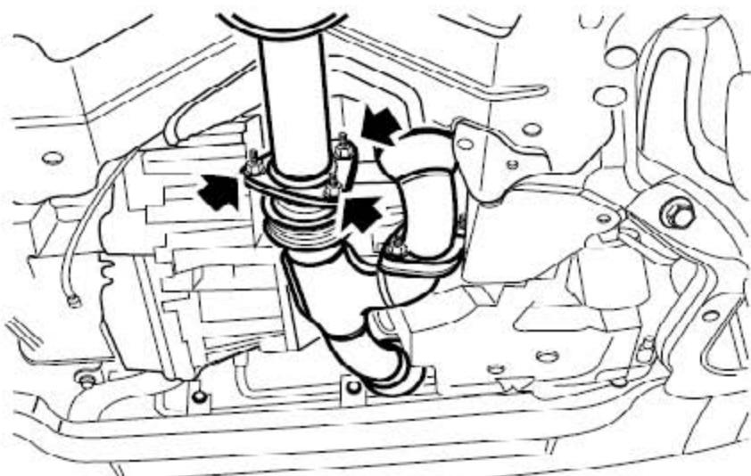
6). 拿开3个把左排气歧管法兰固定到排气管上的螺母。
