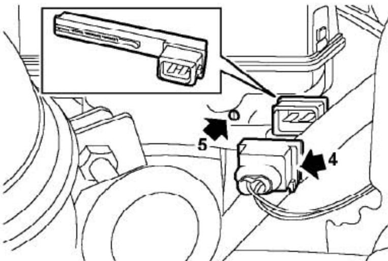
4). 从制动液液面开关上断开连接器的连接。
