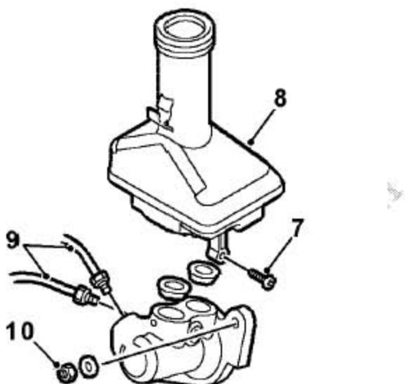
7). 拆下把制动储液罐固定到制动主缸上的沉头螺栓。
