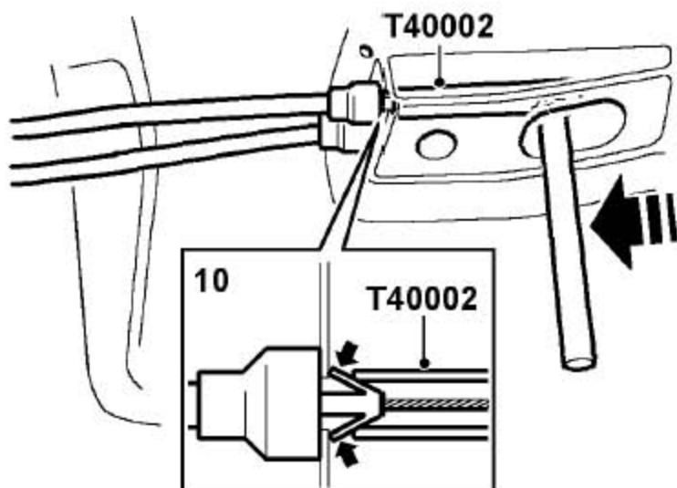
5). 用T40002压手制动后拉索卡扣，从地板上松开手制动后拉索总成。
