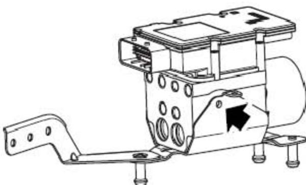
7). 拆下把DSC控制器模块固定到DSC调节器上支架上的3个螺栓。
