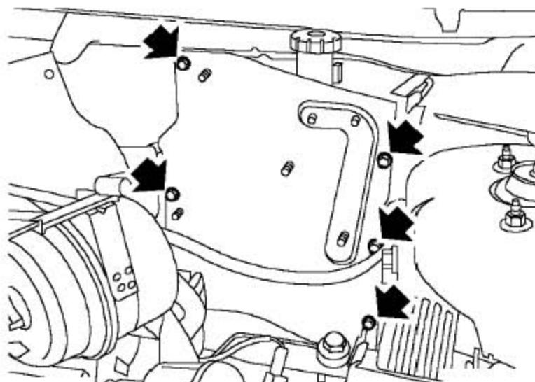
5). 拆下5个把驾驶员侧的辅助隔板固定到车身上的螺栓，取下辅助隔板。
