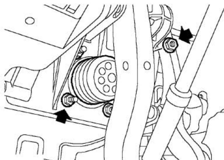
6). 拆下把真空助力器固定到车身上的4个螺母并取下真空助力器总成。
