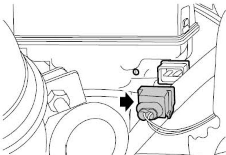
6). 从制动液液面开关上断开连接器的连接。
