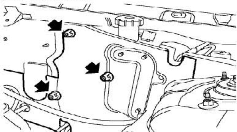
2). 拆下把隔音材料固定到驾驶员侧的3个卡扣，取下隔音材料。
