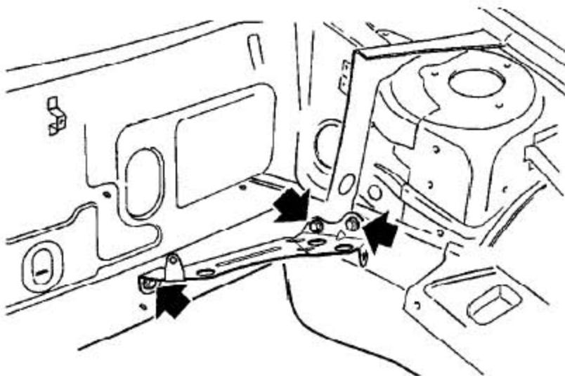
9). 拆下3个固定DSC调节器下安装支架到车身上的螺栓并取下DSC调节器下支架。
