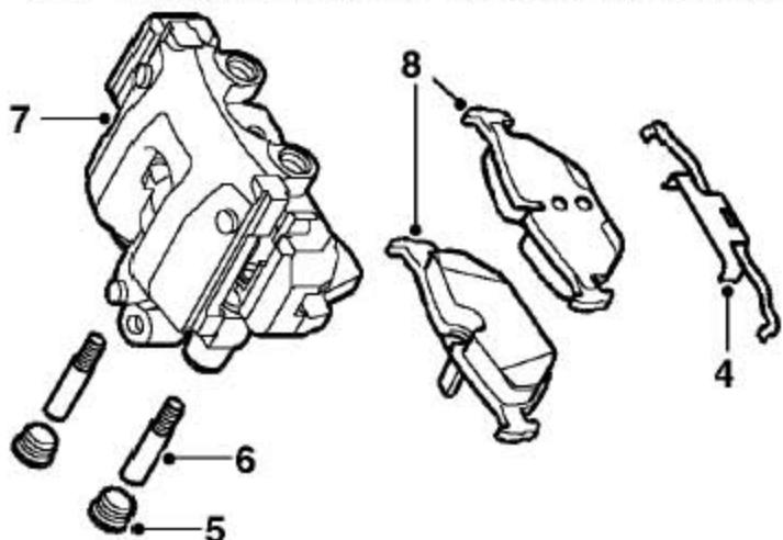
4). 从后制动钳壳体上拆下后制动钳止动弹簧。
