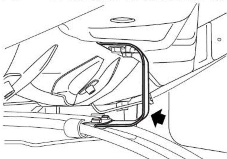
6). 从手制动后拉索向导支架上取下手制动后拉索。
