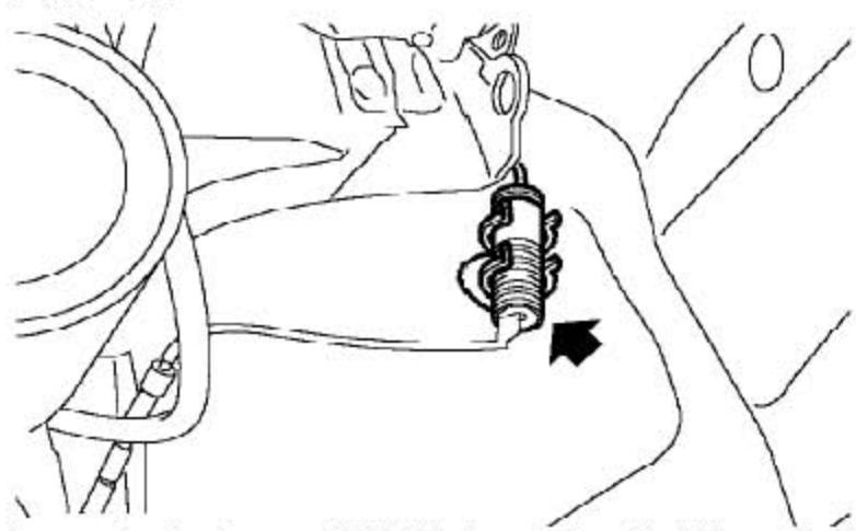
3). 只对右侧：断开后制动衬块磨损传感器的连接器。从排气螺钉帽、后轮ABS传感器导线上的夹子和后轮罩衬垫上松开后制动衬块磨损传感器导线。
