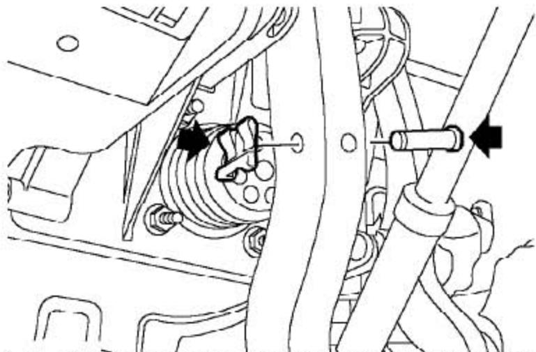
8). 拆下把制动真空助力器推杆固定到制动踏板上的簧片螺母和杆销。
