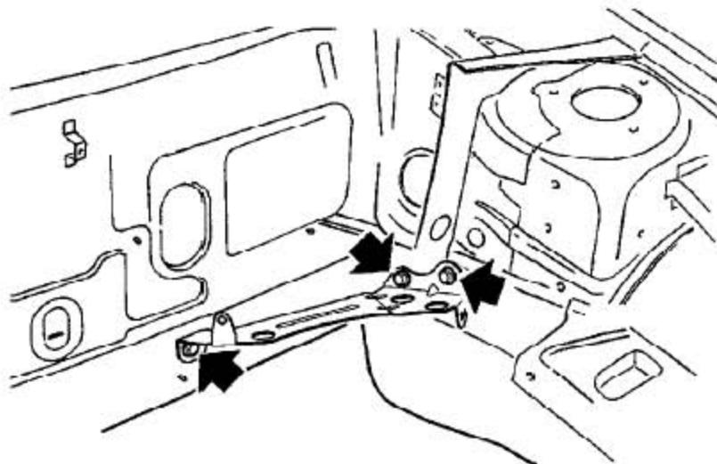
9). 拆下3个固定ABS调节器下安装支架到车身上的螺栓并取下ABS调节器下支架。
