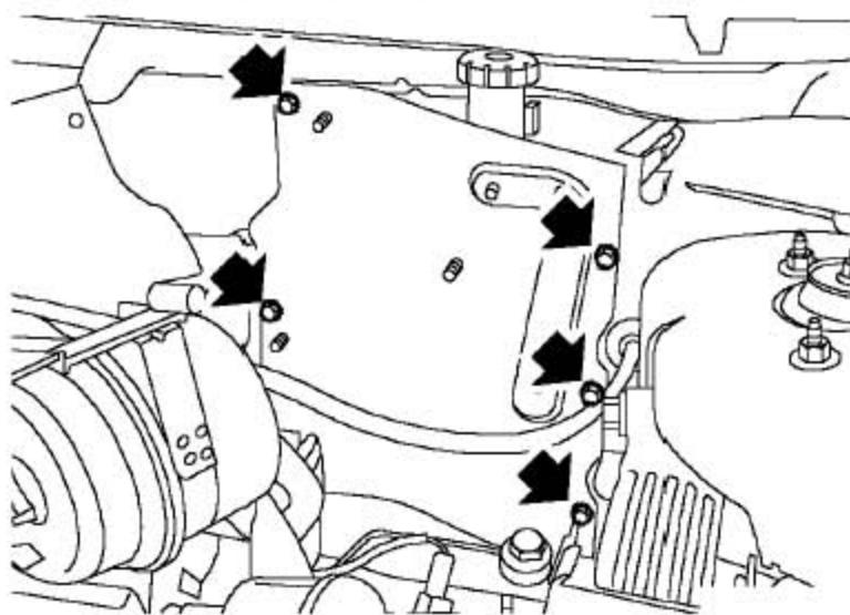
3). 拆下把驾驶员侧辅助隔板固定到车身上的5个螺栓，取下驾驶员侧辅助隔板。
