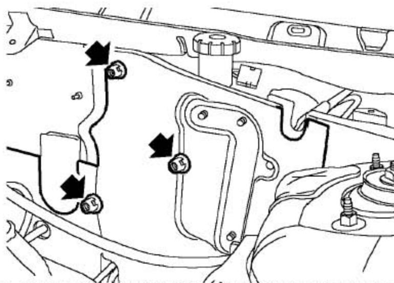
4). 拆下3个把隔音材料固定到驾驶员侧的辅助面板的螺母，取下隔音材料。
