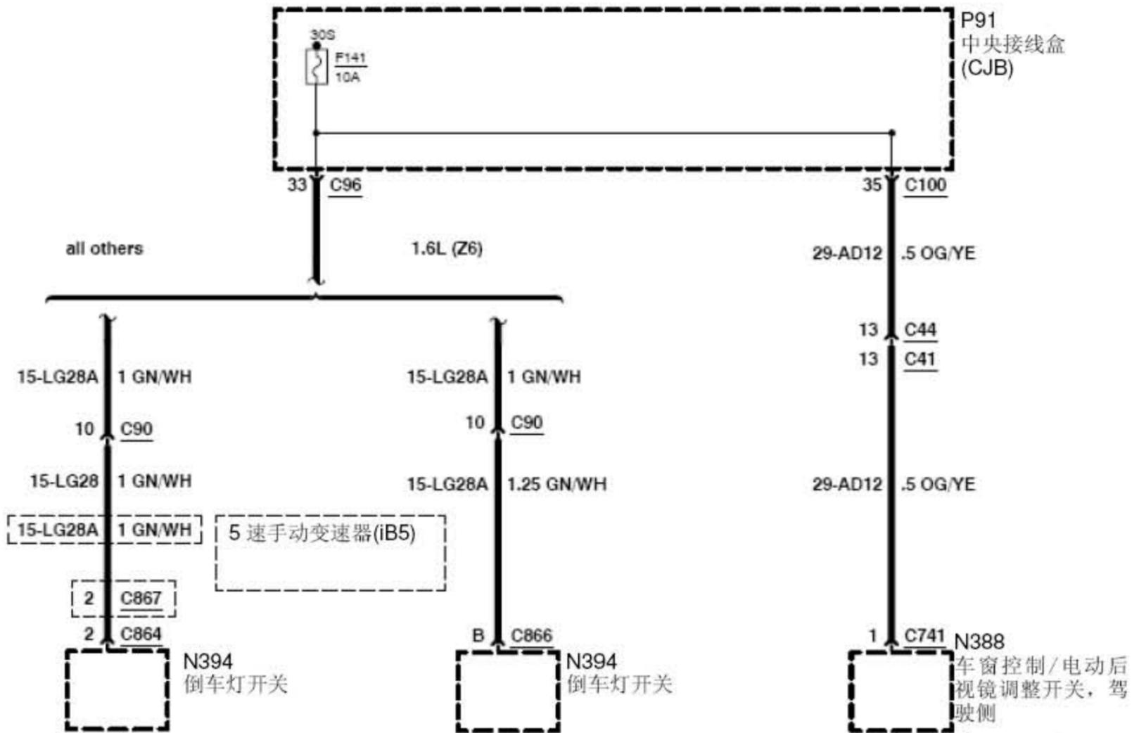
保险丝细节—F141, 自动变速器, 手动变速器 (MPS6)
