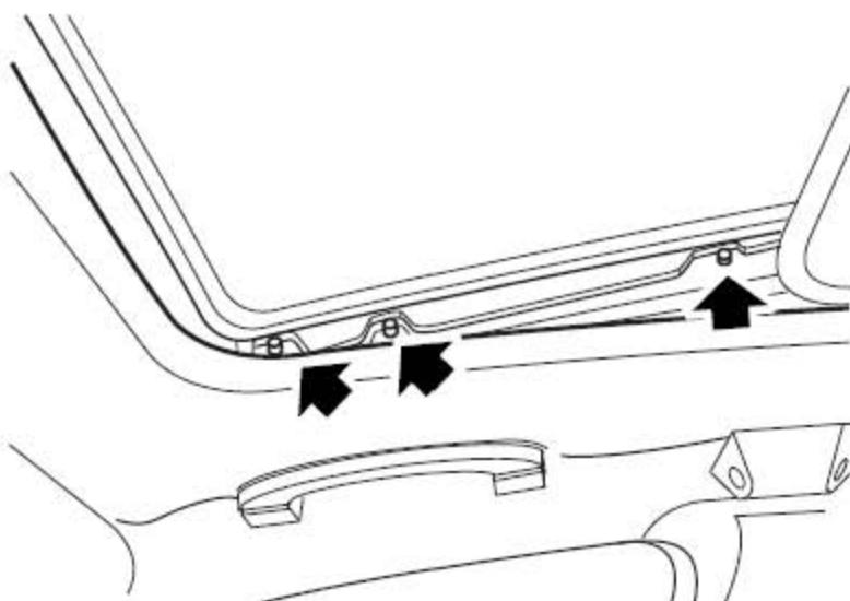
3). 拆下6个固定玻璃总成的螺钉。
