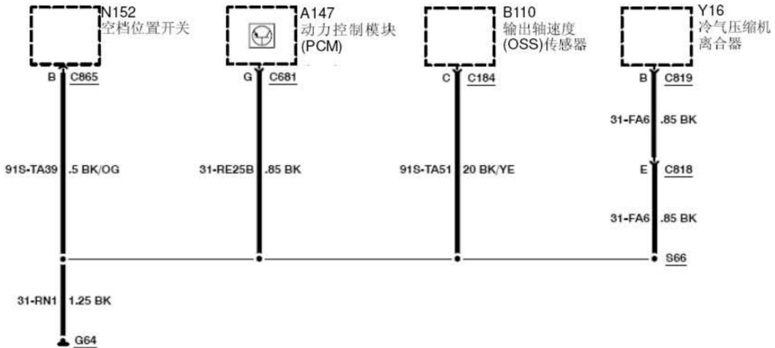
接地线—G64, 1.6L (Z6),自动变速器
