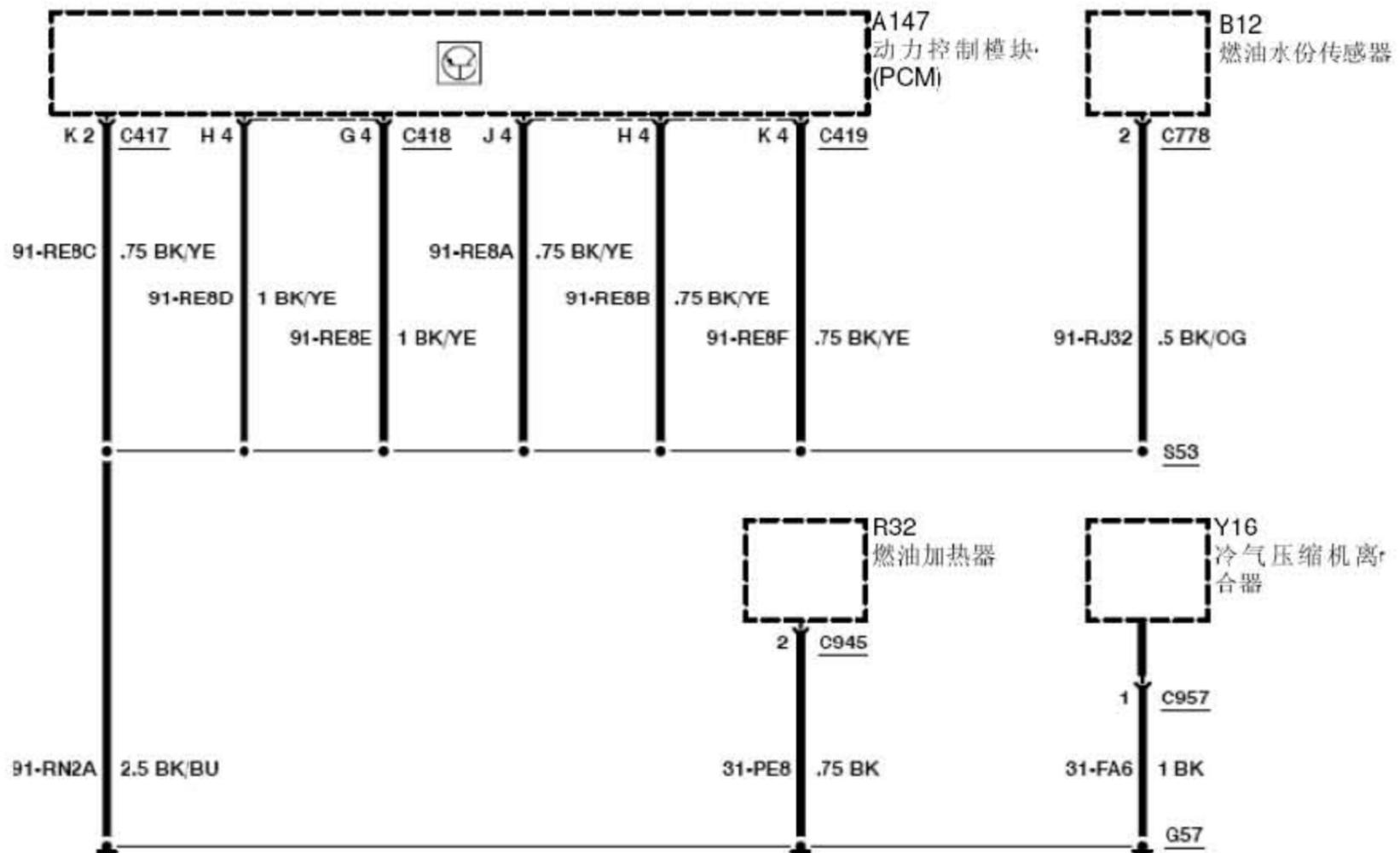
接地线—G57, 2.0L Duratorq-TDCi (DW)柴油, 手动变速器 (MPS6)
