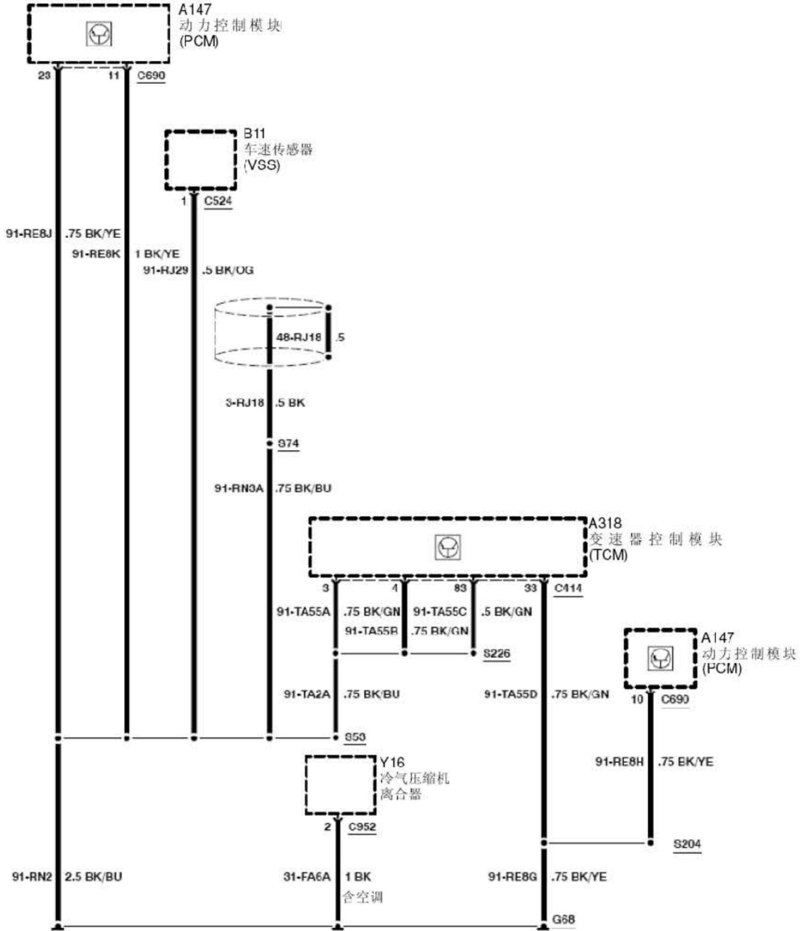
接地线—G68, 1.8/2.0L Duratec-HE (MI4), 2009年起车型, 手动变速器
