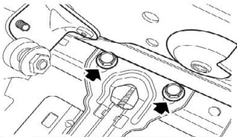
5). 松开2个固定电机支架到座椅滑动机构上的右侧螺栓。
