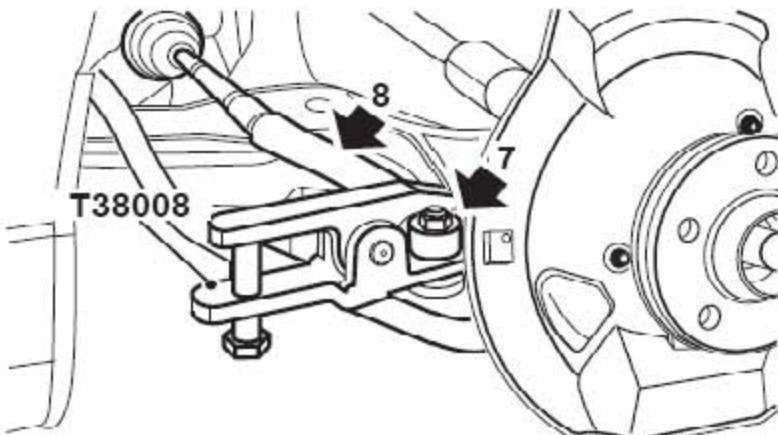
7). 从转向横拉杆端部拆下螺母，在转向横拉杆球节上装上一个M10螺母，与转向横拉杆球节端头平齐。
