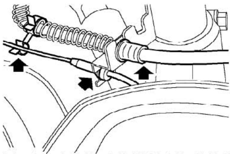
6). 拆下夹子，从前减振器柱的跨接支架上松开制动软管和ABS传感器线束。
