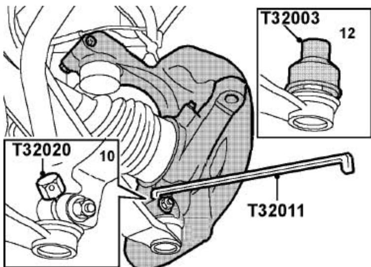
11). 拆下把前轮毂固定到前下摆臂上的螺母和螺栓。
