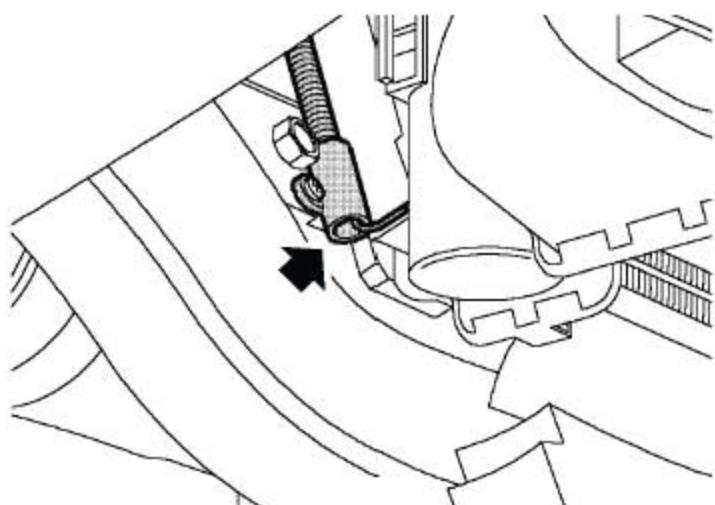
26). 断开空调压缩机连接器。
