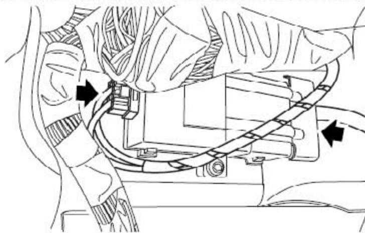
59). 从发动机防盗控制单元上断开连接器
