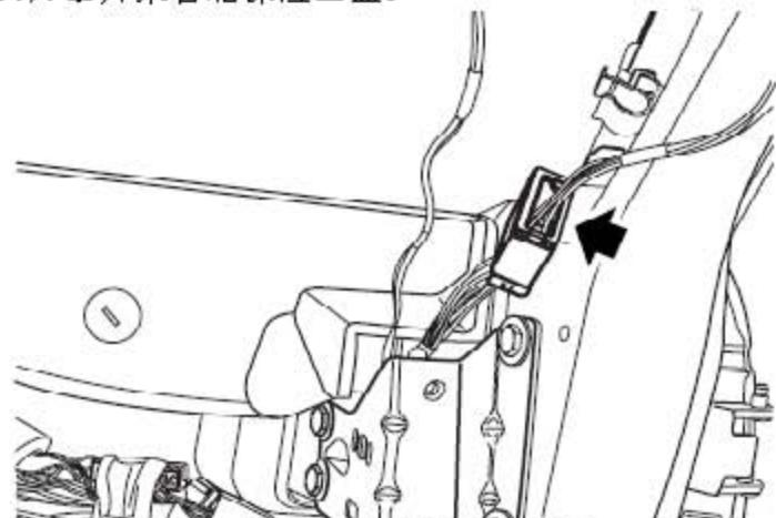
57). 断开连接主线束到车顶线束连接器。
