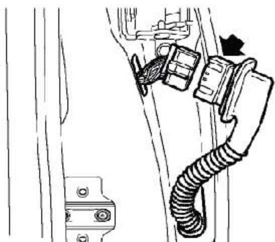
6). 从门和BC柱上松开线束套筒和连接器。
