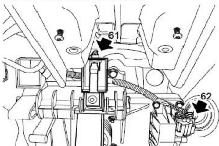
61). 从制动踏板后部断开制动灯开关连接器。
