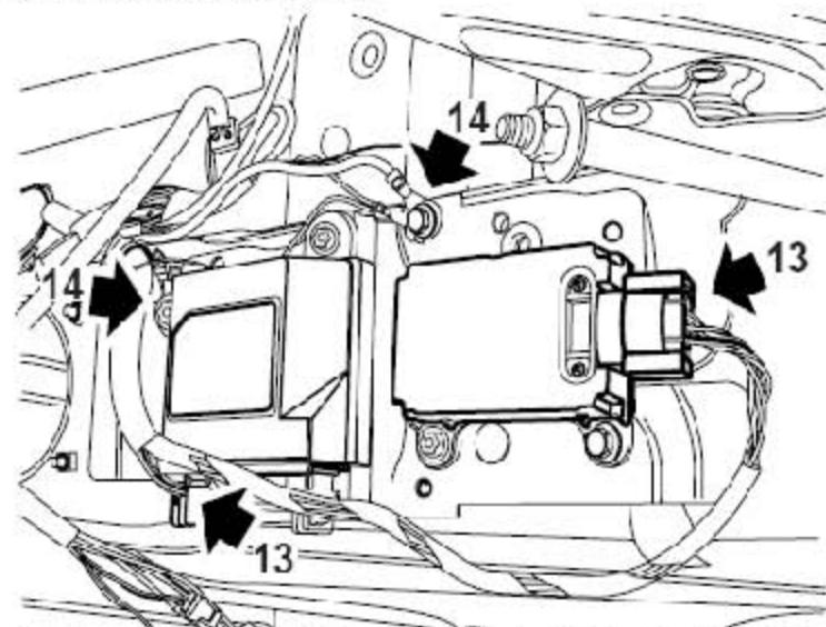
13). 从DCU上断开连接器，从偏航传感器上断开连接器。
