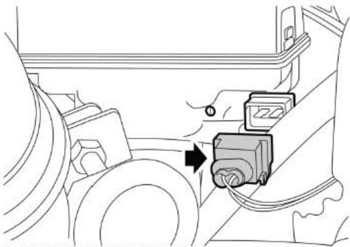
47). 断开制动液液面开关连接器。
