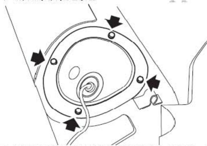
70). 拿开4个把燃油箱封闭板固定到车身上的螺栓，拿开燃油箱封闭板。
