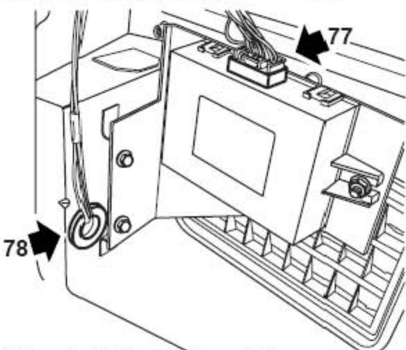
77). 从停车距离控制ECU上断开连接器。
