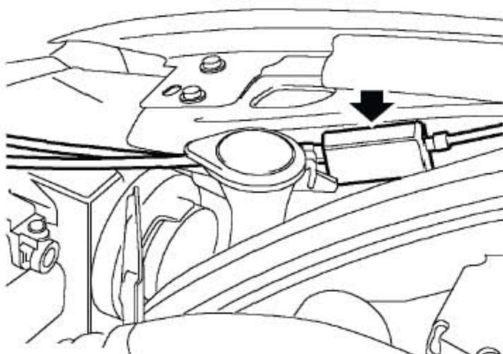
1). 从车身上拆下发动机罩开启连接块壳体。
