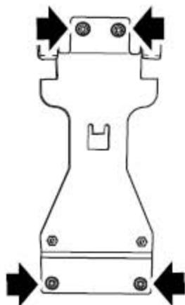
4). 拧开把三角警告牌金属支架总成固定到行李箱盖上的自攻螺钉，拿开三角警告牌金属支架总成。
