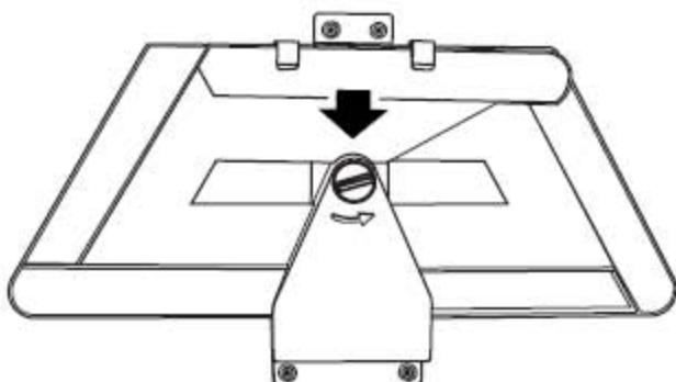
2). 旋转三角警告牌塑料支架上的旋转按钮，拿开三角警告牌。
