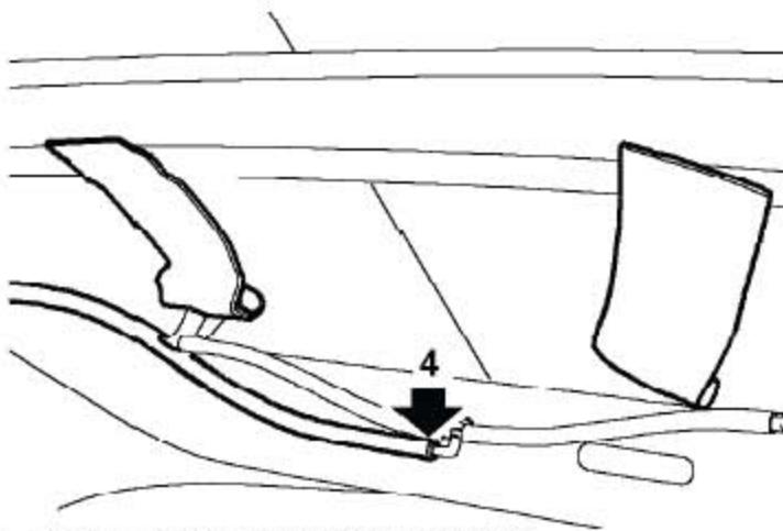
3). 从T形三通处断开洗涤软管的连接。
