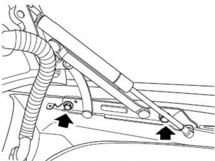
3). 拧开把铰链总成固定到车身上的螺栓，拿开行李箱盖铰链总成。
