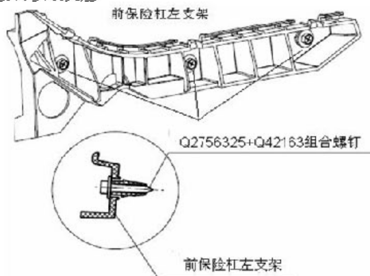
图 7-6 前保支架的拆卸
