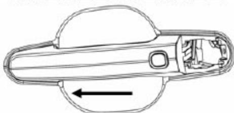
●注意：安装门把手时，将后侧卡在弹簧上，完后，先拉一下试试看看能不能回复原位。
