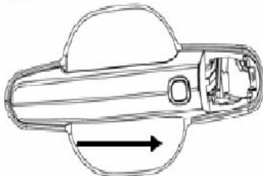
E). 拆下门把手，从门把手内取出车外探测天线总成
