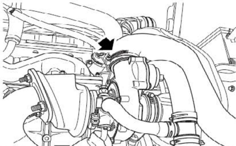
46). 松开把空气出气软管固定到涡轮增压器上的夹箍，并拿开软管。
