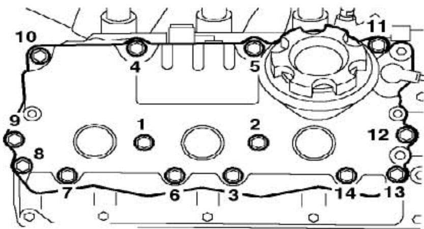
8). 把凸轮轴罩盖垫片装到缸盖上，装上凸轮轴盖，按图中所示的顺序拧紧螺栓到9Nm。
