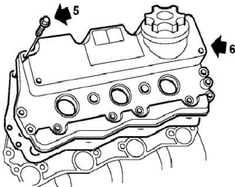
5). 逐渐松开固定凸轮轴罩盖的14 个螺栓并取下。
