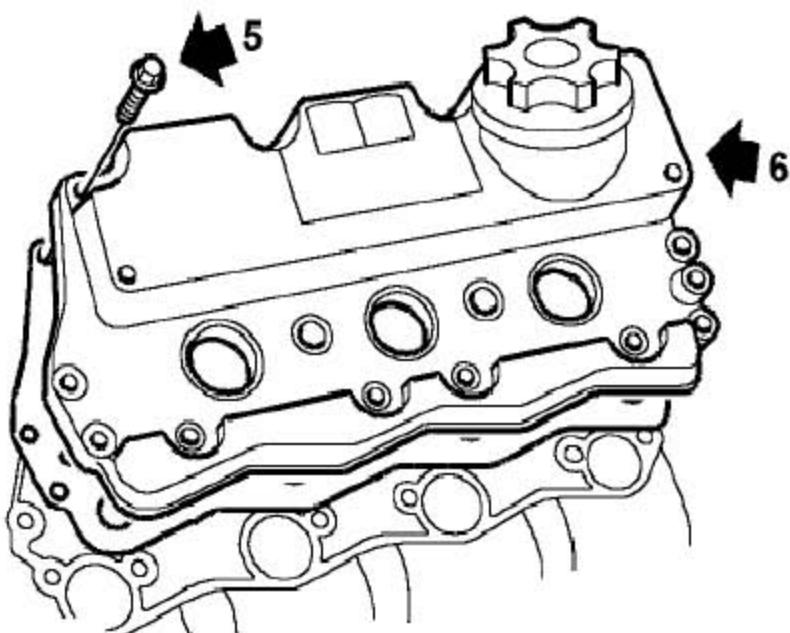
5). 逐渐松开固定凸轮轴罩盖的14 个螺栓并取下。
