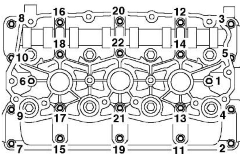
10). 按图示的顺序，渐次松开把凸轮轴支架固定到缸盖上的22个螺栓，直到气门弹簧压力不再作用到凸轮轴上，同时拿开螺栓。
