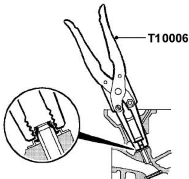
25). 用T10006 夹出气门杆油封，并废弃油封。
