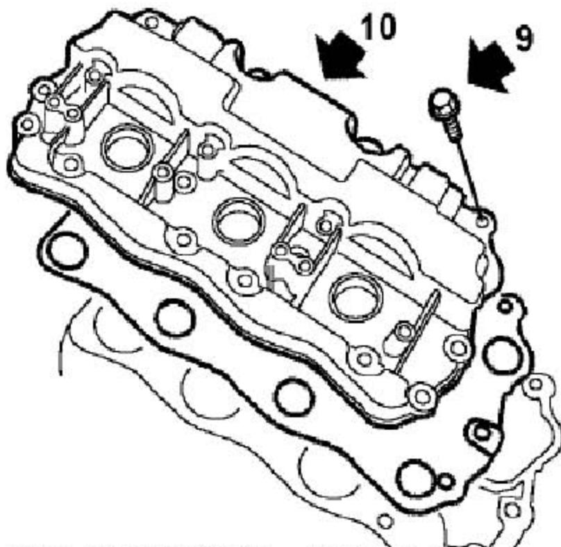
9). 逐次松开固定凸轮轴罩盖的14 个螺栓并拿开。
