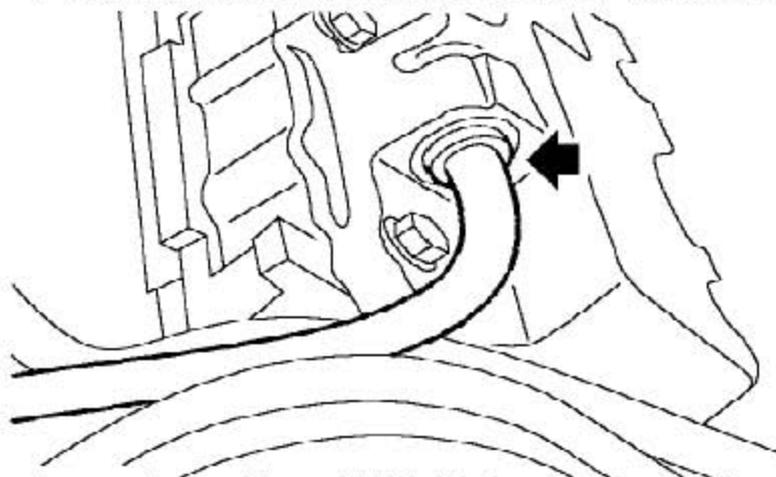
12). 压下边圈，并从凸轮轴罩盖上拿开发动机呼吸管。
