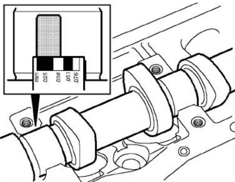
6). 用比对尺测量每个轴颈上的塑料测隙丝的最宽的部位。检查凸轮轴轴承的间隙。如果间隙超差，装上新的凸轮轴并重新检查。如果仍超差，就更换掉缸盖。
