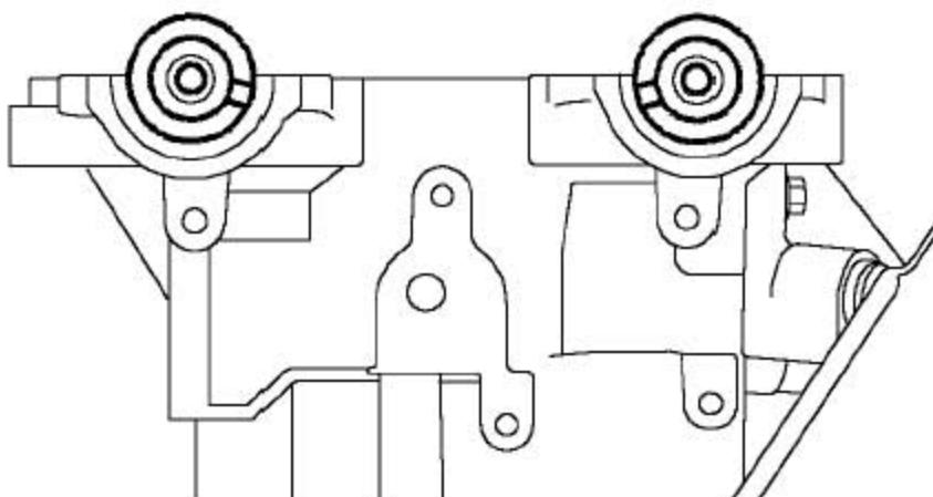
3). 把凸轮轴固定到缸盖内，注意使每个凸轮轴的后正时齿轮驱动切槽按图中所示放置。
