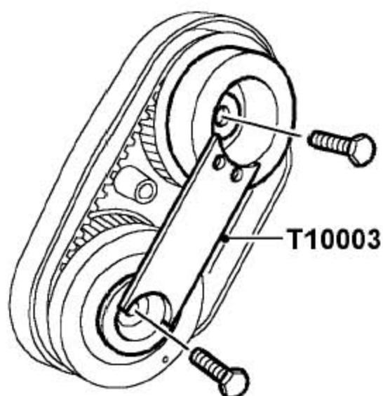
2). 如图所示，把T10003固定到后凸轮轴齿轮上，拧下把齿轮固定到凸轮轴上的螺栓并废弃。
