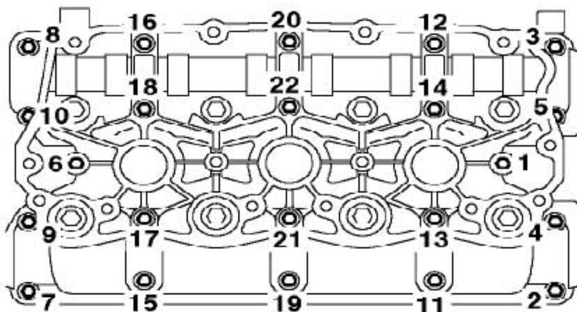
11). 按图所示的顺序，渐次松开把凸轮轴支架固定到缸盖上的22个螺栓，直到气门弹簧压力不再作用到凸轮轴上，同时拿开螺栓。
