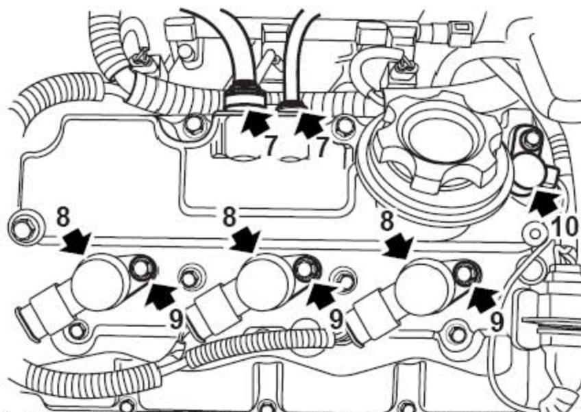
7). 压锁止边圈以从凸轮轴左盖上松开2个发动机呼吸管。
