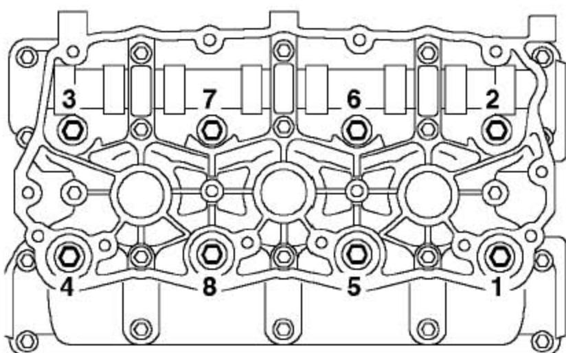
20). 依照图示的顺序，渐次拧下8个缸盖螺栓。
