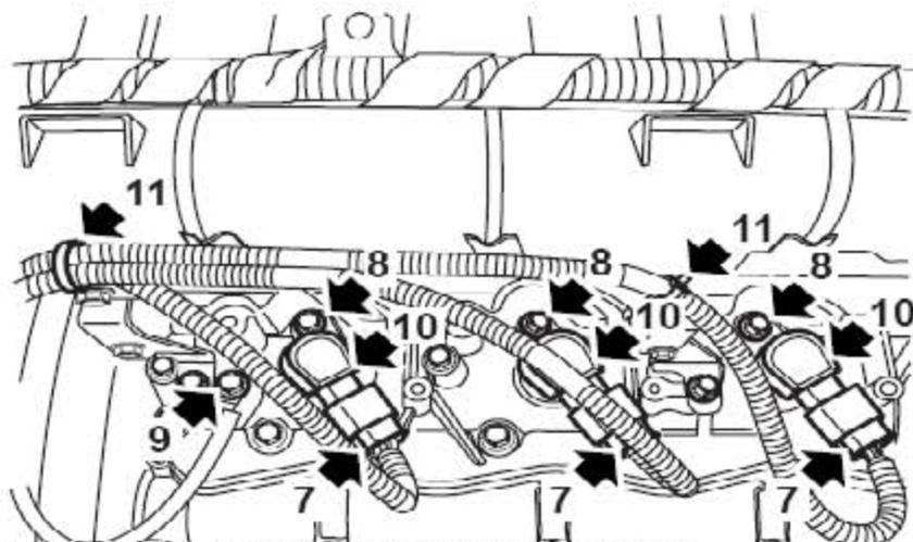
7). 松开3个锁止夹并拔出点火线圈的3个连接器。
