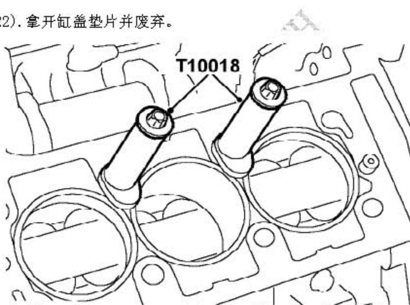
23). 放上平缸夹T10018，用缸盖螺栓固定。确保夹子的底部不会突出到缸套的内径。
