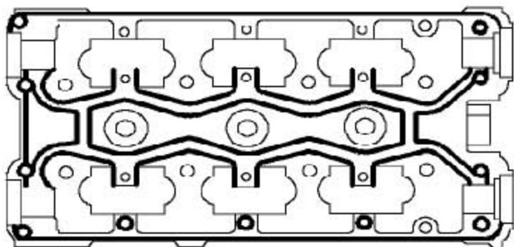
12). 在如图所示的凸轮轴支架路径上，用滚轮把密封剂涂成均匀的薄膜，密封剂部件号：FLM90017A。
