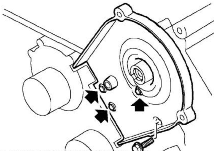
5). 拧开4个固定凸轮轴正时皮带底盖的螺栓。
