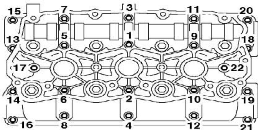
5). 装上凸轮轴支架, 按图示顺序渐次加力的把螺栓拧紧到10Nm。
