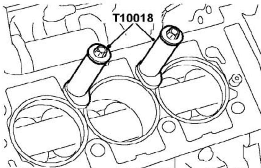
23). 放上平缸夹T10018，用缸盖螺栓固定。确保夹子的底部不会突出到缸套的内径。
