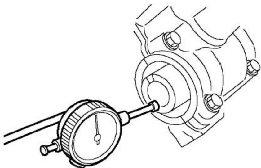
9). 用DTI 千分表检查凸轮轴的轴向间隙。凸轮轴的轴向间隙: = 0.08至0.21mm。
