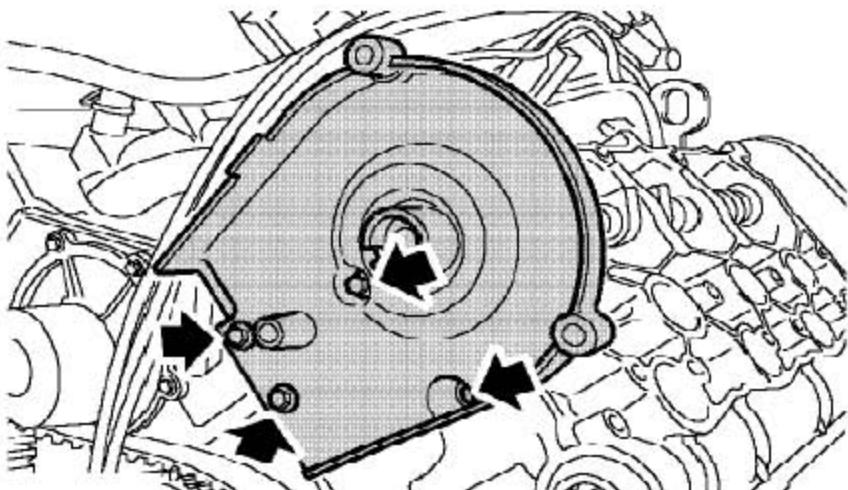
9). 拧开4个螺栓，从缸盖上取下前凸轮轴正时皮带盖的背板。
