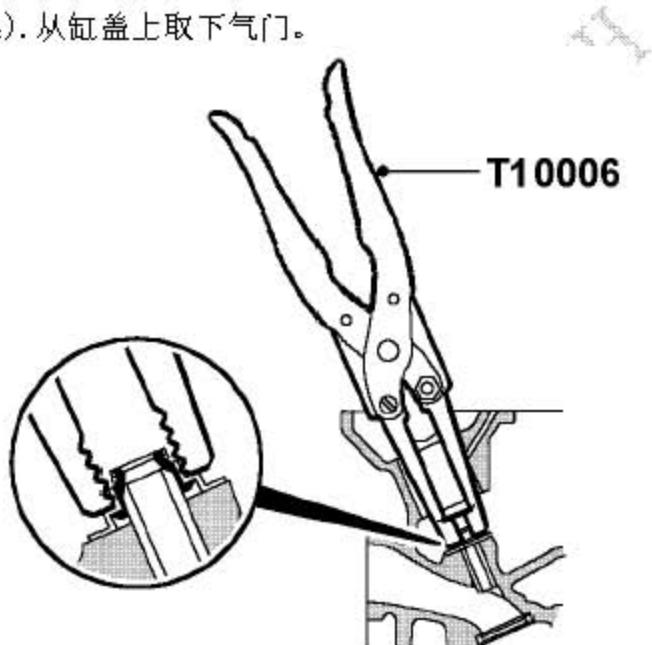
25). 用T10006 夹出气门杆油封，并废弃油封。
