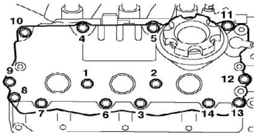
8). 把凸轮轴罩盖垫片装到缸盖上, 装上凸轮轴盖, 按图中所示的顺序拧紧螺栓到9Nm。
