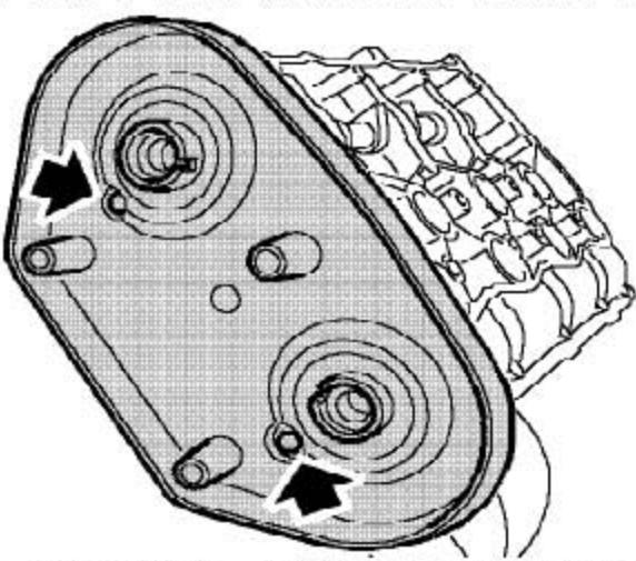
6). 拧开2个螺栓，从缸盖上取下后凸轮轴正时带盖的背板。
