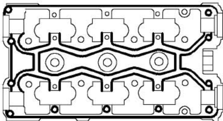
4). 在如图所示的凸轮轴支架路径上，用滚轮把密封剂涂成均匀的薄膜，密封剂部件号为：FLM 90017A。
