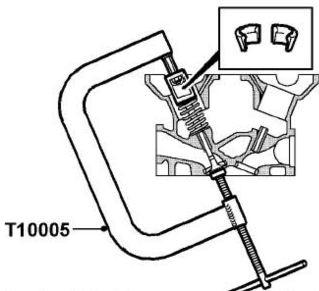
22). 用气门弹簧压缩器T10005 压缩气门弹簧，拿开2个气门锁夹，松开气门弹簧，并拿开T10005。
