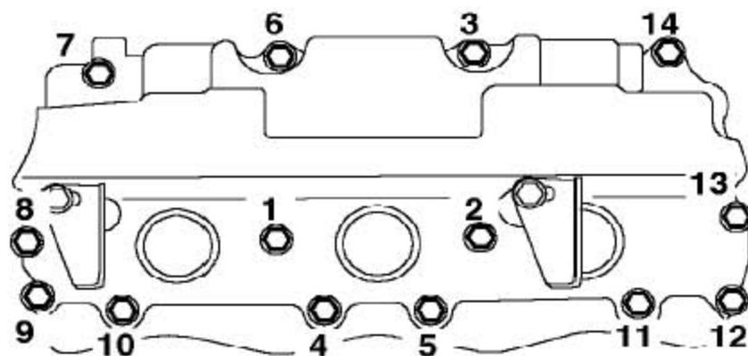
8). 把凸轮轴盖垫片装到缸盖上，装上凸轮轴罩盖，按图中所示的顺序拧紧螺栓到9Nm。
