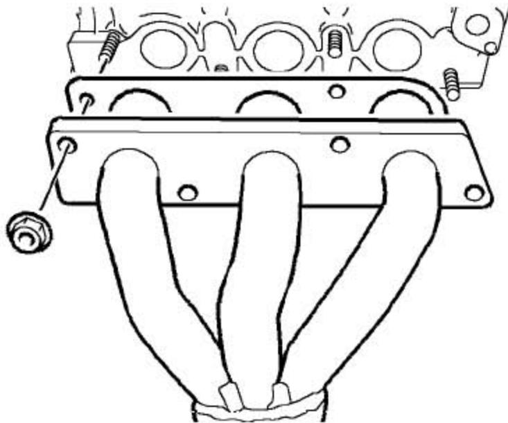
5). 渐次松开4个把排气歧管固定到缸盖上的螺母，拿开排气歧管并废弃掉垫片。
