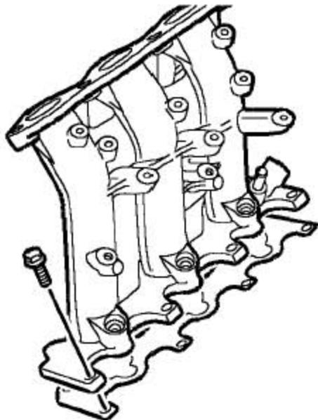
6). 渐次松开7个把进气歧管固定到缸盖上的螺栓。
