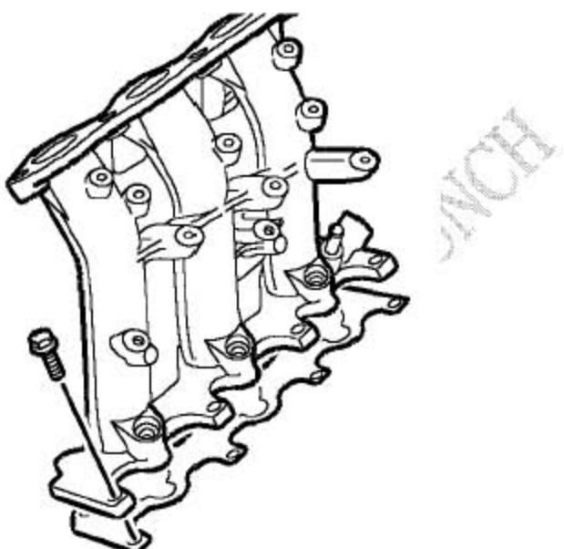
6). 慢慢松开7个把进气歧管固定到缸盖上的螺栓。
