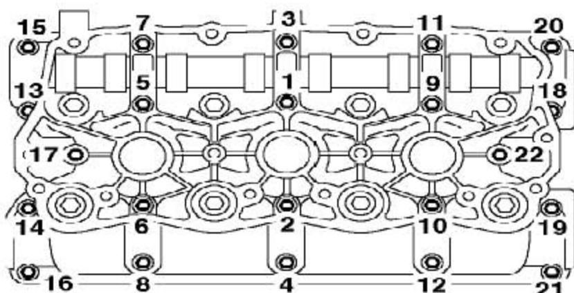
5). 装上凸轮轴支架，按图示顺序渐次加力的把螺栓拧紧到10Nm。
