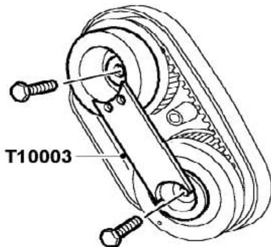
26). 把凸轮轴齿轮螺栓拧紧至27Nm, 然后再拧90°。从凸轮轴齿轮上拿开T10003。
