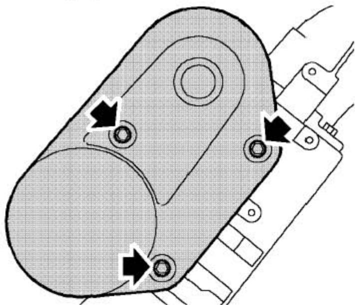
1). 拧开固定凸轮轴后正时带盖的3个螺栓并取下盖子。
