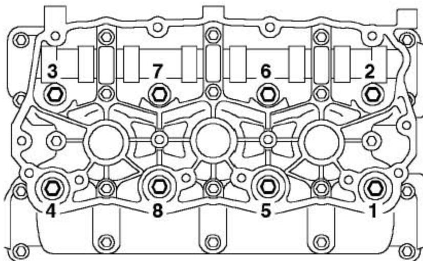
20). 依照图示的顺序，渐次拧下8个缸盖螺栓。
