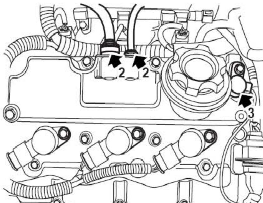
2). 压锁止边圈从凸轮轴左盖上松开2个发动机呼吸管。
