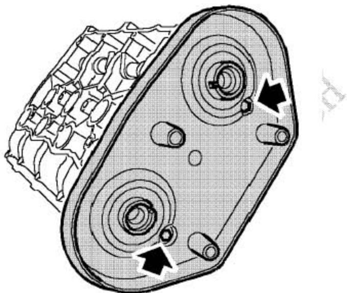
8). 拧下把左后凸轮轴正时皮带盖背板固定到缸盖上的2个螺栓，并拿开背板。
