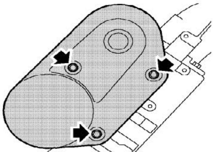
28). 装上凸轮轴后驱动皮带盖并拧紧螺栓至9Nm。
