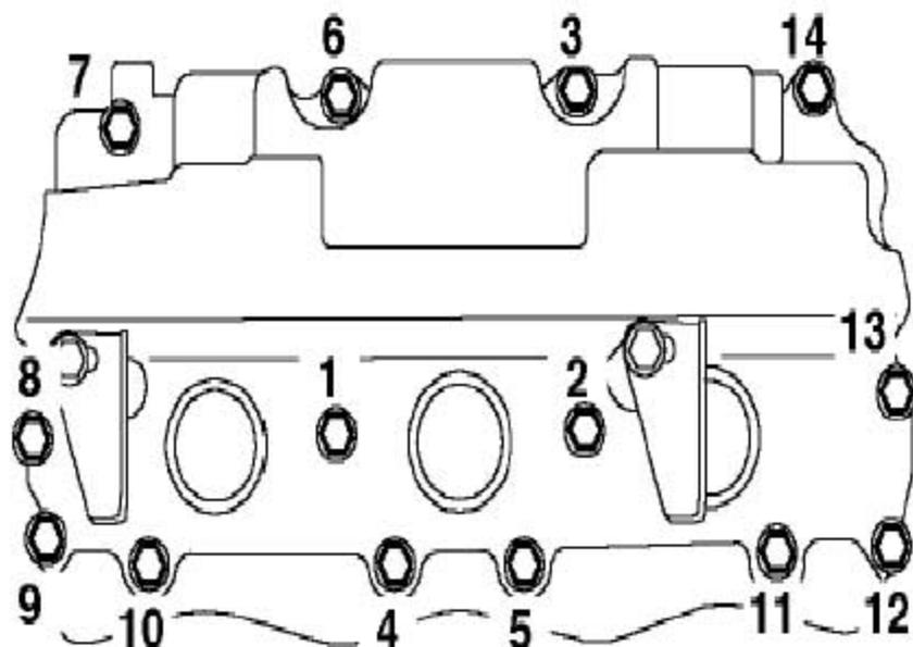
4). 装上螺栓，按图中所示的顺序依次把螺栓拧紧至9Nm。
