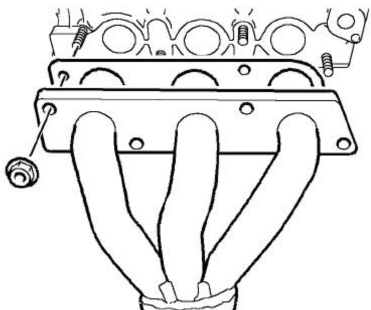
5). 慢慢松开4个把排气歧管固定到缸盖上的螺母，拿开排气歧管并废弃掉垫片。
