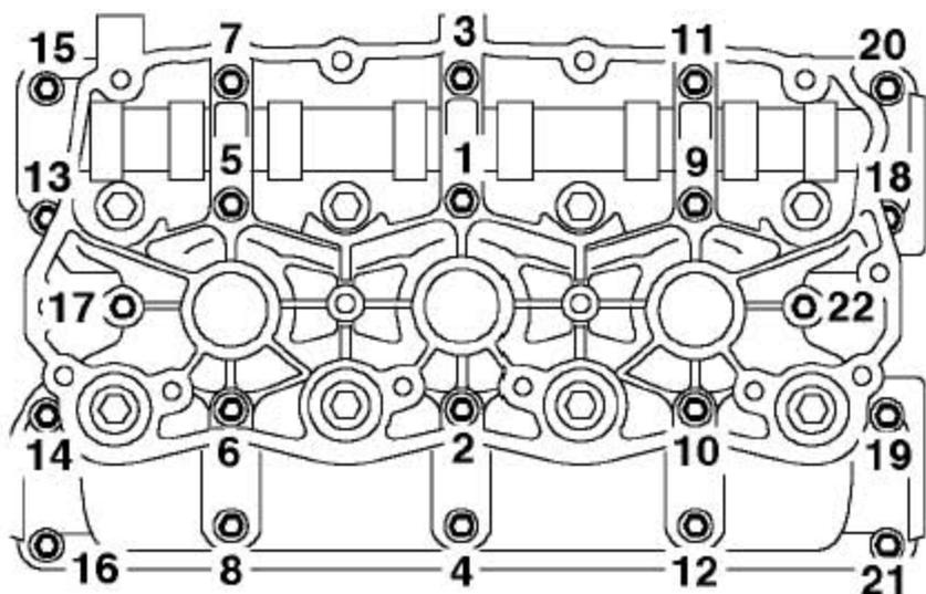
18). 装上凸轮轴支架，按顺序把螺栓拧紧到10Nm。不要转动凸轮轴。
