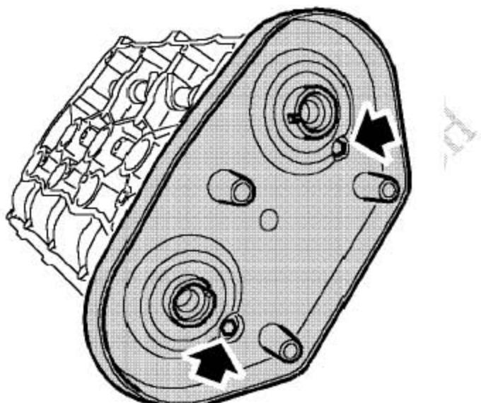
8). 拧下把左后凸轮轴正时皮带盖背板固定到缸盖上的2个螺栓，并拿开背板。
