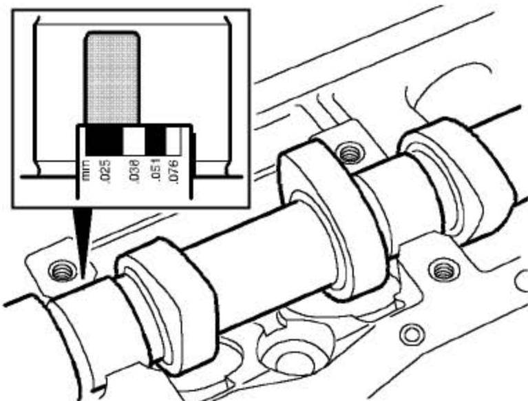
19). 拿开凸轮轴支架，用比对尺在每个轴颈上测量塑料测隙丝的最宽的地方。检查凸轮轴轴承的间隙。
