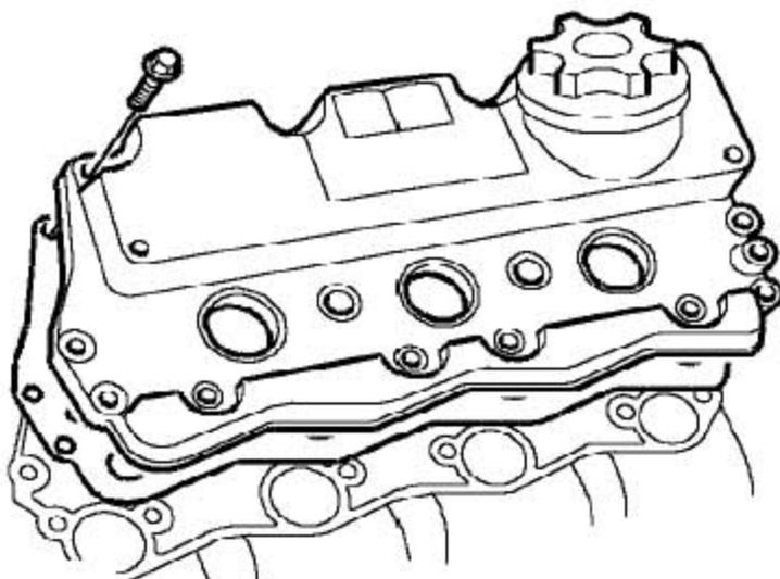
15). 逐渐松开固定凸轮轴罩盖的14个螺栓并拿开。
