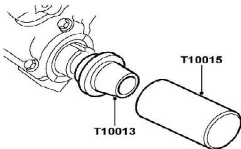
6). 注意前油封为黑色，后油封为红色，用工具T10015和T10013装上新的凸轮轴油封。
