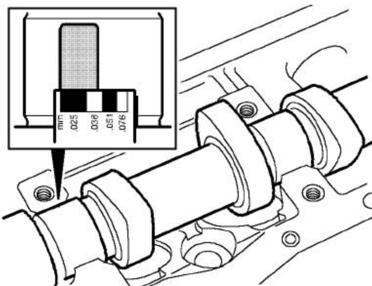
19). 拿开凸轮轴支架，用比对尺在每个轴颈上测量塑料测隙丝的最宽的地方。检查凸轮轴轴承的间隙。
