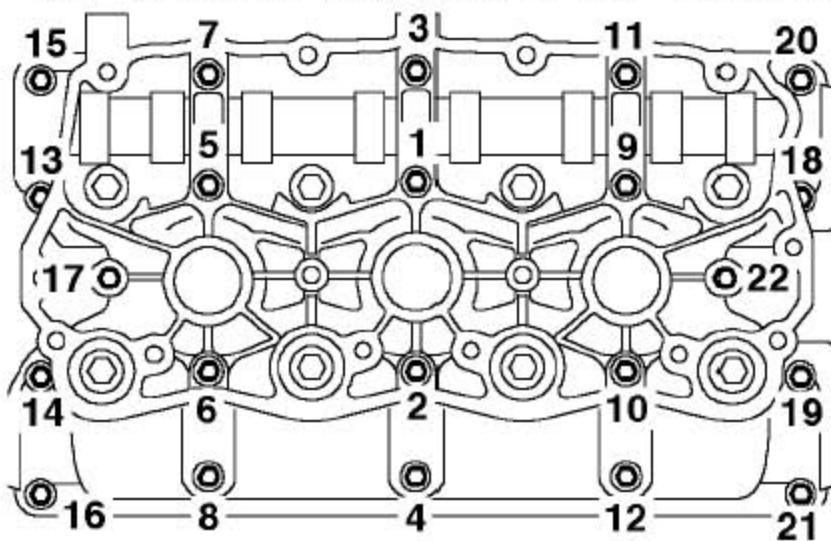
5). 装上凸轮轴支架，按图示顺序渐次加力的把螺栓拧紧到10Nm。
