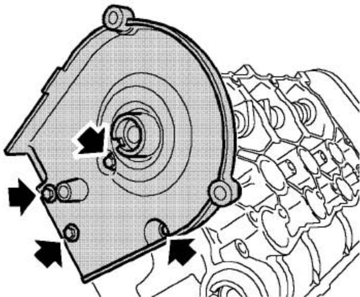
7). 拧下4个把前凸轮轴正时皮带盖背板固定到缸盖上的螺栓，并拿开背板。
