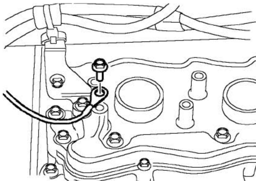
7). 拧下把接地导线固定到右凸轮轴罩盖上的螺栓，并断开接地导线。
