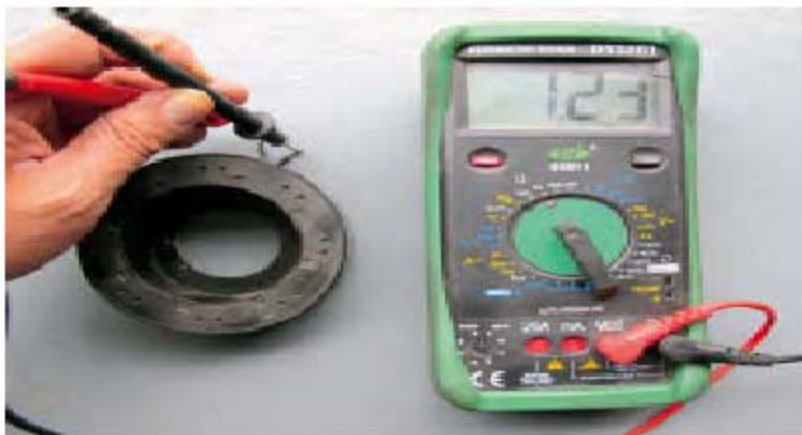
图5 测量故障离合器线圈
