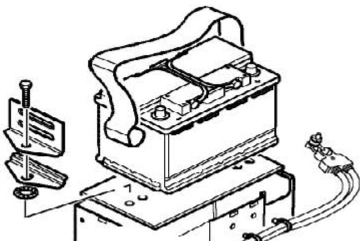
2). 拿开固定蓄电池夹的螺栓，拿开蓄电池固定夹。
