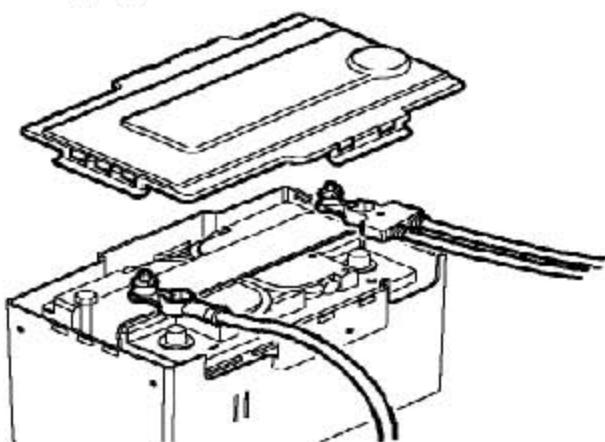
1). 断开两个蓄电池电极，先断开负极。
