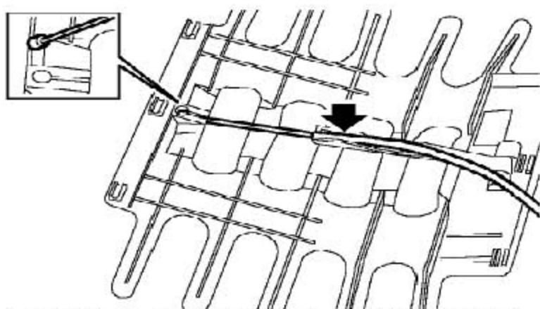
6). 从机构上松开腰托外拉索，断开腰托内拉索的连接。
