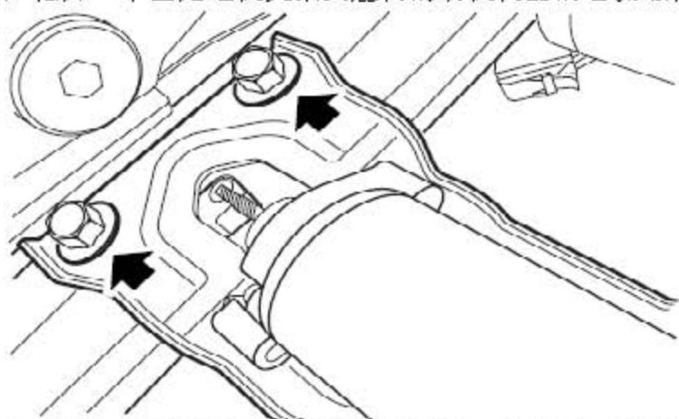
6). 松开2个固定电机支架的左侧螺栓，拿开电机和支架。
