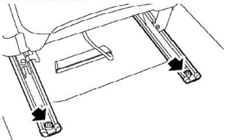
5). 拿开2个把座椅后面固定到车身上的螺栓，废弃掉螺栓。
