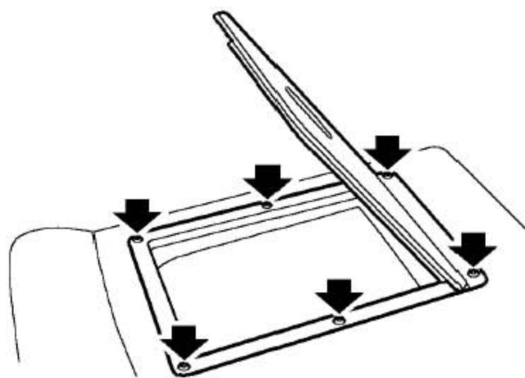
6). 钻出6个固定中间扶手后盖板的螺钉，拿开后盖板。
