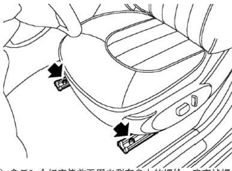
3). 拿开2个把座椅前面固定到车身上的螺栓，废弃掉螺栓。
