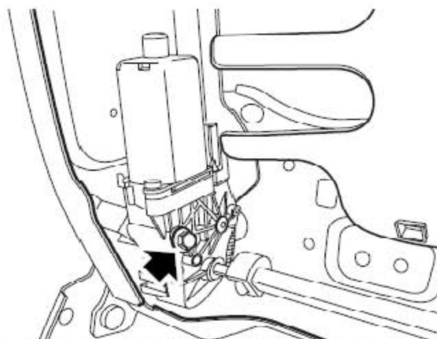
6). 松开把电机固定到靠背骨架上的螺栓，拿开电机。
