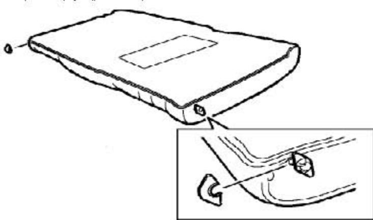
4). 拆下2个靠背上的支撑轴套。
