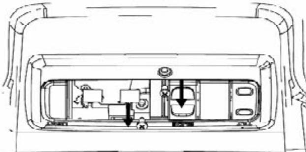
C). 拆下天窗控制器总成
